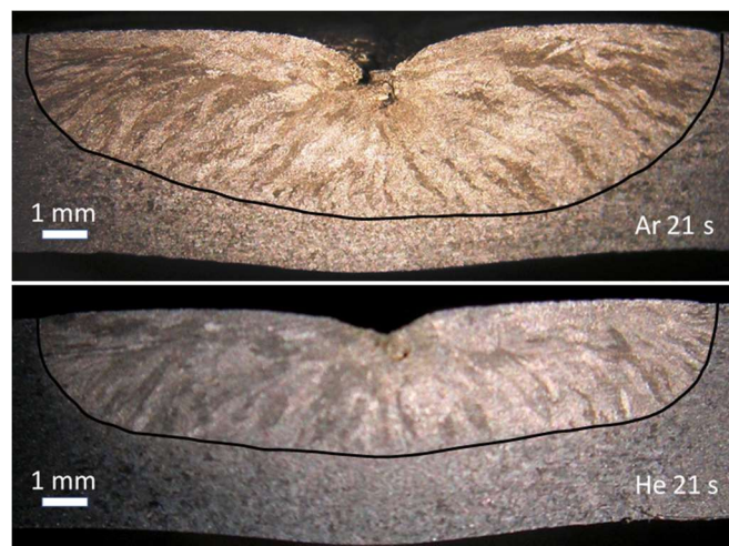
Slika 5.19 Zone taljenja nastale pod zaštitom korijenske strane zavara Ar i He
