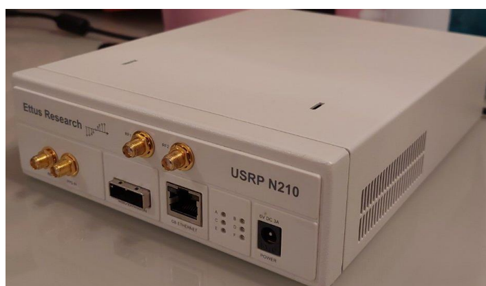
Slika 5.2. Uređaj USRP N210 korišten u eksperimentalnom radu
