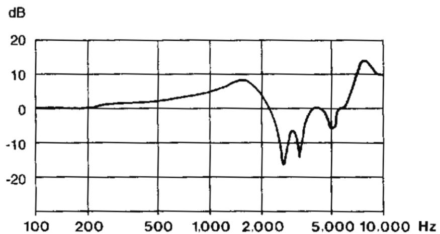
slika 1.2: Amplitudno frekvencijska karakteristika pojačanja zvuka dlanom iza uha [5]
