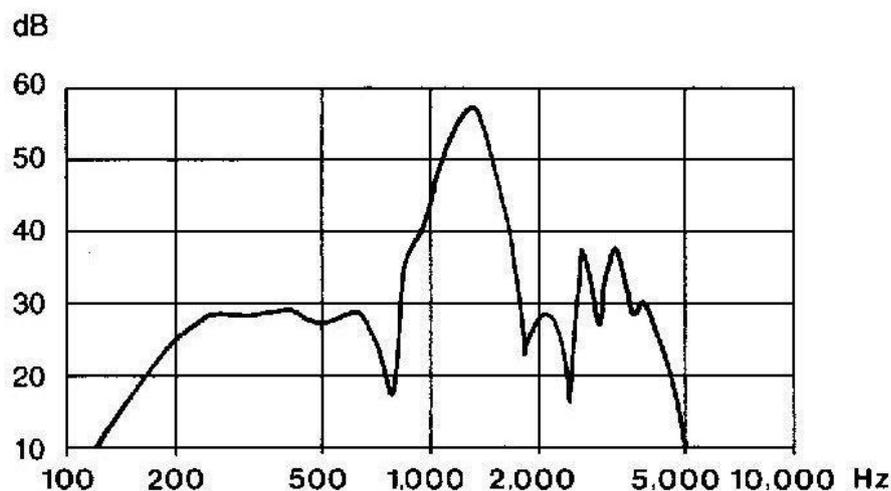
slika 1.4: Amplitudno frekvencijska karakteristika slušnog pomagala ušne trube [5]
