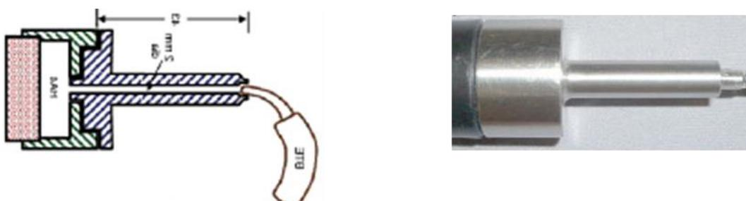
Slika 1.8. Spojnik zapremine  $2 \text{ cm}^3$  [5]
