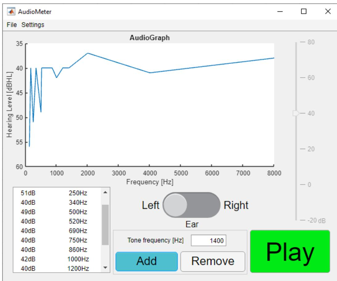
Slika 3.1: Sučelje računalnog programa za tonsku audiometriju veće razlučivosti
