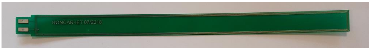
Slika 3.15 Mjerni svitak izrađen u PCB tehnologiji
