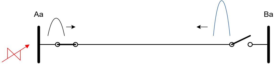
Slika 3.3 Propagacija testnog signala vodom u praznom hodu
