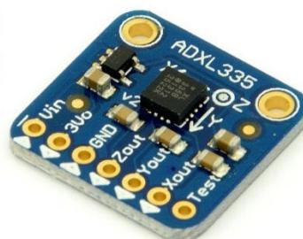
Slika 6.6: Akcelerometar ADXL335 koji je u mjeranjima korišten kao kontrolni detektor za vibracije
