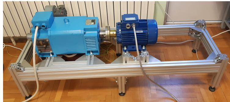
Slika 3.18: Postolje sa asinkronim strojem i istosmjernim motorom.
