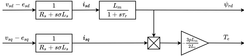
Slika 4.2: Asinkroni stroj modeliran PT1 prijenosnim funkcijama.
