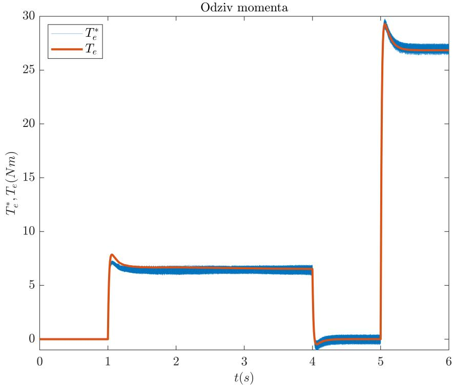
Slika 4.20: Referentna i generirana vrijednost elektromagnetskog momenta.
