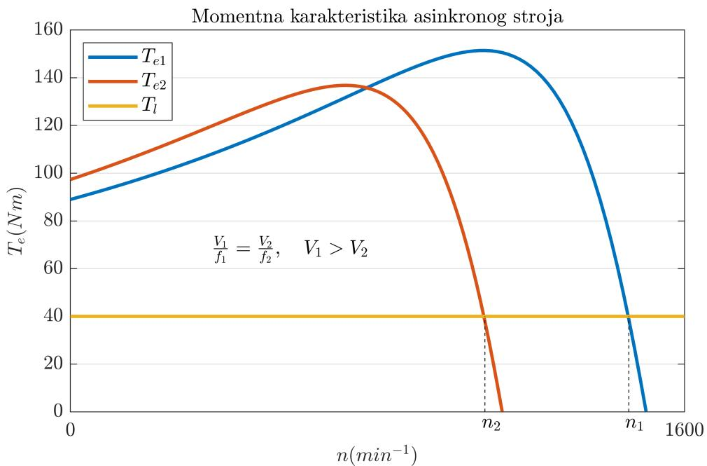
**Slika 3.20:** Momentna karakteristika asinkronog stroja.
