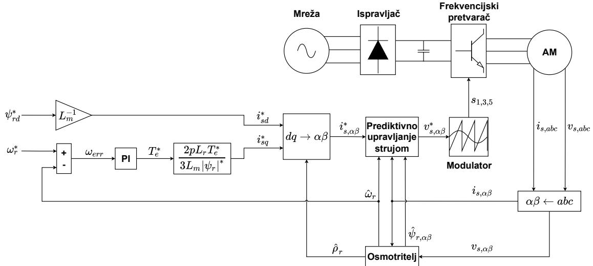
Slika 4.12: Dijagram kontinuiranog prediktivnog upravljanja asinkronog stroja.
