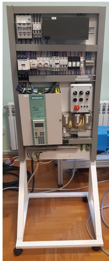
**Slika 3.19:** Pretvarač Siemens Simoreg za upravljanje momentom istosmjernog motora.
