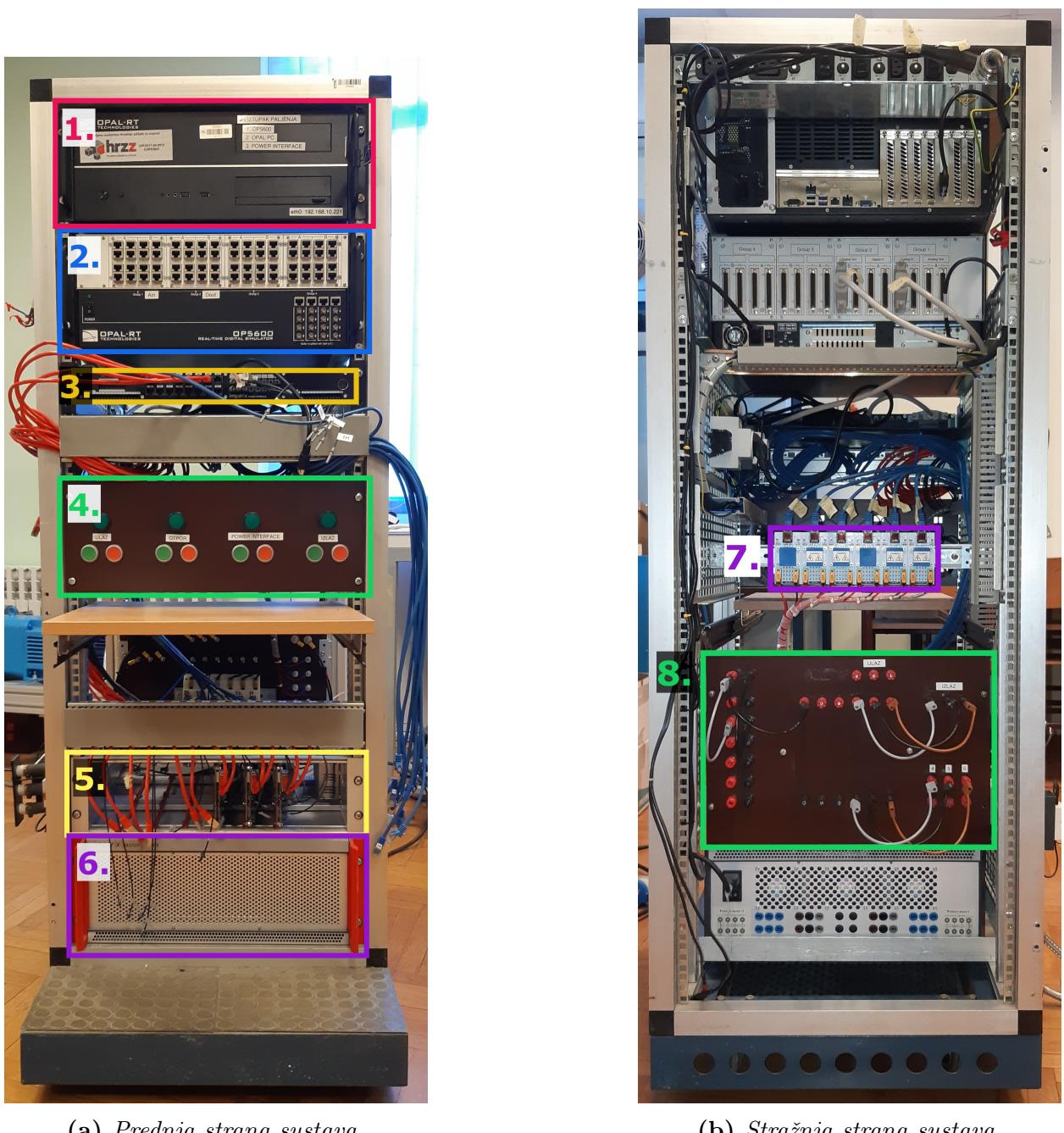
**Slika 3.14:** Prednja i stražnja strana sustava za razvoj i validaciju upravljačkih algoritama asinkronog stroja.
