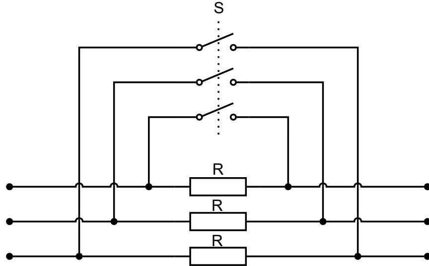
Slika 3.7: Principijelna shema sklopa za punjenje istosmjernog međukruga.
