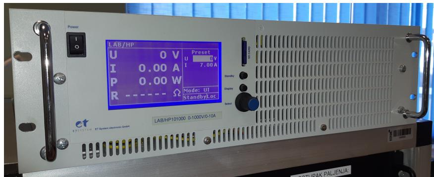
**Slika 3.6:** Laboratorijski izvor za napajanje energetskog pretvarača.
