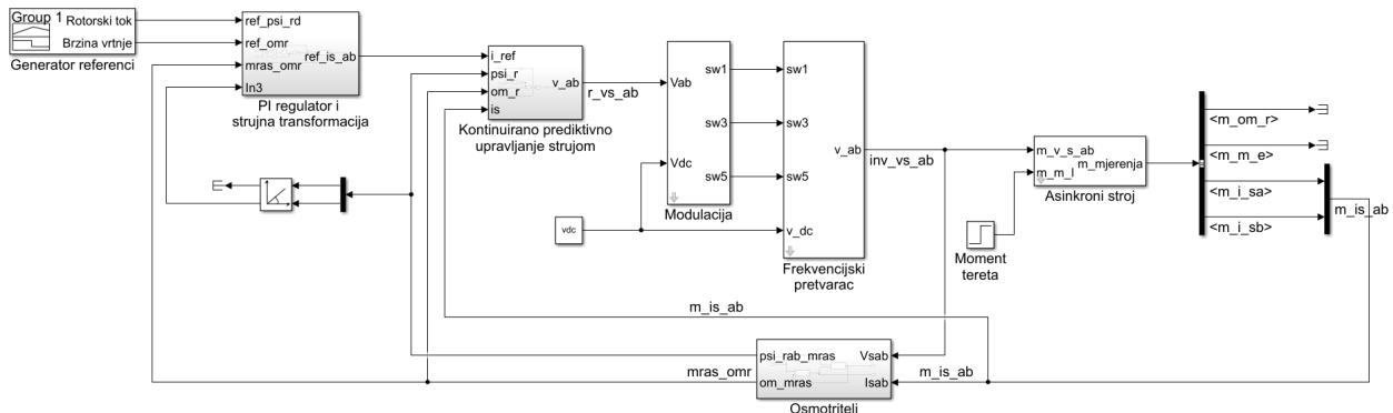
**Slika 4.15:** Implementacija kontinuiranog prediktivnog upravljanja strujom u Simulinku.
