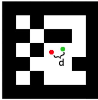
Slika 2.8: Udaljenost  $d$  između centra markera (crvena točka) i točke lasera (zelena točka)
