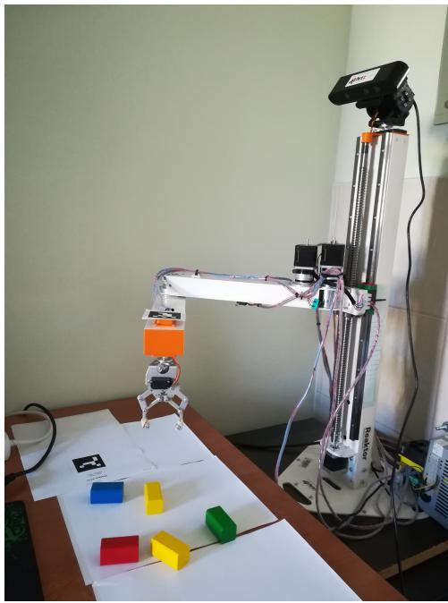
Slika 2.6: VICRA - robotska ruka u SCARA konfiguraciji
