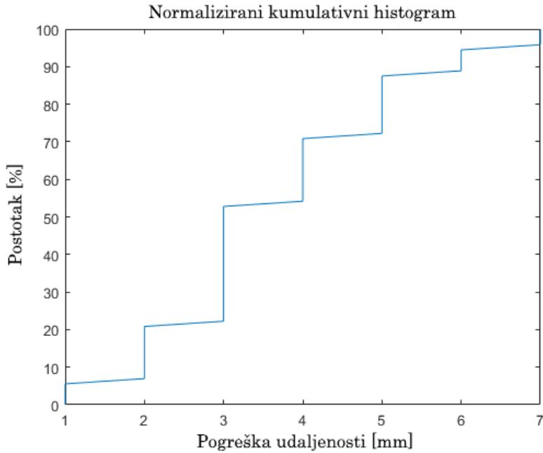
Slika 2.9: Normalizirani kumulativni histogram pogreške pozicioniranja alata
