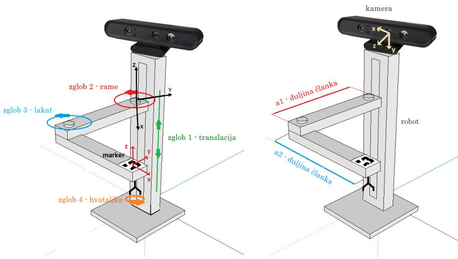
Slika 2.7: Vizualno navođen robotski sustav u SCARA konfiguraciji
