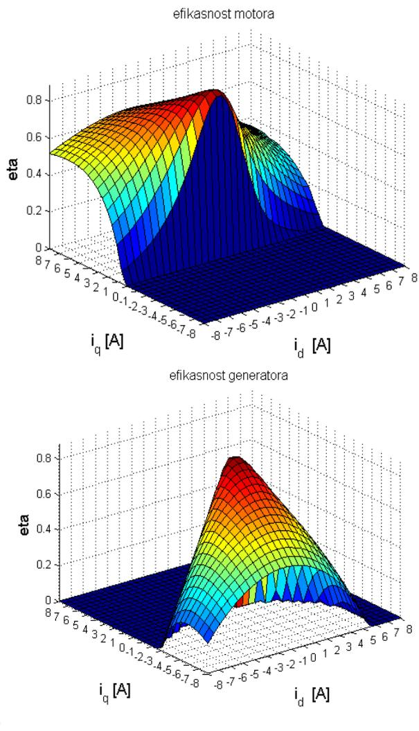
Slika 5.17. Grafički prikaz učinkovitosti testnoga motora za struje od -8A do 8A i frekvenciju 100Hz
