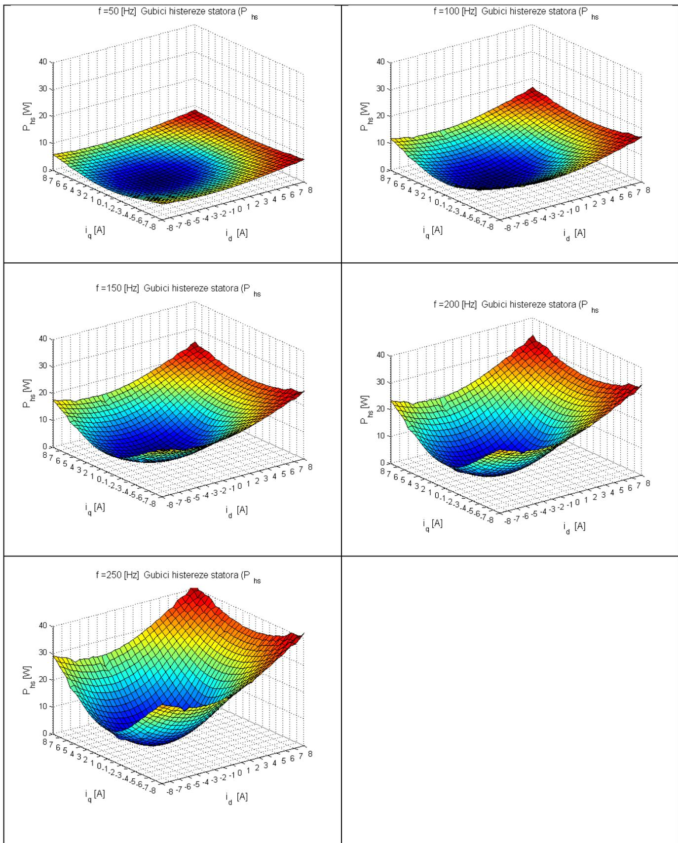
Slika C3: Gubitci histereze statora pri frekvenciji 50, 100, 150, 200 i 250 Hz
