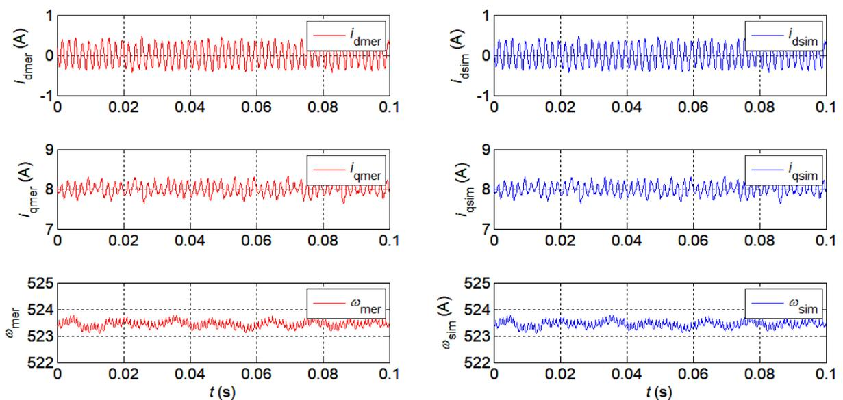
Slika 6.14. Usporedba mjerenih i simulacijskih rezultata pri vrtnji rotora 525 min<sup>-1</sup> i ulazne vrijednosti struja u d-osi ( $i_d=0A$ ) i q-osi ( $i_q=8A$ ), te narinute brzine vrtnje za simulacijski izračun jednake su vrijednostima pri mjerenju
