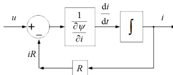
Slika 3.6. Blok dijagram za računanje struje iz izraza (3-6).
