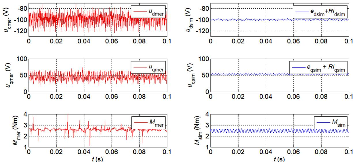
Slika 6.15. Usporedba mjerenih i simulacijskih rezultata napona u dq-osima i momenta motora pri vrtnji rotora  $525 \text{ min}^{-1}$  i ulazne vrijednosti struja u d-osi ( $i_d=0\text{A}$ ) i q-osi ( $i_q=8\text{A}$ )
