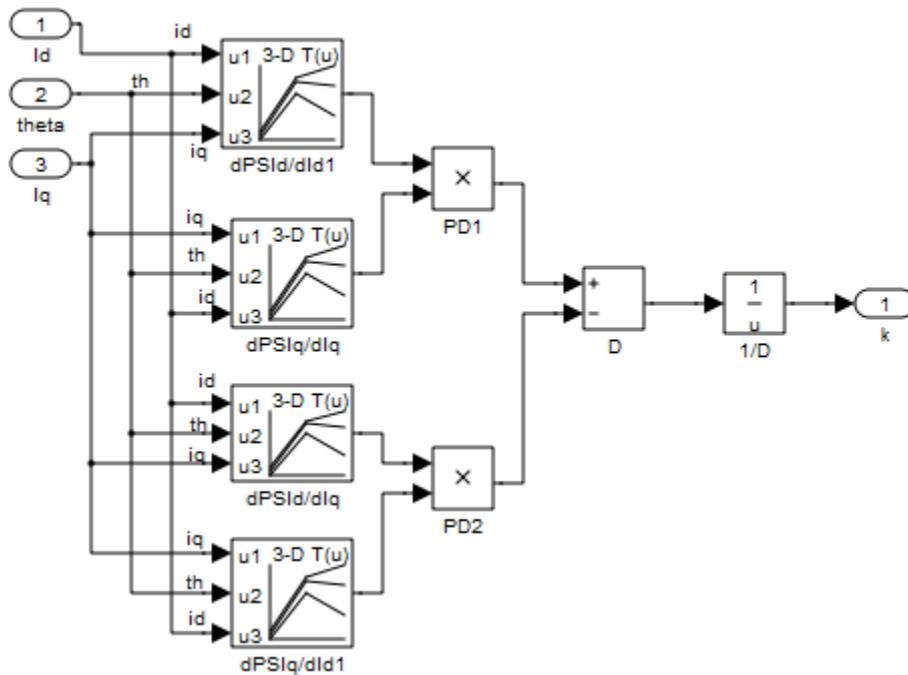
Slika 5.21. Prikaz podsustava za izračun parametra „k“ prema (5-6).
