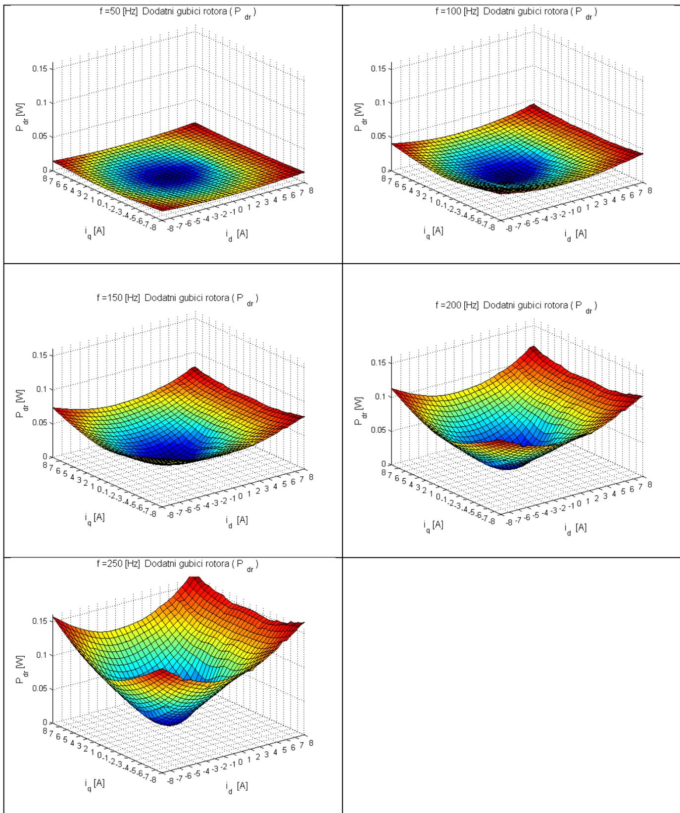
Slika C4: Dodatni gubitci rotora pri frekvenciji 50, 100, 150, 200 i 250 Hz
