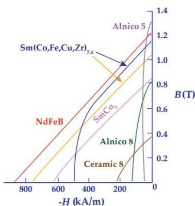
Slika 2.7. Krivulja demagnetiziranja za neke permanentne magnete [5]
