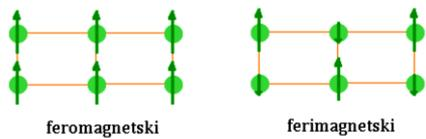
Slika 2.5. Prikaz položaja elementarnim magnetskih dipola u feromagnetskom i ferimagnetskom materijalu. [3]
