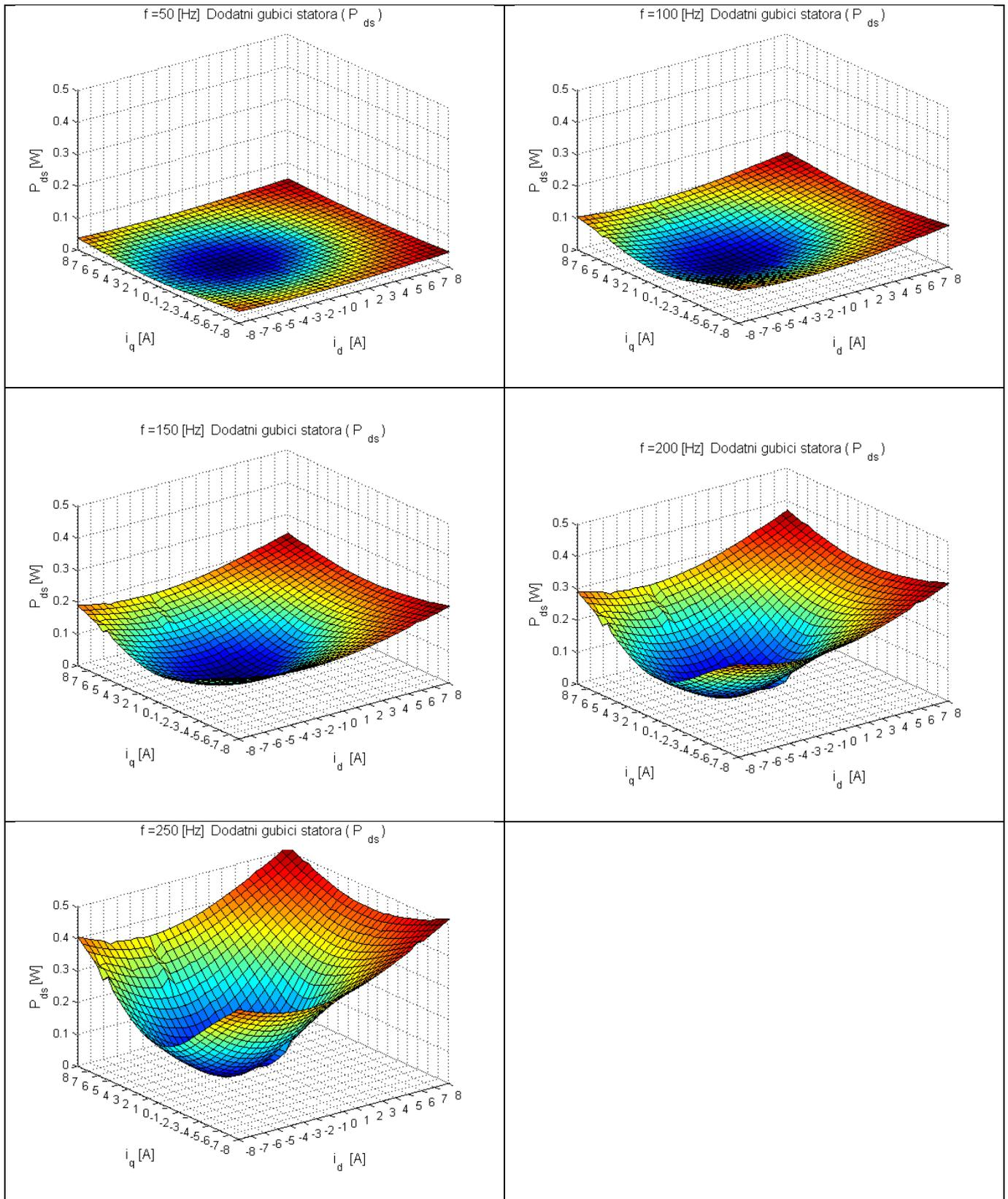
Slika C1: Dodatni gubitci statora pri frekvenciji 50, 100, 150, 200 i 250 Hz
