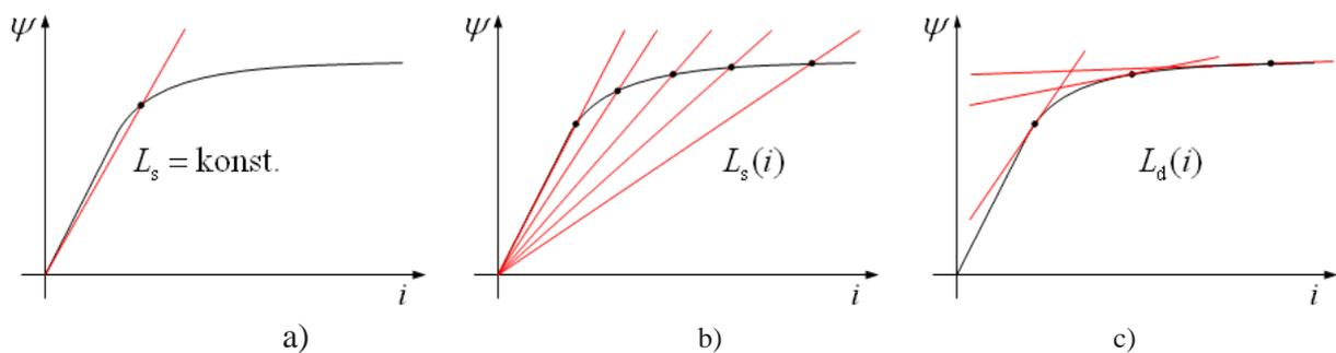
Slika 3.2. Načini određivanja induktiviteta iz krivulje magnetiziranja.
