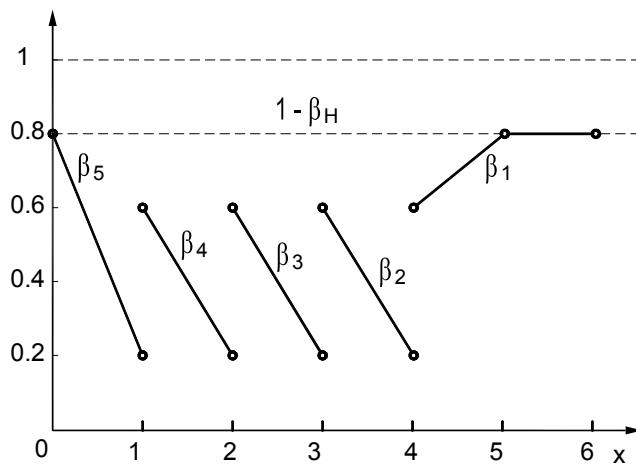
**Slika 6.6. Ocjenjivanje odvodnika prenapona na osnovu broja prorada.**
