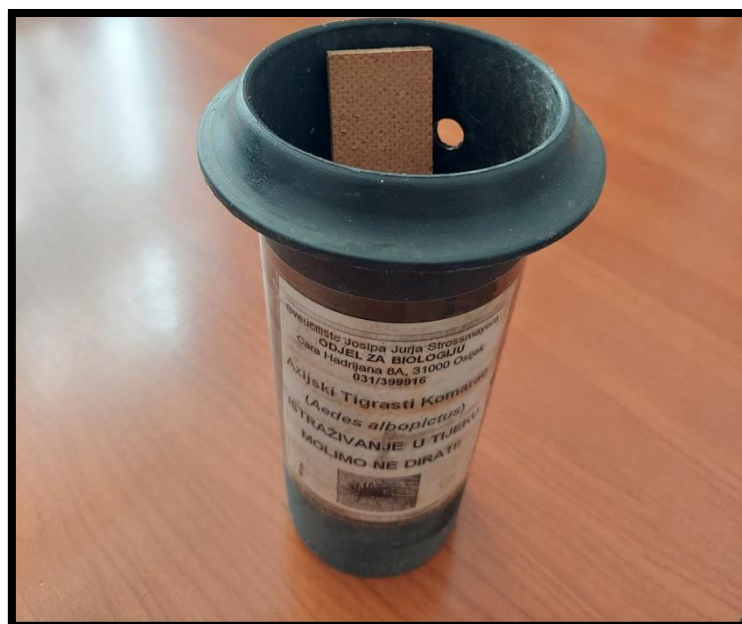
Slika 13. Ovipozijska klopka (foto: T.M.Matić)
