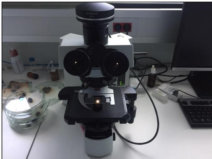
**Slika 38.** Binokularni optički mikroskop Olympus BX 51
