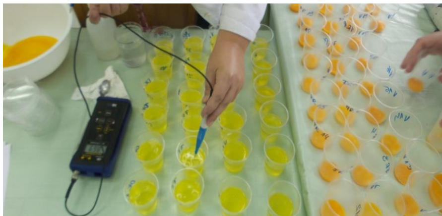
Slika 28. Mjerenje pH vrijednosti (Izvor: I. Ivanković)
