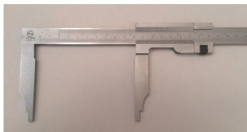
Slika 3. Pomična mjerka korištena za mjerjenje papaka.
