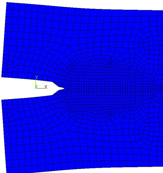
Slika 7.39 Deformirani MKE model  $C(T)$  uzorka za primjer 4
