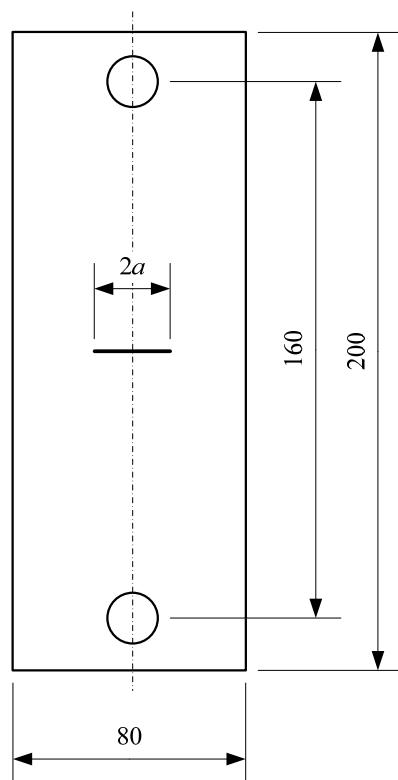
Slika 7.15 Dimenzije  $M(T)$  uzorka za primjer 3 i 5 [86]
