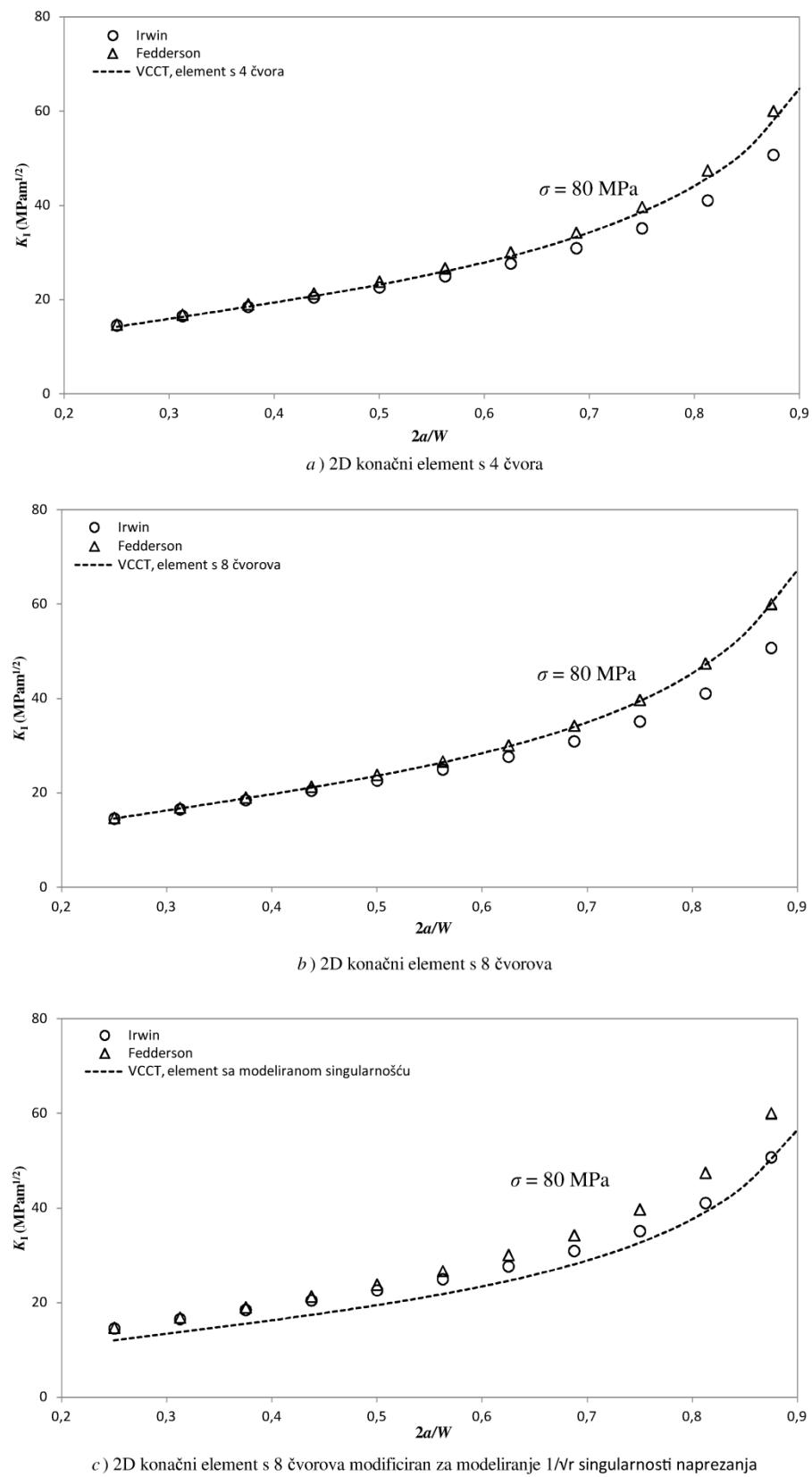
Slika 7.6 Utjecaj tipa elementa na izračunati faktor intenziteta naprezanja za ploču s centralnom pukotinom
