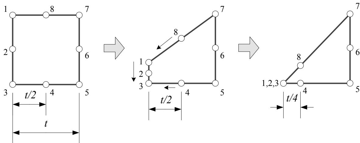
Slika 5.4 Modificirani dvodimenzijalni konačni element
