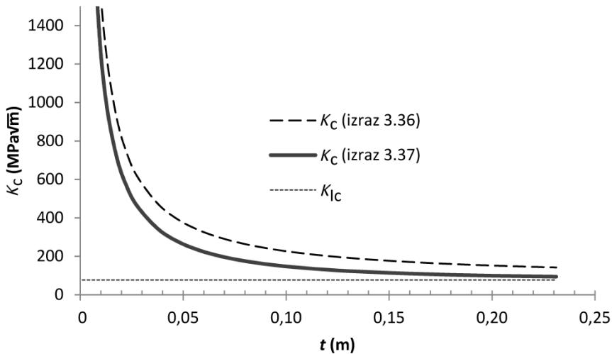
Slika 3.13 Modeli izračuna kritičnog faktora intenziteta naprezanja  $K_c$
