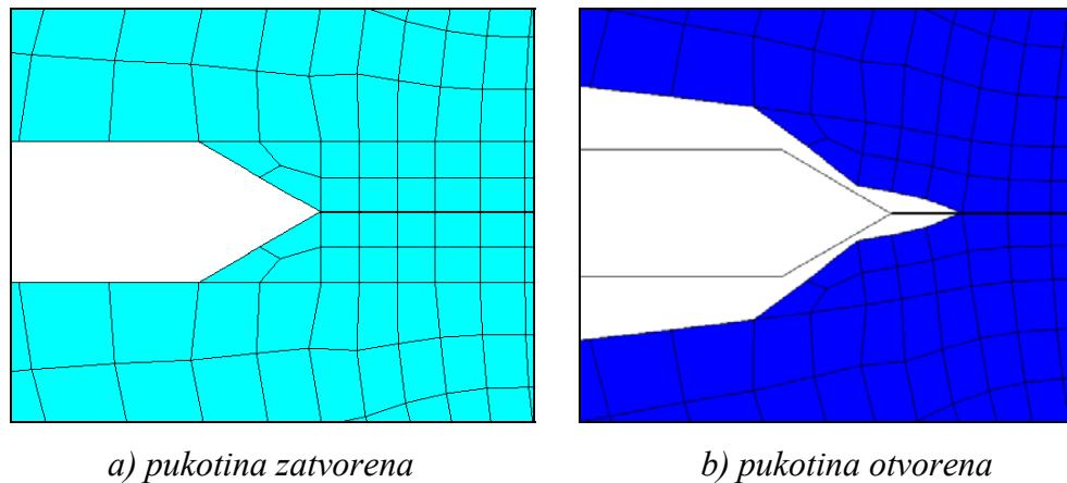
Slika 7.20 Nedeformirani i deformirani vrh pukotine za primjer 1
