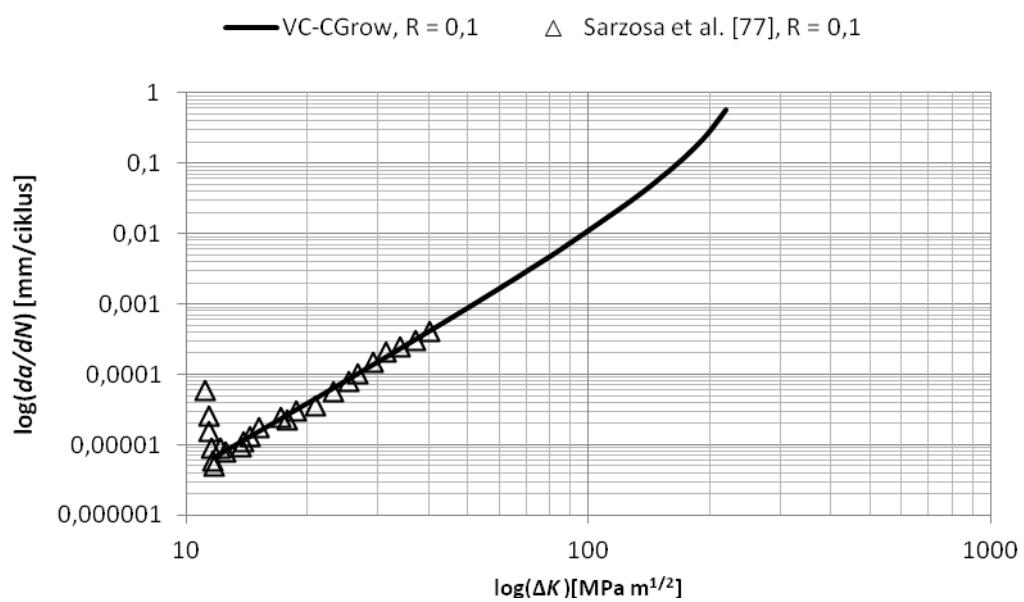
Slika 7.43 Krivulja brzine rasta pukotine za primjer 4
