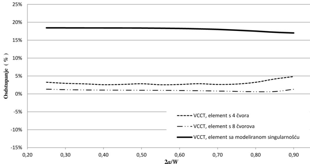
Slika 7.8 *Odstupanje faktora intenziteta naprezanja izračunatog VCCT metodom u odnosu na Feddersonovo rješenje za vlačno opterećenu ploču s centralnom pukotinom*
