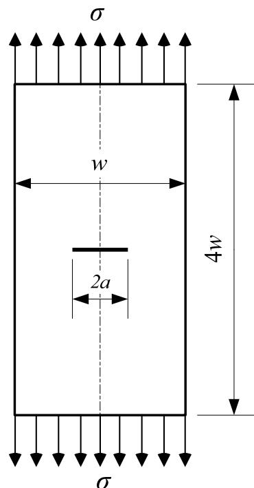
Slika 7.5 Vlačno opterećena ploča s centralnom pukotinom
