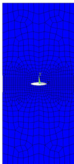
Slika 7.34 Deformirani MKE model  $M(T)$  uzorka za primjer 3
