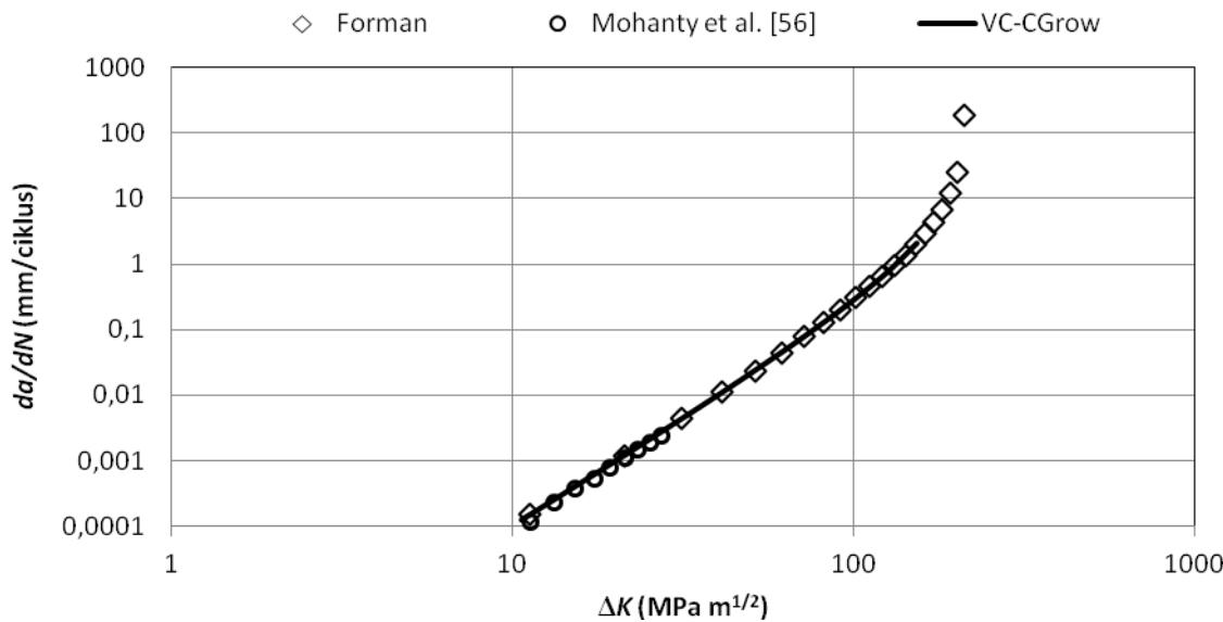
Slika 7.31 Krivulja brzine rasta pukotine za primjer 2
