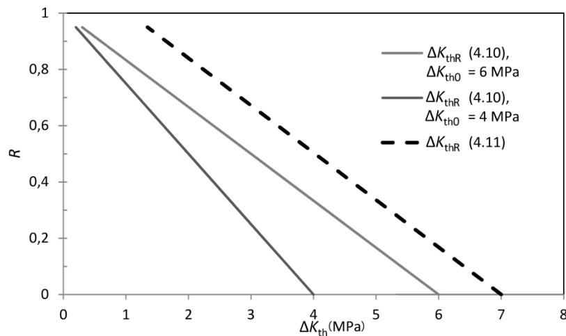
Slika 4.8 Modeli promjene minimalnog propagacijskog raspona faktora naprezanja zavisno o faktoru asimetrije ciklusa  $R$ , prema jednadžbama (4.10) i (4.11)
