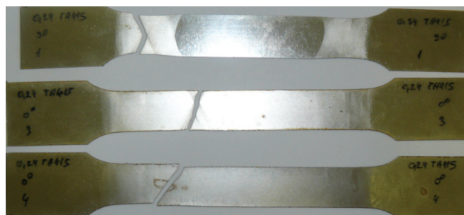
Slika 5.4 Vlačni test, ispitane epruvete, kut 0°, 45° i 90° - materijal TH415
