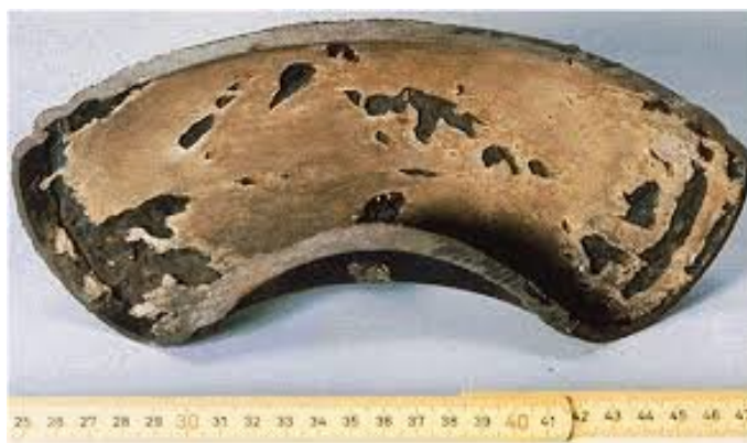
Slika 54. Erozijska korozija cijevi [108]
