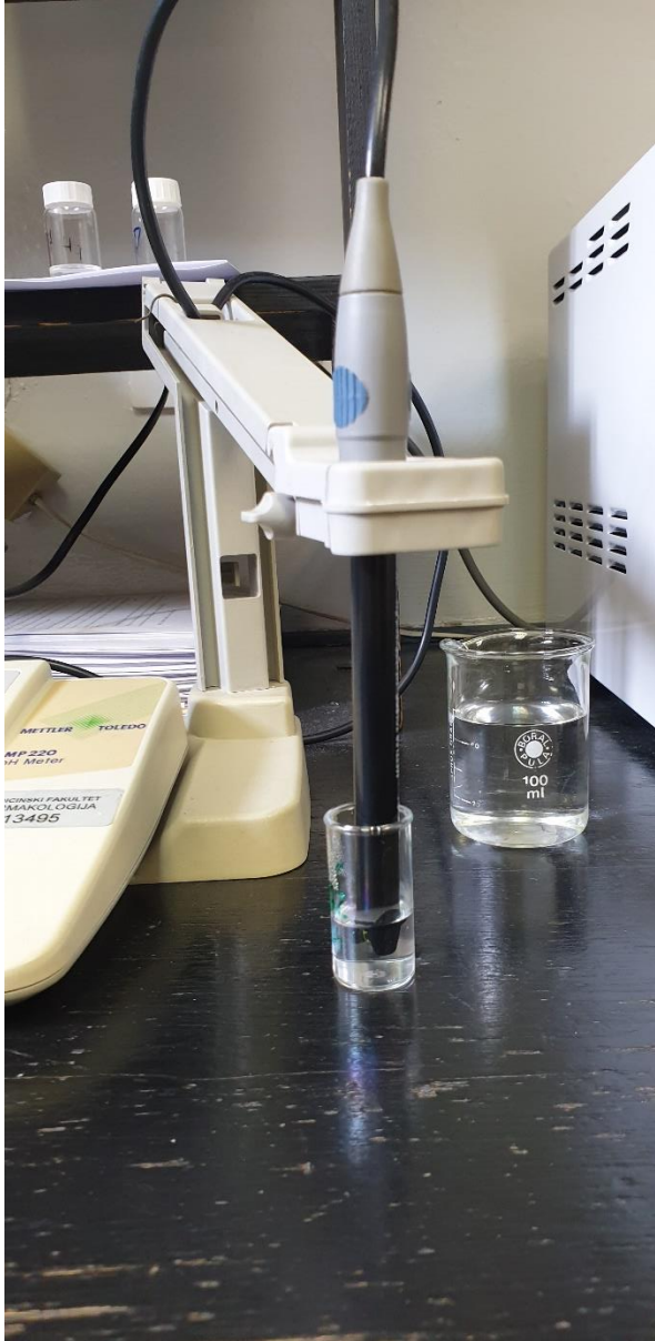
Slika 5. Mjerenje pH vrijednosti InLab Expert Pro pH elektrodom
