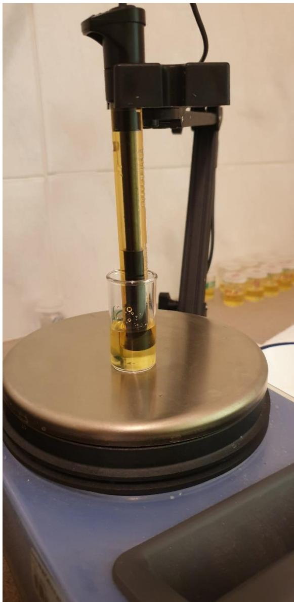
Slika 8. Mjerenje otpuštenih fluoridnih iona
