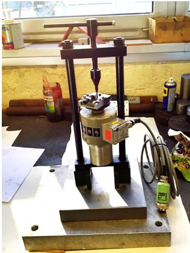
Slika 5. Pozicioniranje fiksacijske naprave na dinamometarskom stoliću
