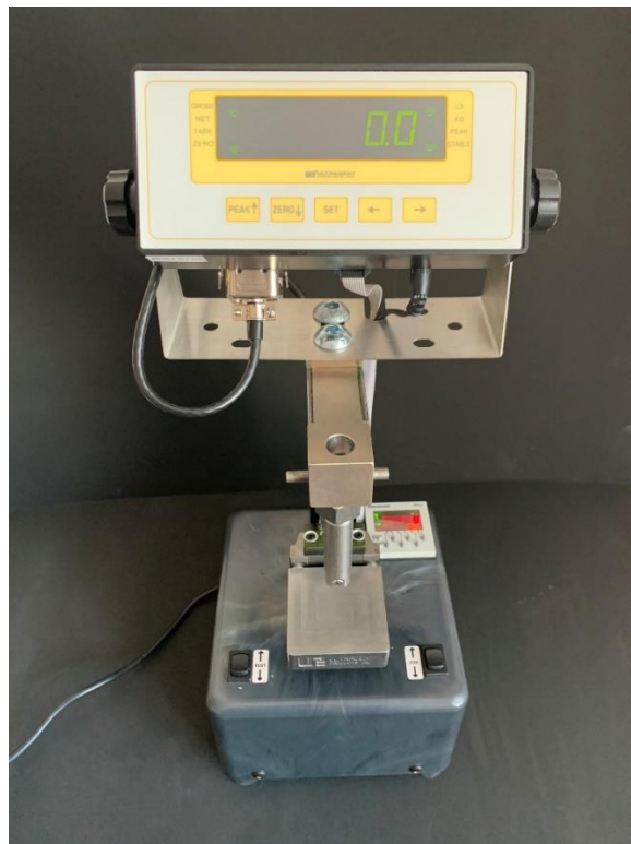
Slika 19. UltraTester stroj za ispitivanje vezne čvrstoće.
