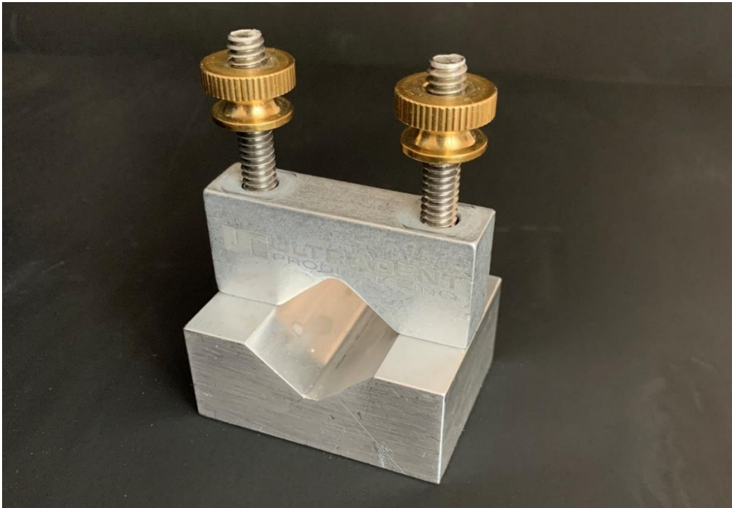
Slika 21. Držać uzorka prilikom testiranja vezne čvrstoće u UltraTesteru .
