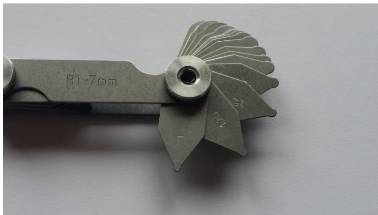
Slika 4.3. Lisnato mjerilo za mjerenje radijusa
