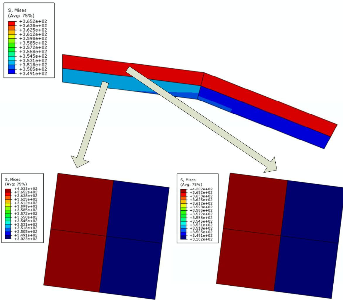
Slika 5.27 – Modeli na dvije razine: raspodjela naprezanja  $\sigma_{\text{ekv}}$  (MPa), UMAT, zadnji korak.
