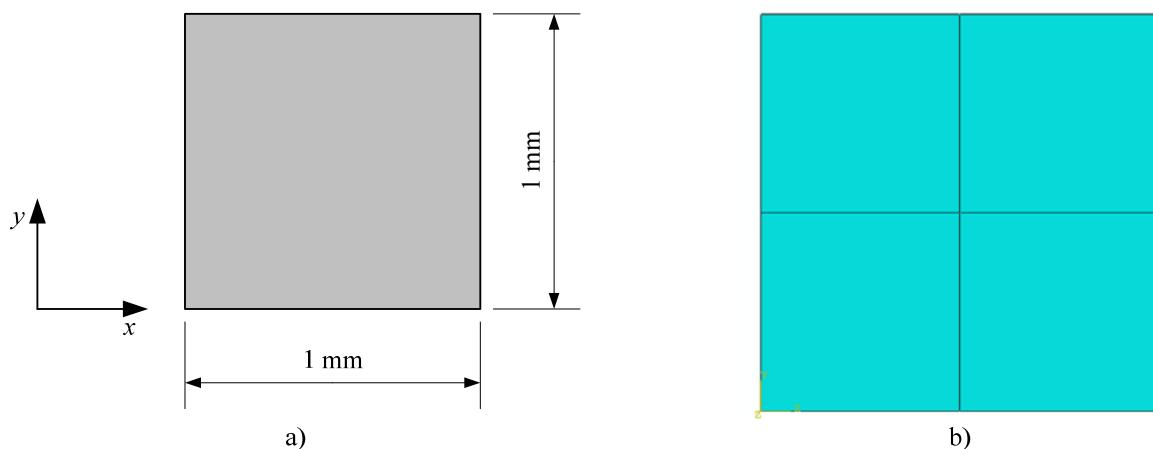
**Slika 5.7** – Model punog presjeka mikrorazine: a) geometrija sa dimenzijsama i b) mreža konačnih elemenata.
