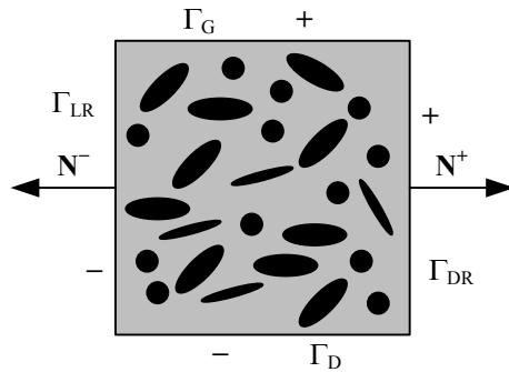
Slika 3.4 – Dvodimenzionalni RVE za postavljanje rubnih uvjeta.
