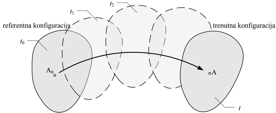
**Slika 2.1** – Položaj čestice u referentnoj i trenutnoj konfiguraciji.
