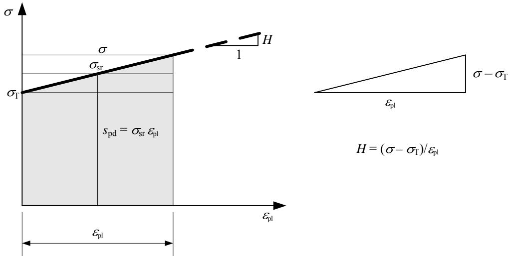
**Slika 5.2** – Raspodjela  $\sigma$ - $\varepsilon_{\text{pl}}$  i određivanje koeficijenta linearogn izotropnog očvršćenja.
