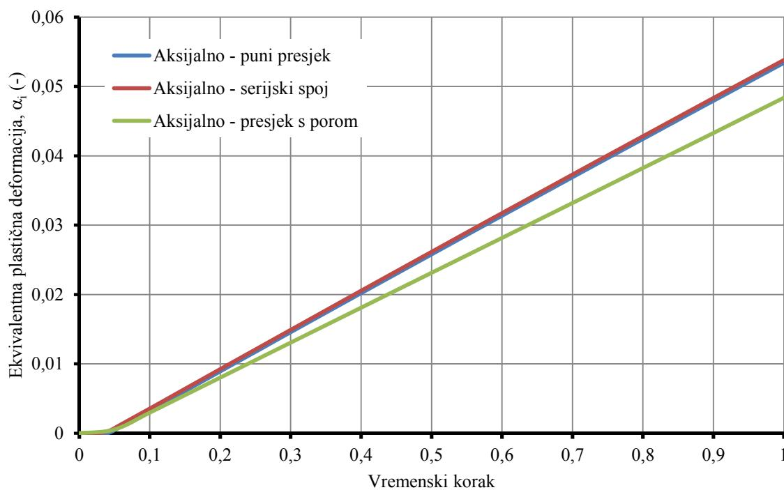
**Slika 5.19** – Dijagram plastična deformacija / vremenski korak za aksijalno opterećenje štapa: puni presjek, serijski spoj i presjek s porom.
