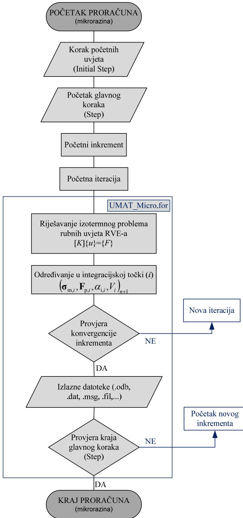
Slika 4.4 – Dijagram toka proračuna na mikrorazini (pojednostavljeni prikaz).
