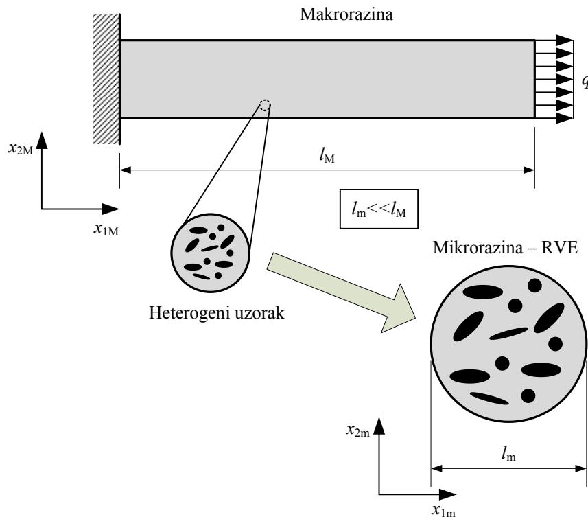
**Slika 3.1** – Shematski prikaz konstrukcije s nehomogenim materijalom na mikrorazini.
