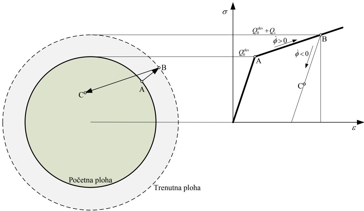
Slika 2.8 – Izotropno očvršćenje prikazano u šestodimenzijskom prostoru te za slučaj vlačnog testa.
