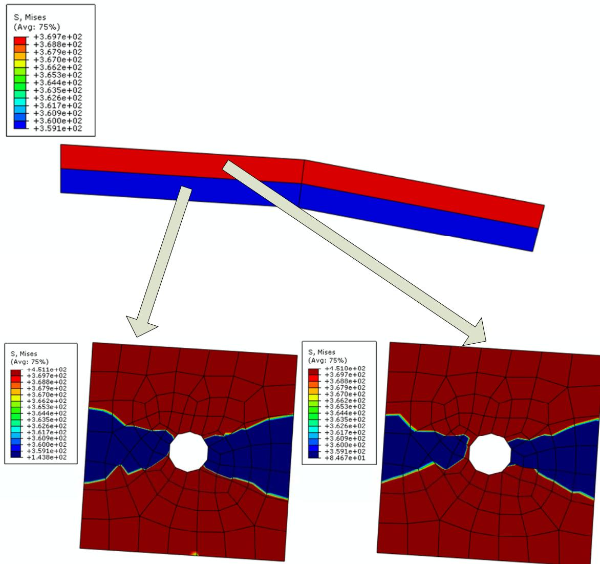
Slika 5.32 – Modeli na dvije razine: raspodjela: raspodjela naprezanja  $\sigma_{\text{ekv}}$  (MPa), UMAT, zadnji korak.
