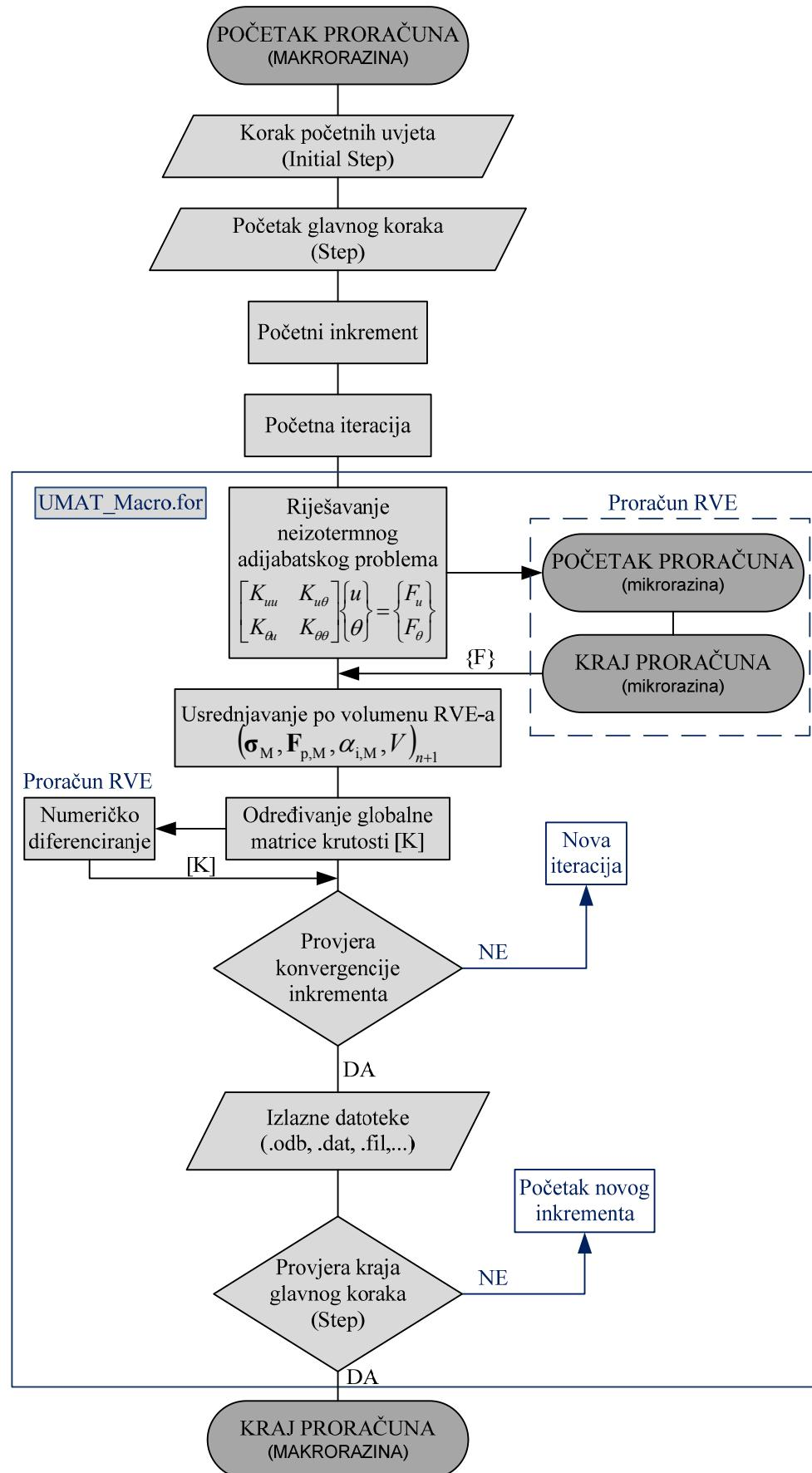
Slika 4.3 – Dijagram toka proračuna na makrorazini (pojednostavljeni prikaz).
