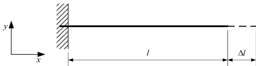
Slika 5.1 – Geometrija jednodimenzijskog štapa opterećenog aksijalnim pomakom.
