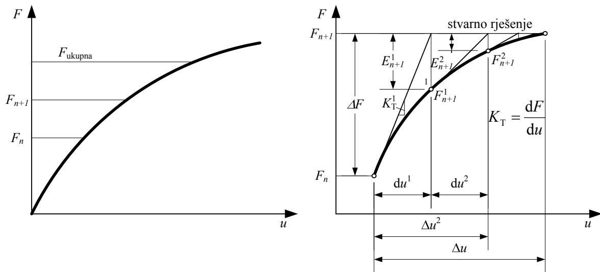
Slika 3.6 – Newton-Raphsonova metoda za jednoosni slučaj opterećenja.
