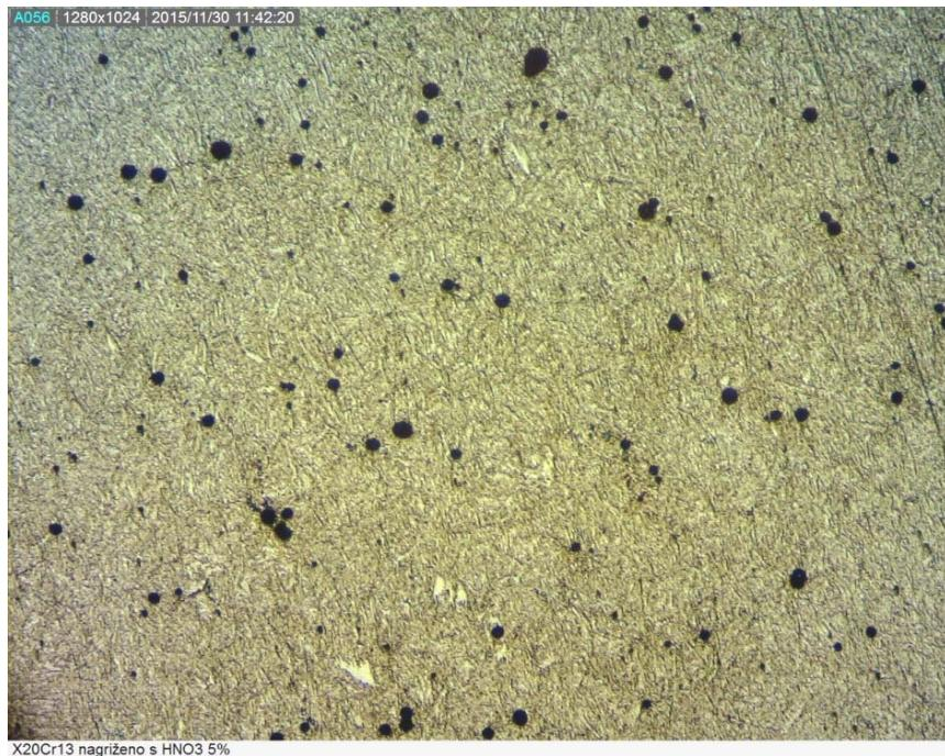
**Slika 5.1.** Mikrostruktura ispitnog materijala X20Cr13 pri povećanju 200x (nagriženo s 5 % HNO<sub>3</sub> u otopini)
