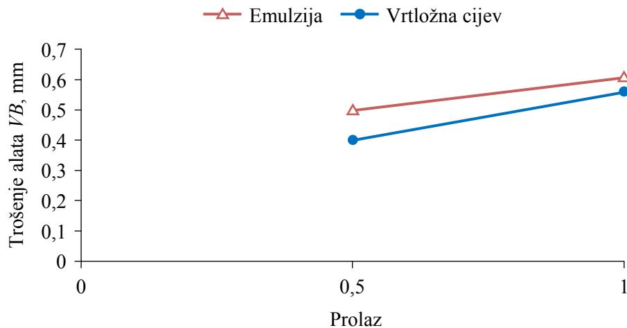
**Slika 5.33.** Trošenje alata u pokusu 1 ( $v_c = 170 \text{ m/min}$ ,  $f = 0,2 \text{ mm/o}$  i  $a_p = 0,3 \text{ mm}$ )
