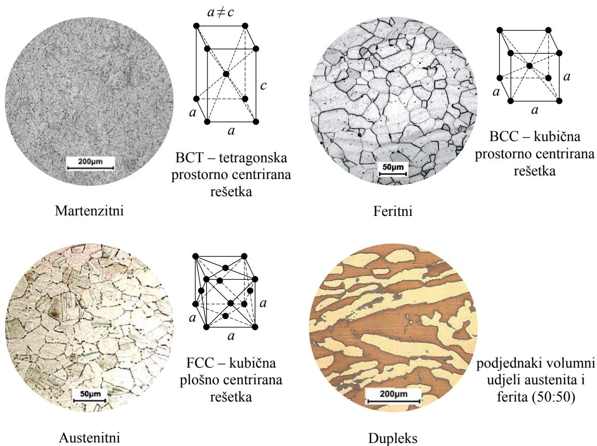
**Slika 4.2.** Primjeri mikrostruktura nehrđajućih čelika (mikrografija: [10])
