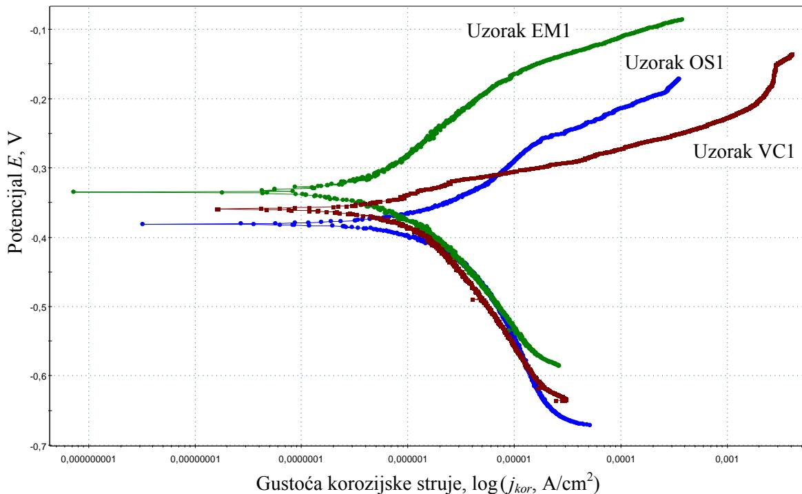
**Slika 5.22.** Usporedba potenciodinamičkih polarizacijskih krivulja za ispitivane uzorke X20Cr13 (3,5 %-tna vodena otopina NaCl na 25 °C, brzina pretraživanja 0,166 mV/s). EM1 uzorak tokaren uz hlađenje emulzijom, VC1 uzorak tokaren uz hlađenje vrtložnom cijevi, OS1 osnovni (neobrađeni) uzorak
