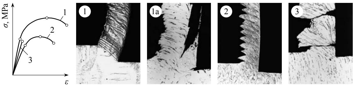
**Slika 2.3.** Ovisnost oblika strugotine o mehaničkim svojstvima materijala obratka. 1 tekuća strugotina, 1a tekuća strugotina i naljepak na prednjoj površini alata, 2 naslagana strugotina, 3 trgana strugotina,  $\varepsilon$  deformacija,  $\sigma$  normalno naprezanje (mikrografija: [21])
