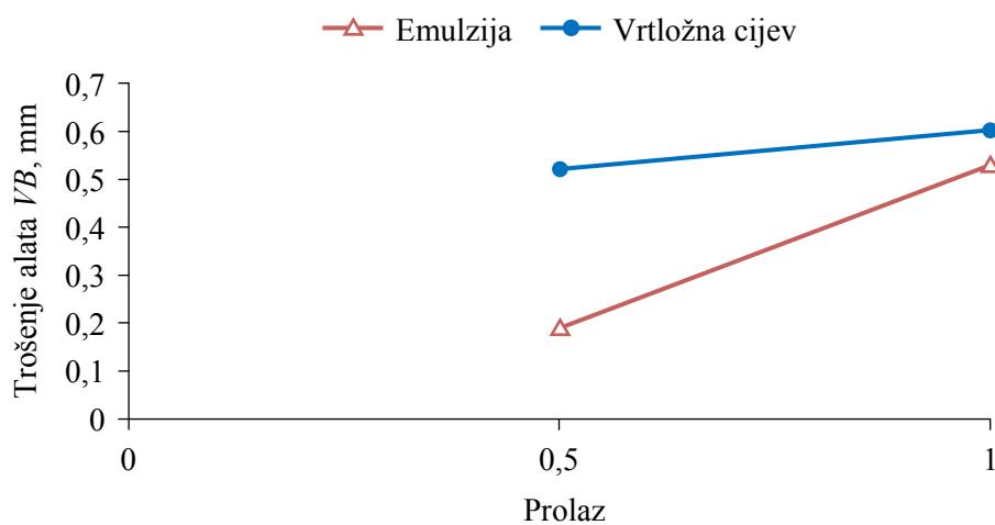
**Slika 5.41.** Trošenje alata u pokusu 9 ( $v_c = 220 \text{ m/min}$ ,  $f = 0,3 \text{ mm/o}$  i  $a_p = 0,4 \text{ mm}$ )
