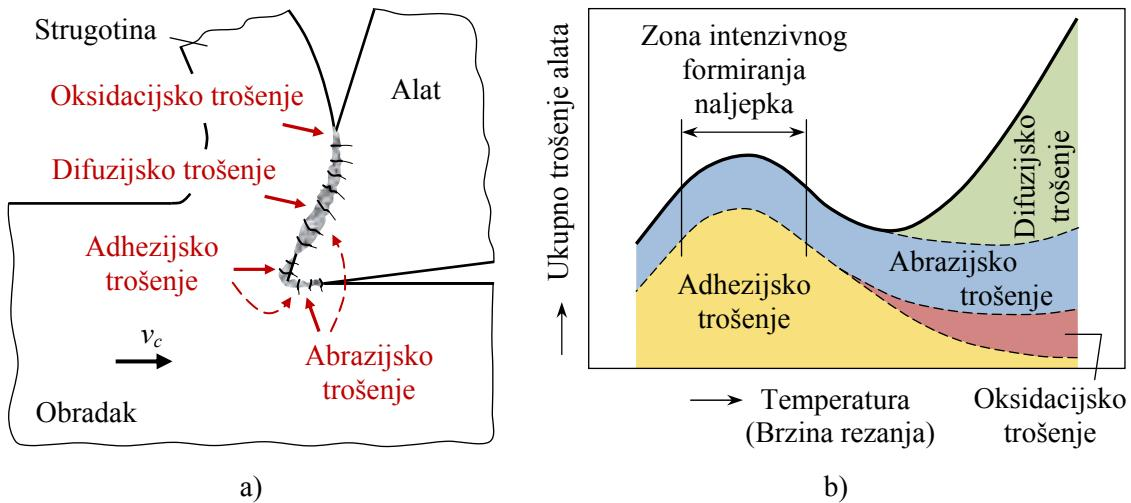
**Slika 2.6.** Mehanizmi trošenja alata. a) glavna područja adhezijskog, abrazijskog, difuzijskog i oksidacijskog trošenja na alatu, b) relativni udjeli različitih mehanizama u ukupnom trošenju alata s obzirom na temperaturu rezanja (brzinu rezanja)
