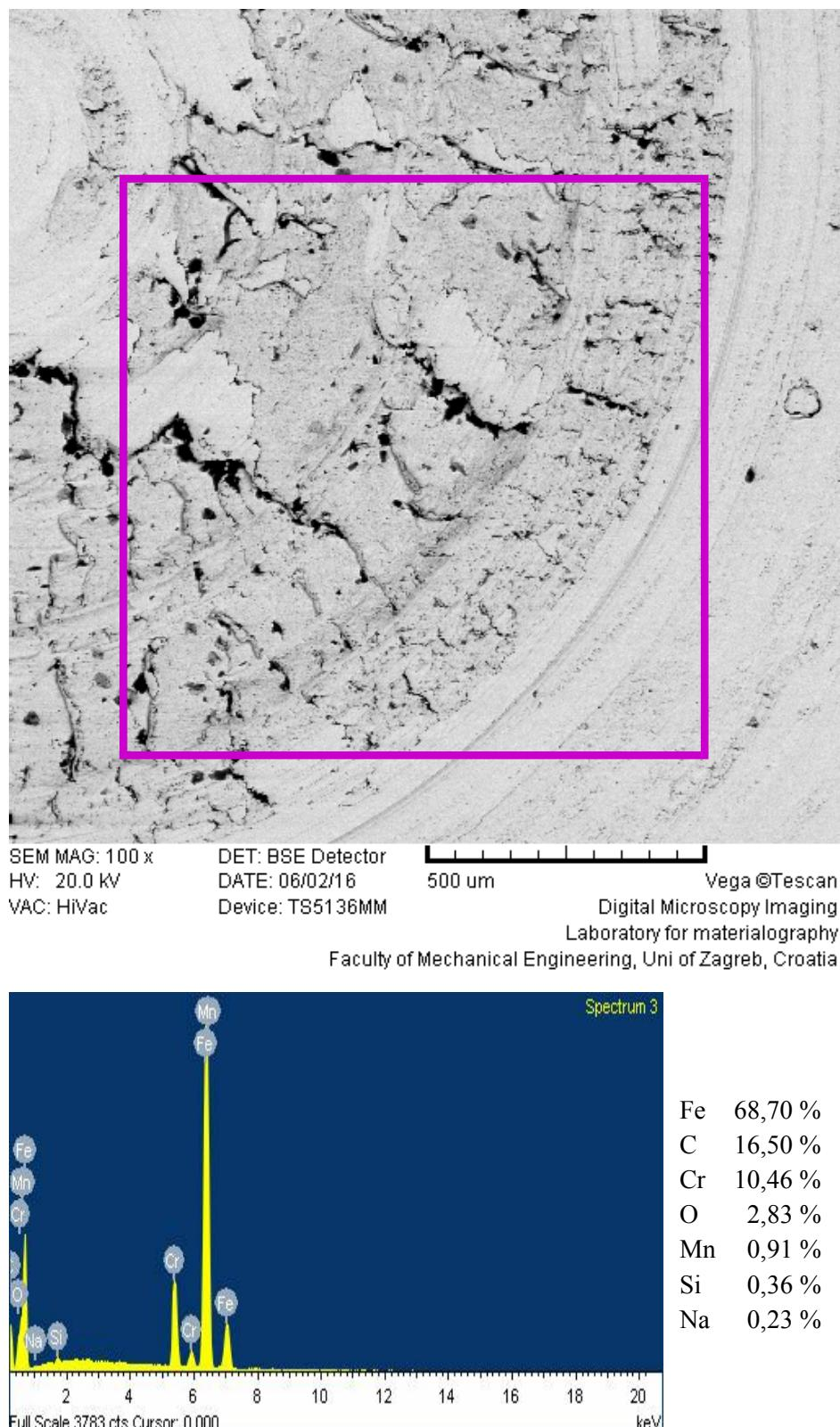
**Slika 5.25.** SEM/EDS analiza osnovnog (neobrađenog) uzorka X20Cr13 nakon izlaganja elektrolitu (3,5 %-tina vodena otopina NaCl na 25 °C, 30 min)
