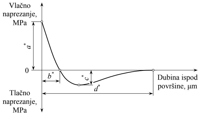
**Slika 4.7.** Parametri profila obodnih zaostalih naprezanja nakon tokarenja nehrđajućih čelika.  $a^*$  najveće vlačno naprezanje,  $b^*$  dubina vlačnog naprezanja,  $c^*$  najveće tlačno naprezanje,  $d^*$  dubina zaostalih naprezanja
