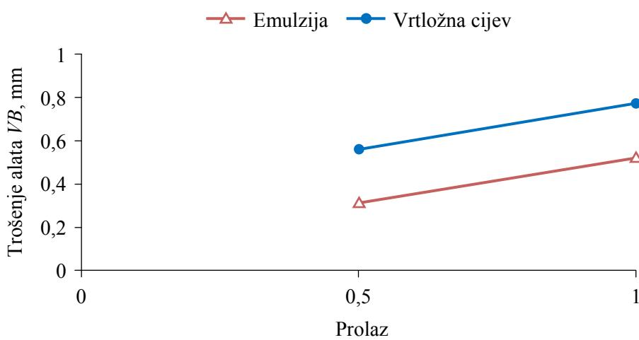
**Slika 5.50.** Trošenje alata u pokusu 18 ( $v_c = 220 \text{ m/min}$ ,  $f = 0,47 \text{ mm/o}$  i  $a_p = 0,4 \text{ mm}$ )
