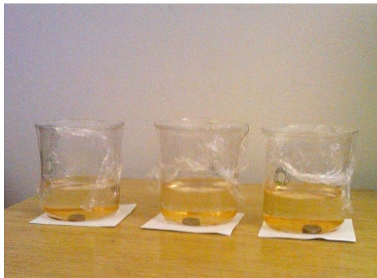
Slika 5.11. Laboratorijska vaga i uzorci (OS2, EM2 i VC2) uronjeni u elektrolit (3,5 %-tna vodena otopina NaCl temperature 25 °C)
