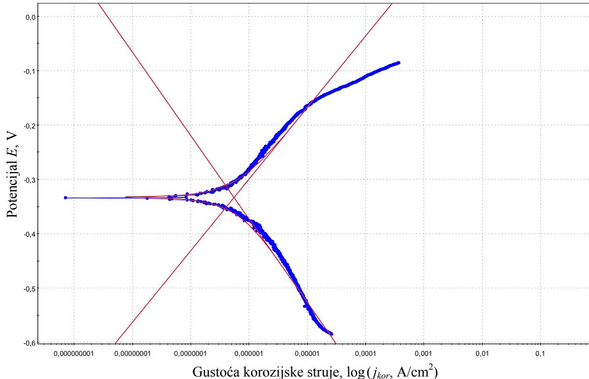
**Slika 5.20.** Potenciodynamicke polarizacijske krivulje za uzorak X20Cr13 tokaren uz hlađenje emulzijom (3,5 %-tna vodena otopina NaCl na 25 °C, brzina pretraživanja 0,166 mV/s)
