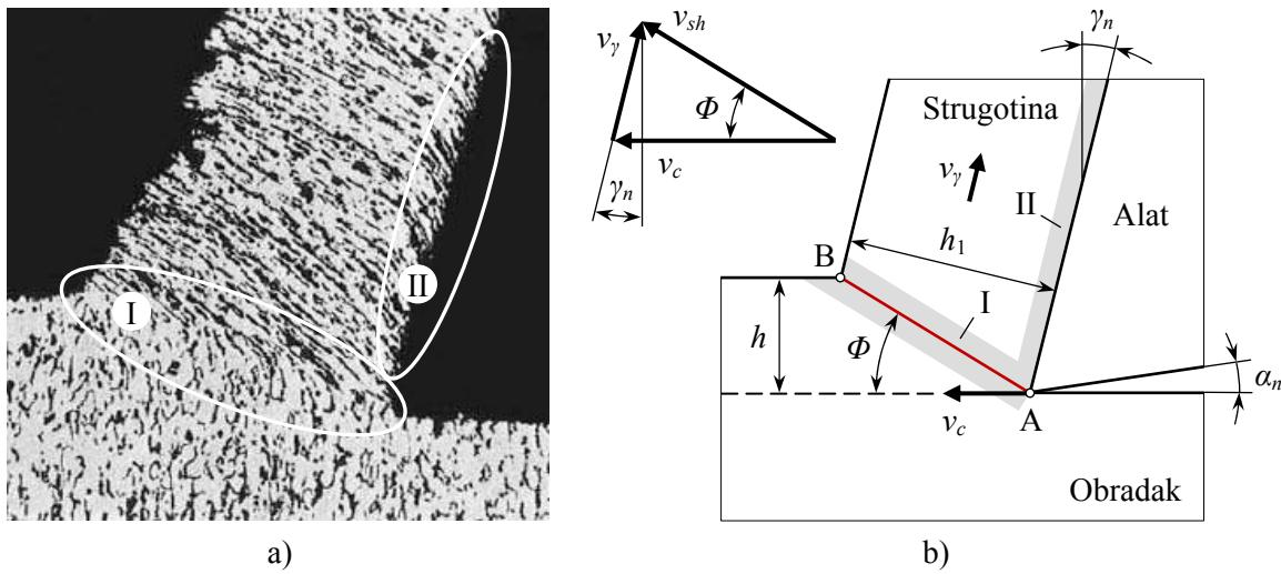
**Slika 2.2.** Zone smicanja kod stvaranja strugotine. a) mikrograf korijena strugotine [75], b) jednostavni model ortogonalnog rezanja; I primarna zona smicanja, II sekundarna zona smicanja, AB idealizirana ravnina smicanja,  $h$  debљina neodrezane strugotine,  $h_1$  debљina skinute strugotine,  $v_c$  brzina rezanja,  $v_{sh}$  brzina smicanja,  $v_\gamma$  brzina strugotine,  $\Phi$  kut smicanja,  $\alpha_n$  normalni stražnji kut alata,  $\gamma_n$  normalni prednji kut alata
