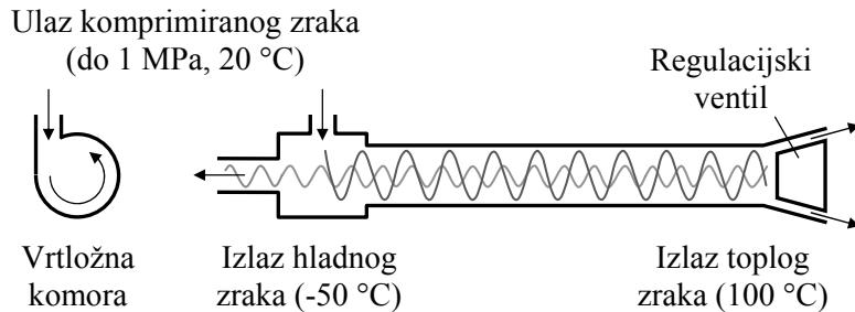
**Slika 3.9.** Načelo rada vrtložne cijevi protusmjernog protoka (shema)
