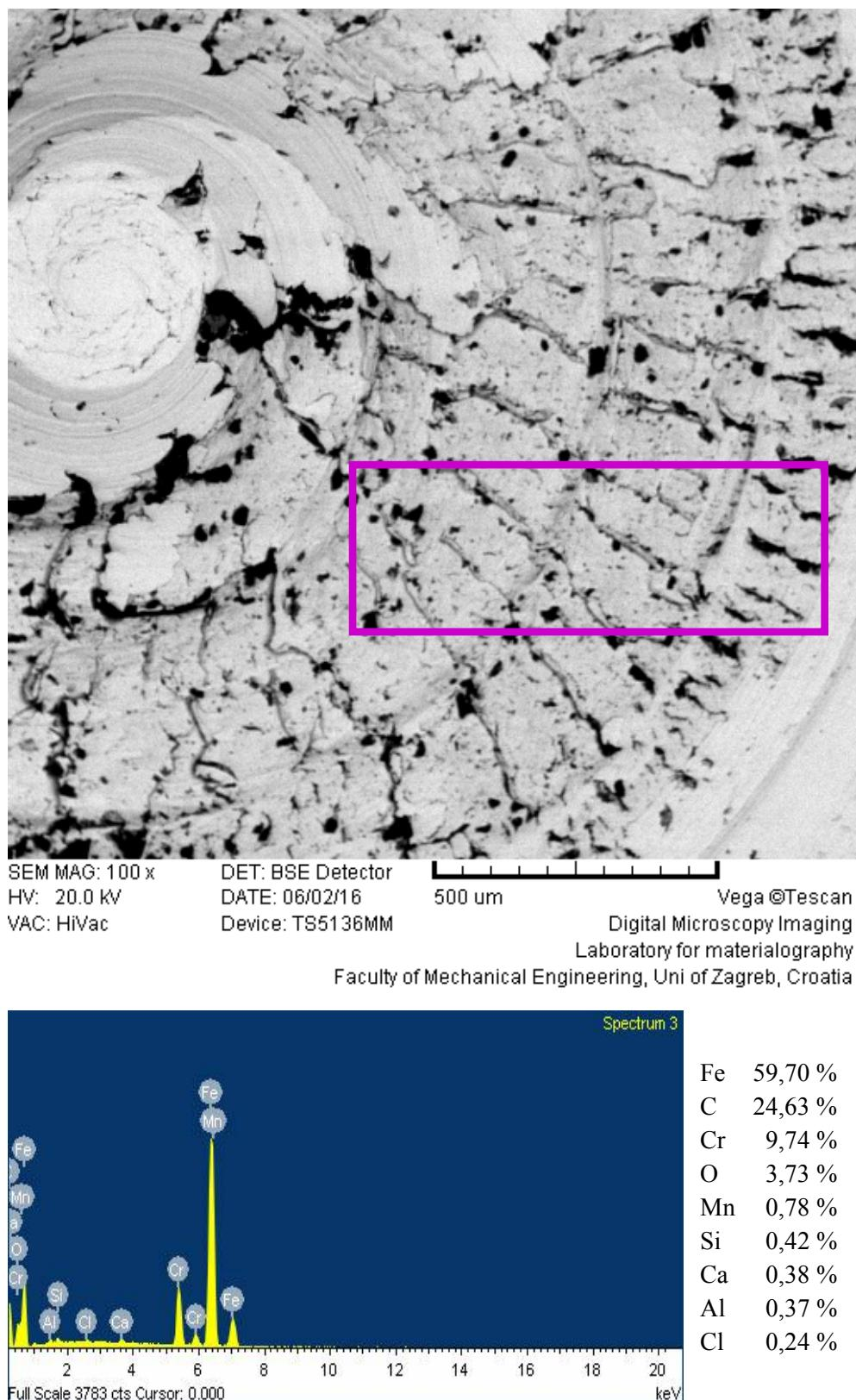
**Slika 5.26.** SEM/EDS analiza uzorka X20Cr13 tokarenog uz hlađenje emulzijom
