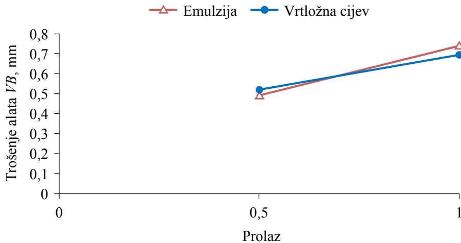
**Slika 5.36.** Trošenje alata u pokusu 4 ( $v_c = 270 \text{ m/min}$ ,  $f = 0,4 \text{ mm/o}$  i  $a_p = 0,3 \text{ mm}$ )
