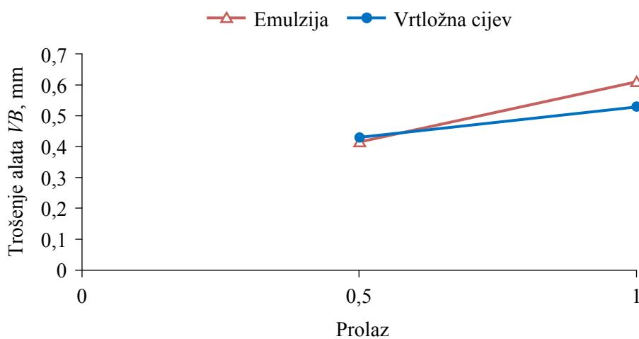
**Slika 5.37.** Trošenje alata u pokusu 5 ( $v_c = 170 \text{ m/min}$ ,  $f = 0,2 \text{ mm/o}$  i  $a_p = 0,5 \text{ mm}$ )
