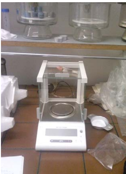
Slika 5.11. Laboratorijska vaga i uzorci (OS2, EM2 i VC2) uronjeni u elektrolit (3,5 %-tna vodena otopina NaCl temperature 25 °C)
