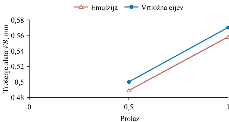
**Slika 5.38.** Trošenje alata u pokusu 6 ( $v_c = 270 \text{ m/min}$ ,  $f = 0,2 \text{ mm/o}$  i  $a_p = 0,5 \text{ mm}$ )
