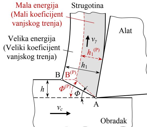
**Slika 3.1.** Učinak podmazivanja na stvaranje strugotine. P podmazivanje; AB, AB<sup>(P)</sup> idealizirane ravnine smicanja, h debljina neodrezane strugotine, h<sub>1</sub>, h<sub>1</sub><sup>(P)</sup> debljine skinute strugotine, v<sub>c</sub> brzina rezanja, v<sub>y</sub> brzina strugotine, Φ, Φ<sup>(P)</sup> kutovi smicanja
