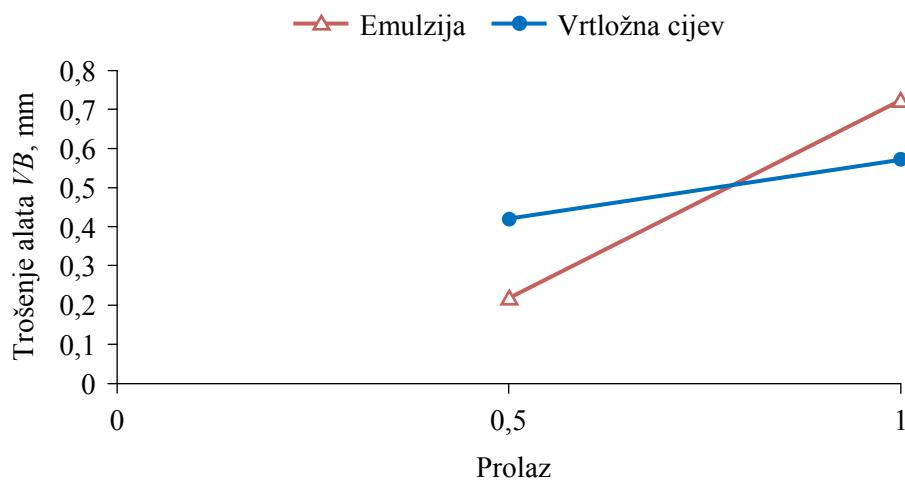
**Slika 5.34.** Trošenje alata u pokusu 2 ( $v_c = 270 \text{ m/min}$ ,  $f = 0,2 \text{ mm/o}$  i  $a_p = 0,3 \text{ mm}$ )
