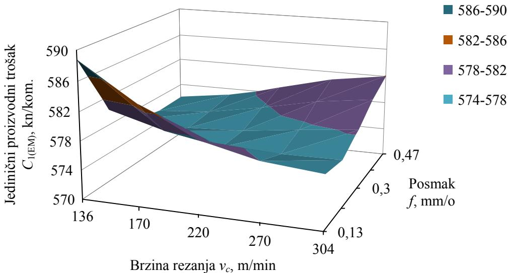
**Slika 6.1.** Zavisnost jediničnog proizvodnog troška od brzine rezanja i posmaka kod tokarenja ispitnog materijala X20Cr13 uz hlađenje emulzijom (dubina rezanja  $a_p = 0,5$  mm)
