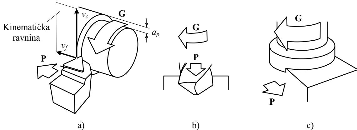
**Slika 2.1.** Gibanja alata i obratka kod primarnih postupaka obrade rezanjem. a) tokarenje, b) bušenje, c) glodanje; G glavno gibanje, P posmično gibanje,  $a_p$  dubina rezanja,  $v_c$  brzina rezanja,  $v_f$  posmična brzina
