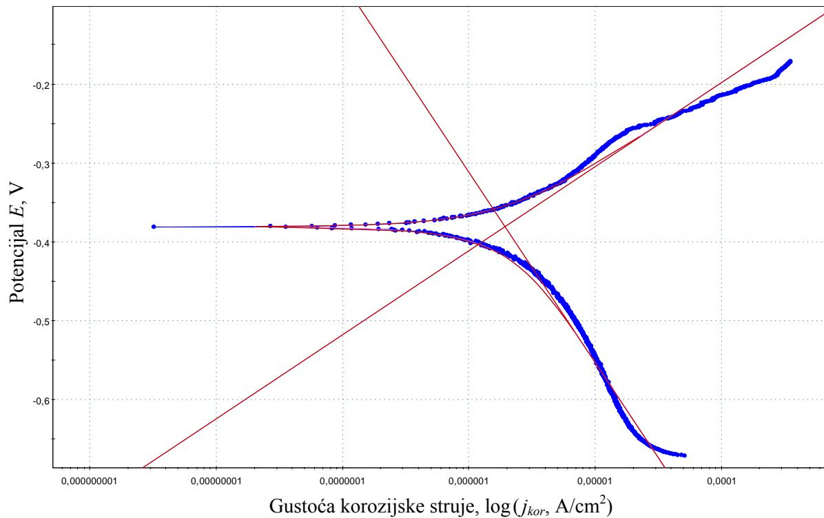
**Slika 5.19.** Potenciodynamicke polarizacijske krivulje za osnovni (neobrađeni) uzorak X20Cr13 (3,5 %-tna vodena otopina NaCl na 25 °C, brzina pretraživanja 0,166 mV/s)
