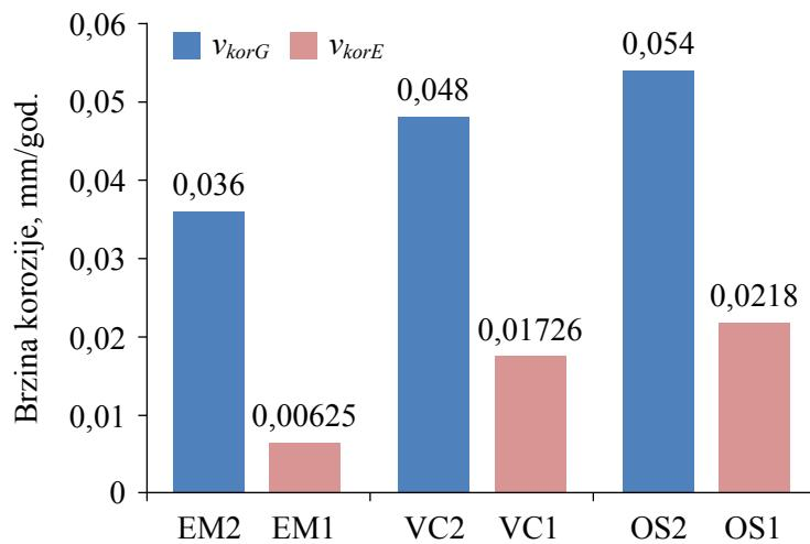
**Slika 5.23.** Usporedba gravimetrijskih  $v_{korG}$  i elektrokemijskih  $v_{korE}$  brzina korozije za ispitivane uzorke X20Cr13. EMx uzorak tokaren uz hlađenje emulzijom, VCx uzorak tokaren uz hlađenje vrtložnom cijevi, OSx osnovni (neobrađeni) uzorak
