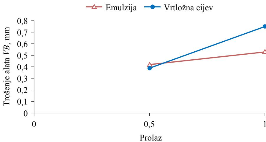
**Slika 5.49.** Trošenje alata u pokusu 17 ( $v_c = 220 \text{ m/min}$ ,  $f = 0,13 \text{ mm/o}$  i  $a_p = 0,4 \text{ mm}$ )
