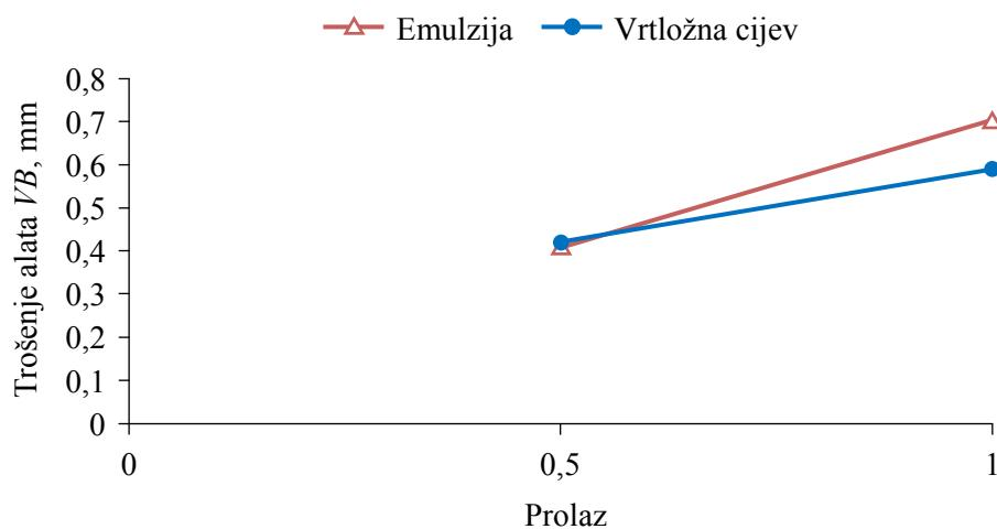
**Slika 5.35.** Trošenje alata u pokusu 3 ( $v_c = 170 \text{ m/min}$ ,  $f = 0,4 \text{ mm/o}$  i  $a_p = 0,3 \text{ mm}$ )
