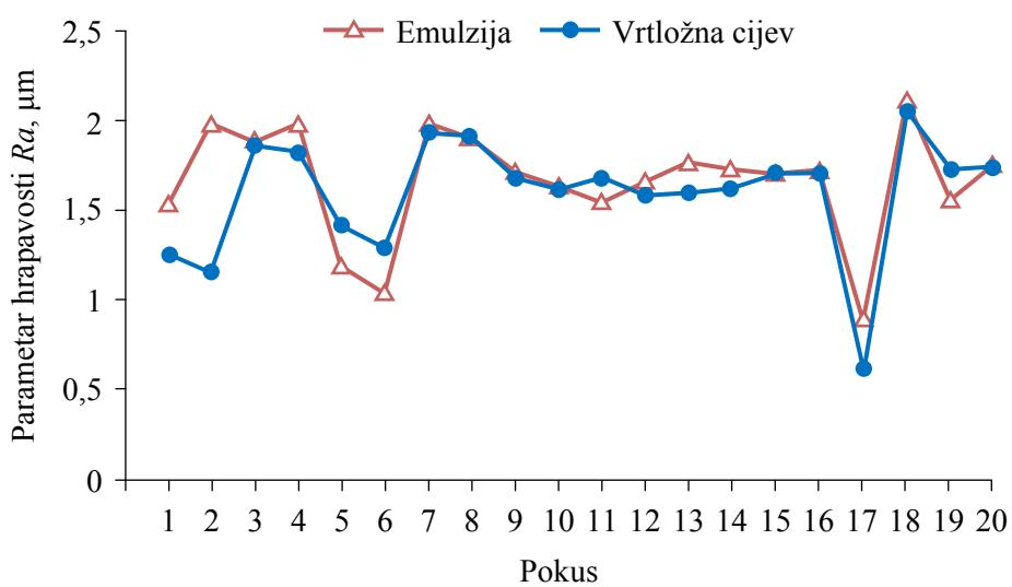
**Slika 5.30.** Usporedba rezultata mjerena hrapavosti obrađene površine
