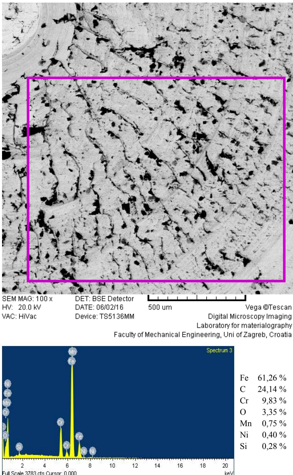
**Slika 5.27.** SEM/EDS analiza uzorka X20Cr13 tokarenog uz hlađenje emulzijom nakon izlaganja elektrolitu (3,5 %-tne vodene otopine NaCl na 25 °C, 30 min)
