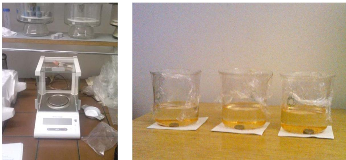
**Slika 5.11.** Laboratorijska vaga i uzorci (OS2, EM2 i VC2) uronjeni u elektrolit (3,5 %-tna vodena otopina NaCl temperature 25 °C)
