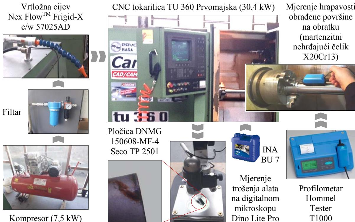
**Slika 5.14.** Eksperimentalna konfiguracija za ispitivanje obradivosti
