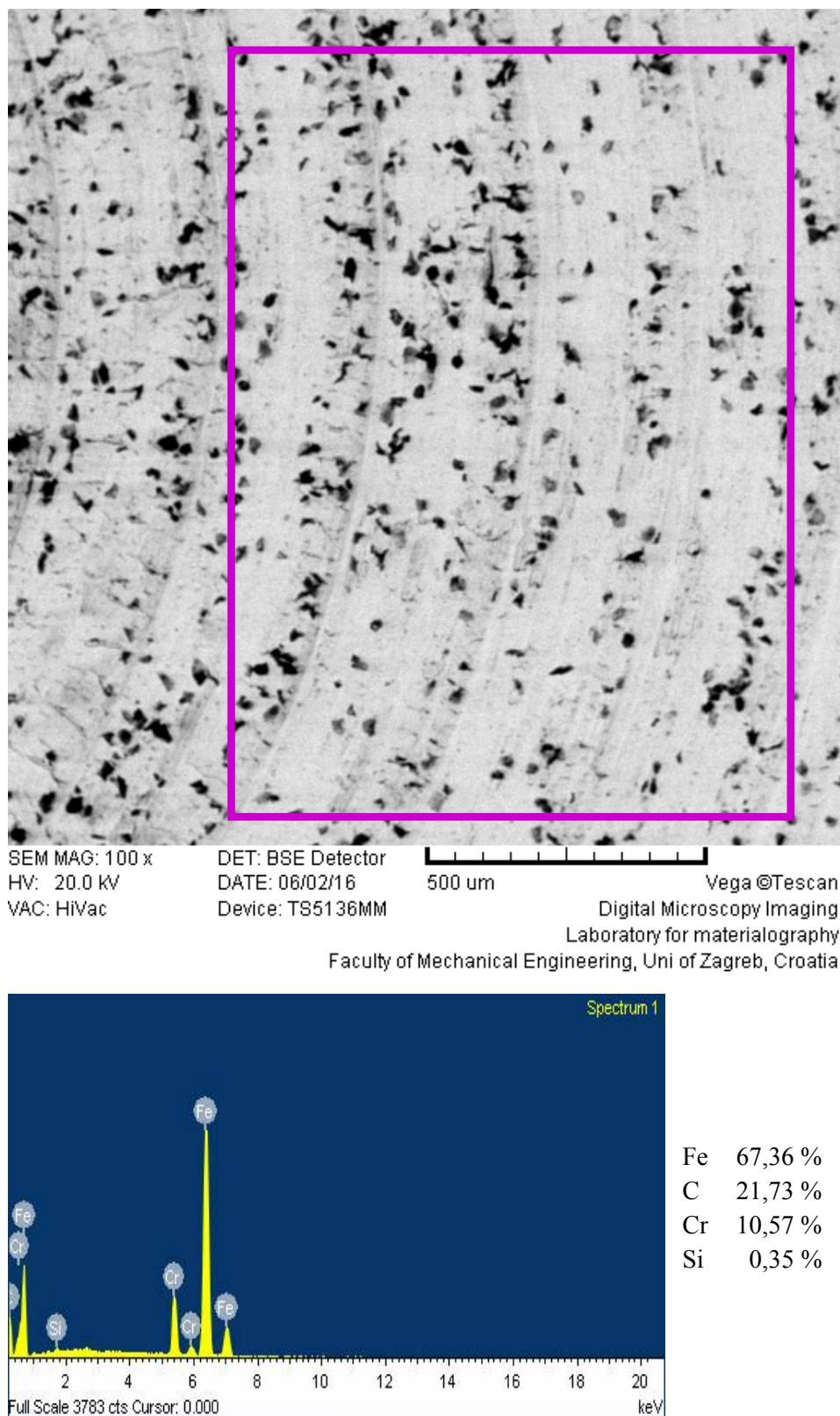
Slika 5.24. SEM/EDS analiza osnovnog (neobrađenog) uzorka X20Cr13
