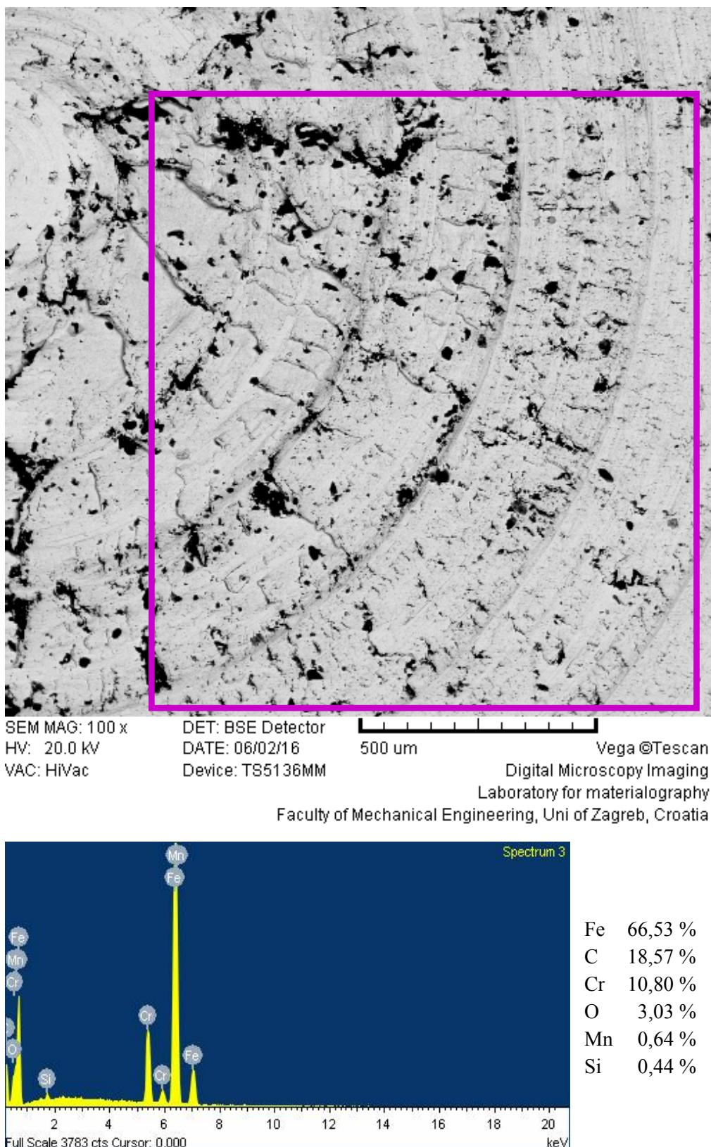
**Slika 5.29.** SEM/EDS analiza uzorka X20Cr13 tokarenog uz hlađenje vrtložnom cijevi nakon izlaganja elektrolitu (3,5 %-tina vodena otopina NaCl na 25 °C, 30 min)
