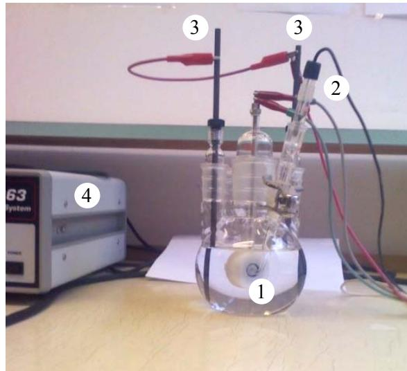
**Slika 5.9.** Elektrokemijska celija. 1 - radna elektroda (ispitni uzorak), 2 - referentna elektroda, 3 - protuelektrode, 4 - potencijostat
