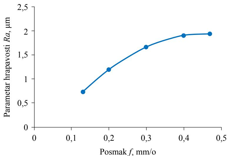
**Slika 5.32.** Zavisnost hrapavosti obrađene površine od parametara rezanja prema matematičkom modelu (5.14) za tokarenje ispitnog materijala X20Cr13 uz hlađenje vrtložnom cijevi
