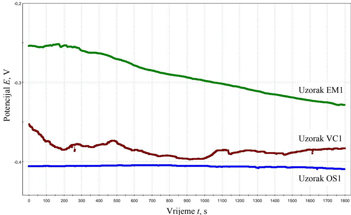
**Slika 5.18.** Usporedba zavisnosti potencijala kod otvorenog strujnog kruga od vremena za ispitivane uzorke X20Cr13 u 3,5 %-tnoj vodenoj otopini NaCl na 25 °C. EM1 uzorak tokaren uz hlađenje emulzijom, VC1 uzorak tokaren uz hlađenje vrtložnom cijevi, OS1 osnovni (neobrađeni) uzorak
