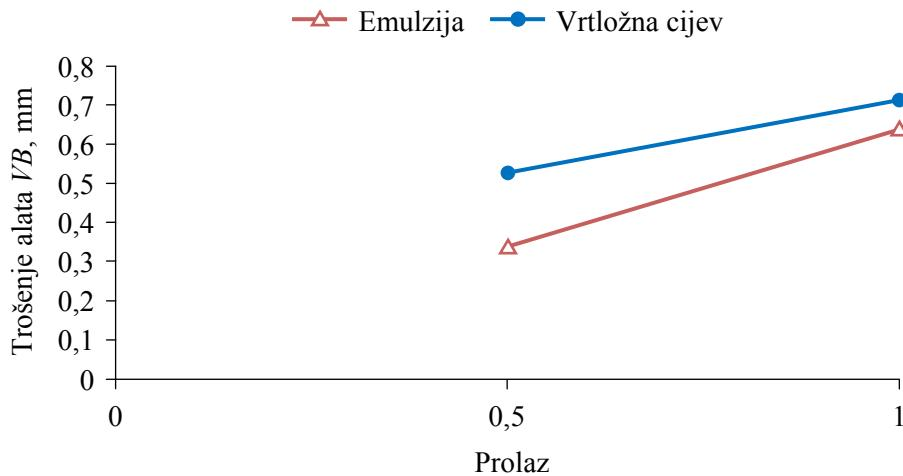
**Slika 5.48.** Trošenje alata u pokusu 16 ( $v_c = 304 \text{ m/min}$ ,  $f = 0,3 \text{ mm/o}$  i  $a_p = 0,4 \text{ mm}$ )
