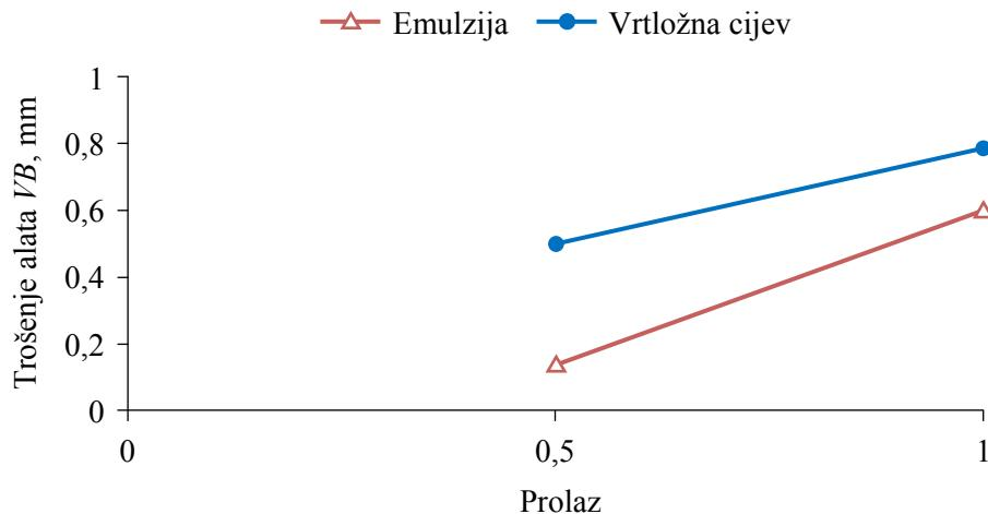
**Slika 5.39.** Trošenje alata u pokusu 7 ( $v_c = 170 \text{ m/min}$ ,  $f = 0,4 \text{ mm/o}$  i  $a_p = 0,5 \text{ mm}$ )
