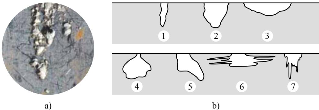
**Slika 4.5.** Rupičasta korozija. a) detalj, b) tipične morfologije degradacije metala prema ASTM G46-94 [6] (1 - uska i duboka, 2 - eliptična, 3 - široka i plitka, 4 – ispod površinska, 5 - podrivna, 6 - horizontalna, 7 - vertikalna)
