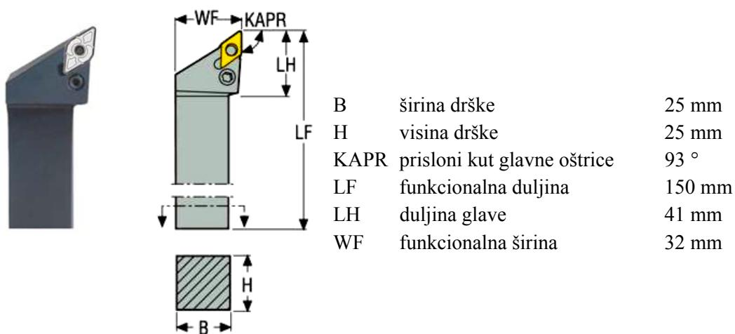
**Slika 5.5.** SECO držač pločice PDNXL 2525M15 ([www.secotools.com](http://www.secotools.com))
