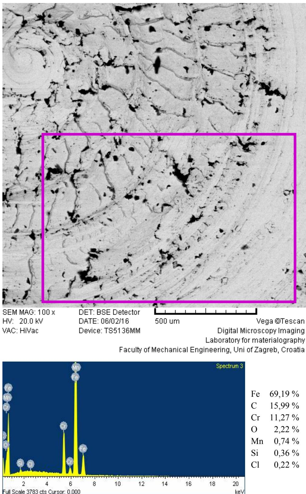
**Slika 5.28.** SEM/EDS analiza uzorka X20Cr13 tokarenog uz hlađenje vrtložnom cijevi
