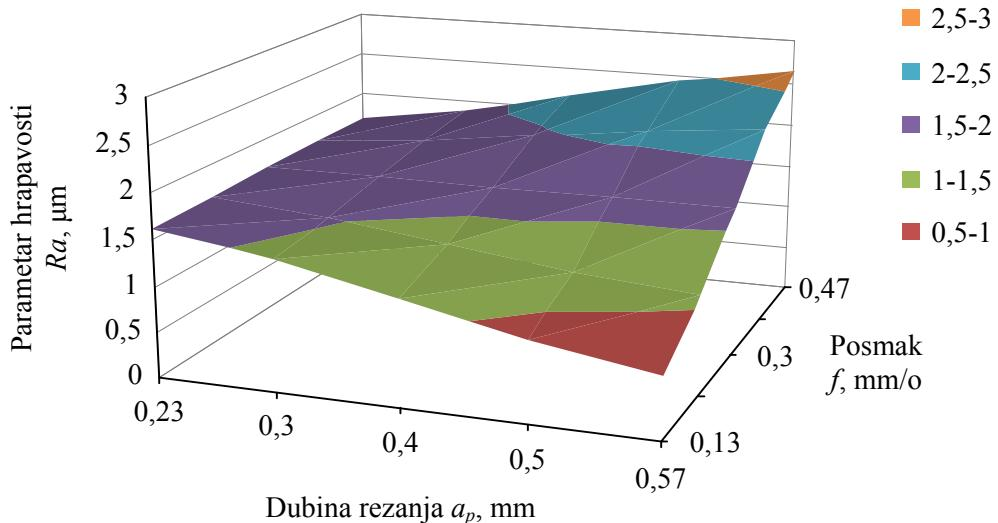
**Slika 5.31.** Zavisnost hrapavosti obradene površine od parametara rezanja prema matematičkom modelu (5.13) za tokarenje ispitnog materijala X20Cr13 uz hlađenje emulzijom
