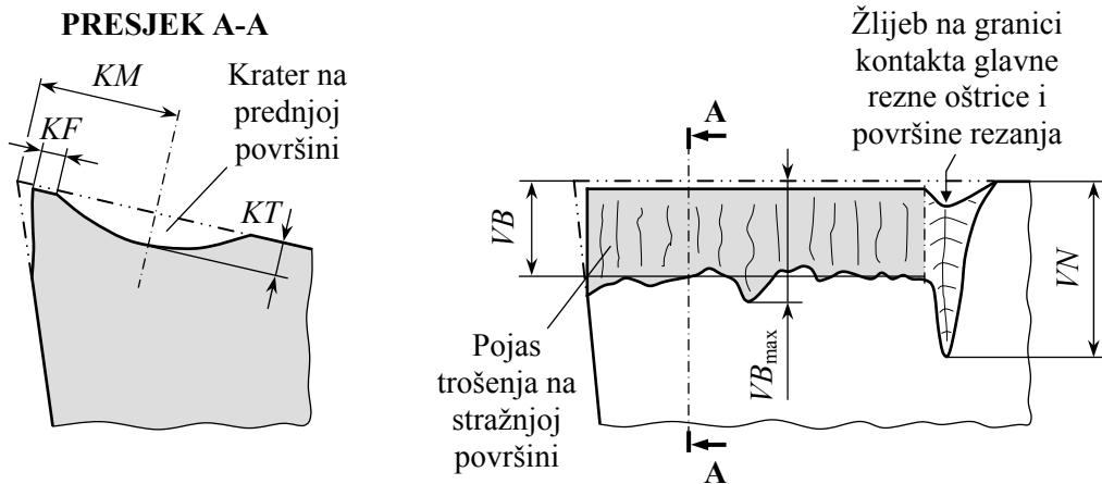
**Slika 2.8.** Karakteristični parametri trošenja prednje i stražnje površine alata prema normi ISO 3685:1993(E) [40].  $KF$  udaljenost fronte kratera na prednjoj površini od glavne oštice,  $KM$  udaljenost središta kratera na prednjoj površini od početne glavne oštice,  $KT$  dubina kratera na prednjoj površini,  $VB$  i  $VB_{\max}$  srednja i maksimalna širina pojasa trošenja na stražnjoj površini,  $VN$  veličina ureznog trošenja na stražnjoj površini
