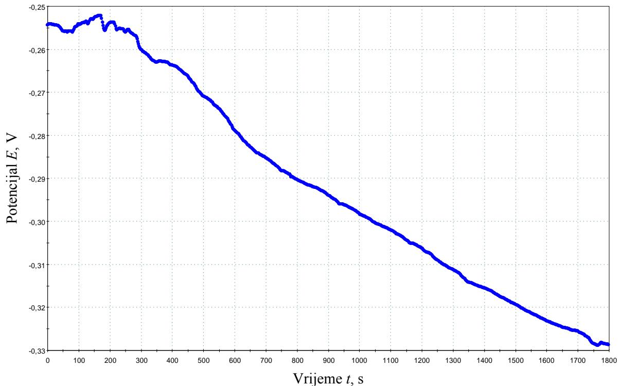
**Slika 5.16.** Zavisnost potencijala kod otvorenog strujnog kruga od vremena za uzorak X20Cr13 tokaren uz hlađenje emulzijom (3,5 %-tna vodena otopina NaCl na 25 °C)
