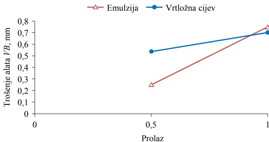
**Slika 5.40.** Trošenje alata u pokusu 8 ( $v_c = 270 \text{ m/min}$ ,  $f = 0,4 \text{ mm/o}$  i  $a_p = 0,5 \text{ mm}$ )
