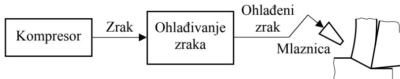
**Slika 3.7.** Sustav ohlađenog komprimiranog zraka
