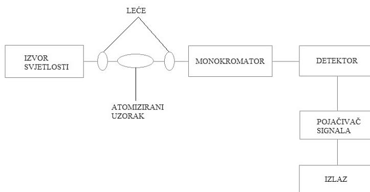
Slika 4.8.1 Shematski prikaz dijelova AAS uređaja
