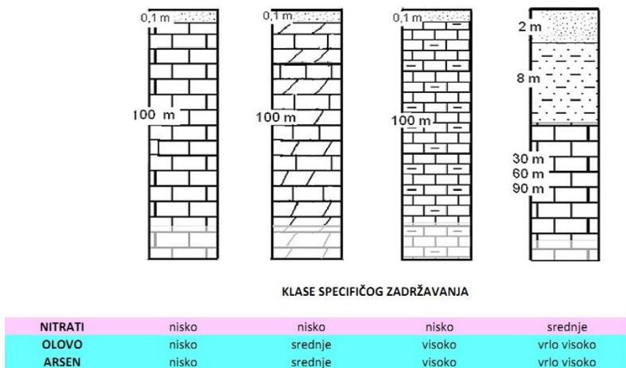
Slika 7.4.14. Prikaz klasa specifičnog onečišćenja za pojedine vrste onečišćenja ovisno o tipovima pokrovnih naslaga
