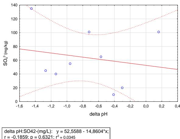
Slika 7.2.20. Dijagram odnosa koncentracija sulfata mjerene u vodenim eluatima i  $\Delta pH$  vrijednosti u uzorcima 1. profila.
