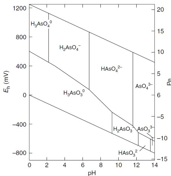
Slika 6.5.1. Eh-pH dijagram arsenskih vrsta u sustavu  $\text{As}-\text{O}_2-\text{H}_2\text{O}$  na  $25^\circ\text{C}$  i  $p=1\text{bar}$  (Hooda, 2010).
