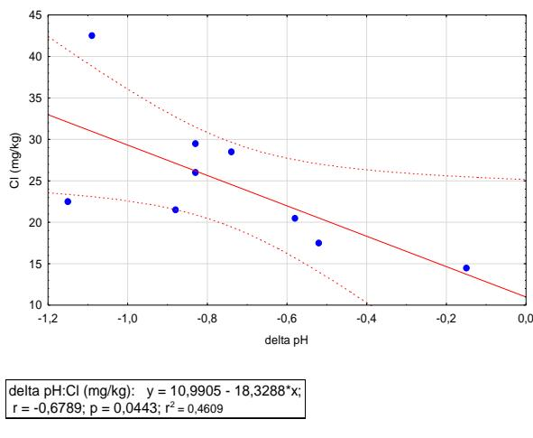
Slika 7.2.21. Dijagram odnosa koncentracija klorida mjerene u vodenim eluatima i  $\Delta\text{pH}$  vrijednosti u uzorcima 2. profila.
