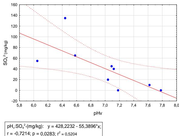
Slika 7.2.19. Dijagram odnosa koncentracija sulfata mjerene u vodenim eluatima i pH vrijednosti u uzorcima 1. profila.
