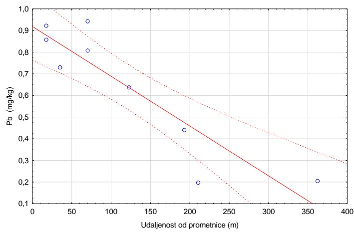
Slika 7.2.124. Dijagram rasipanja olova u ovisnosti o udaljenosti od prometnice (autocesta)
