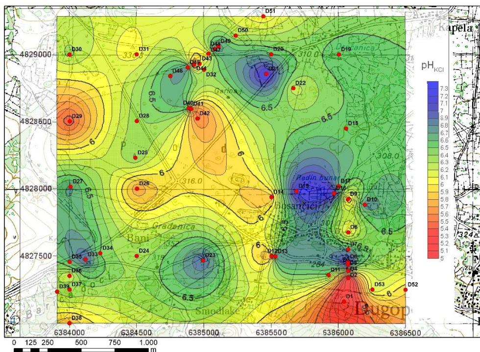
Slika 7.2.6.  $\text{pH}_{\text{KCl}}$  vrijednost tla u 1. horizontu (0-20cm)
