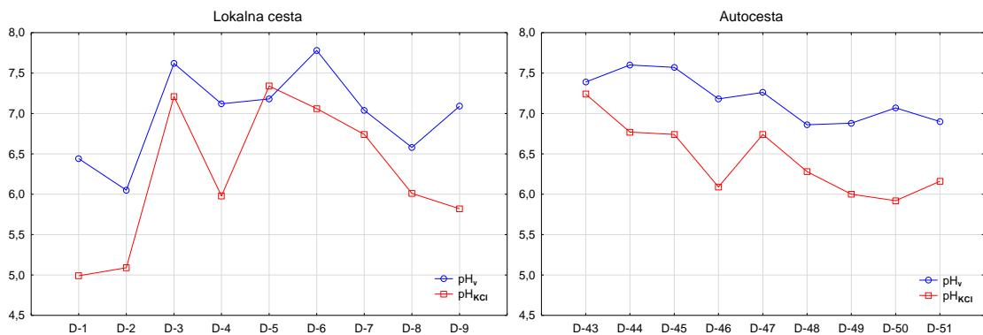
Slika 7.2.8. Vrijednosti  $\text{pH}_v$  i  $\text{pH}_{\text{KCl}}$  za 1. i 2. profil u 1. horizontu (0-20cm)
