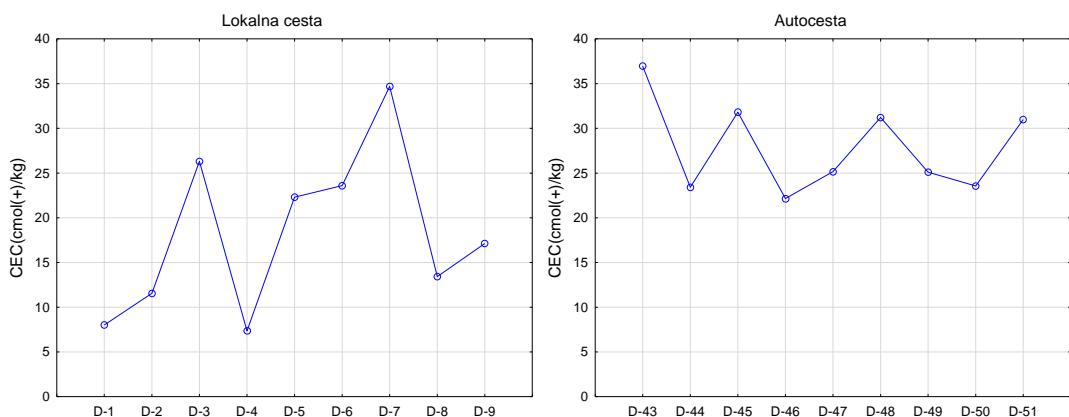
Slika 7.2.23. Kapacitet kationske zamjene – 1. i 2. profil
