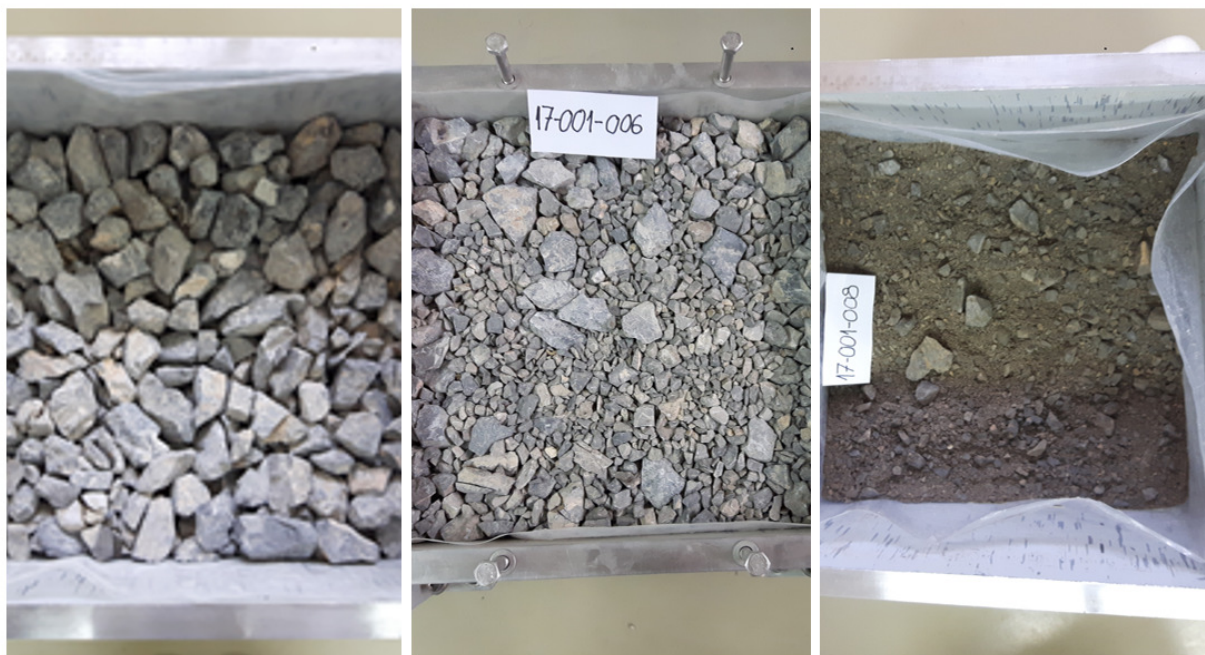
Slika 4-3 Materijal korišten u ispitivanju A16/31,5, B4/31,5 i C0/31,5
