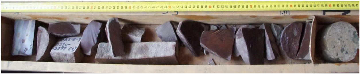
Slika 5.24: Kal-1Z J-3, fragmenti hematitiziranog muljnjaka i pješčenjaka iz 1. m jezgre te fragment tufa iz 2. m jezgre
