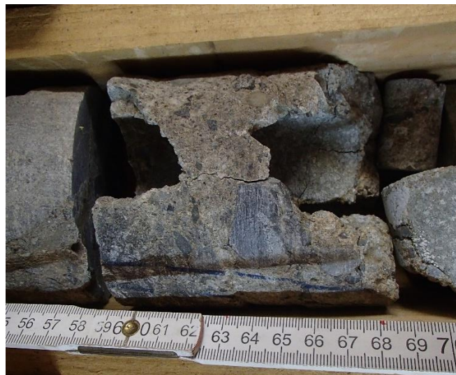
Slika 5.42: Kal-7 J-3, fragment polimiktnog konglomerata iz 2. m jezgre
