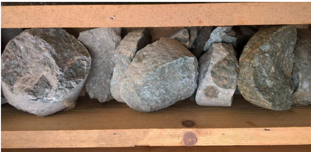
Slika 5.68: DB-1, J-8, fragmenti vitroklastičnog tufa iz 1. m jezgre
