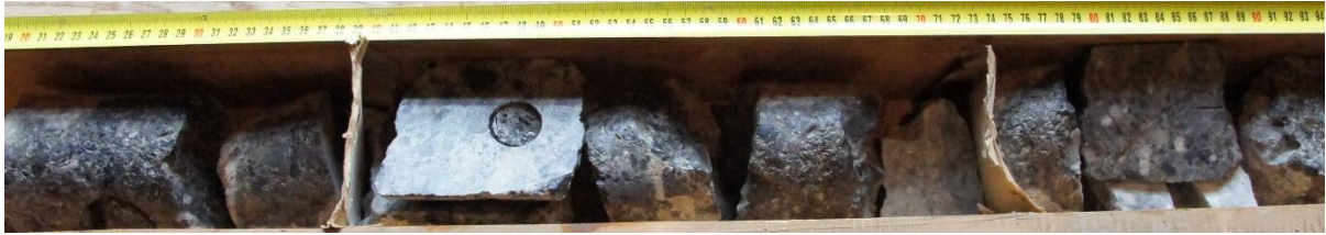
Slika 5.36: Kal-4 J-3, ostaci fragmenata polimiktnog konglomerata i breče iz 1., 2. i 3. m jezgre
