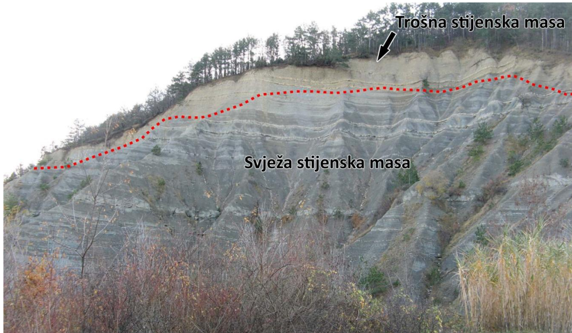
Slika 147 – Zone trošenja u IG jedinici tri na ogolini tipa 1 (lokacija – Sv. Donat)
