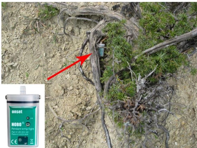
Slika 46 – Uređaj za mjerenje temperature zraka postavljen na terenu
