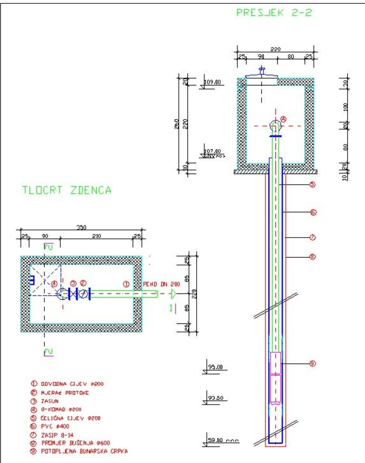
Slika 3.44: Shematski prikaz izvedbe zdenca Interventnog crpnog sustava
