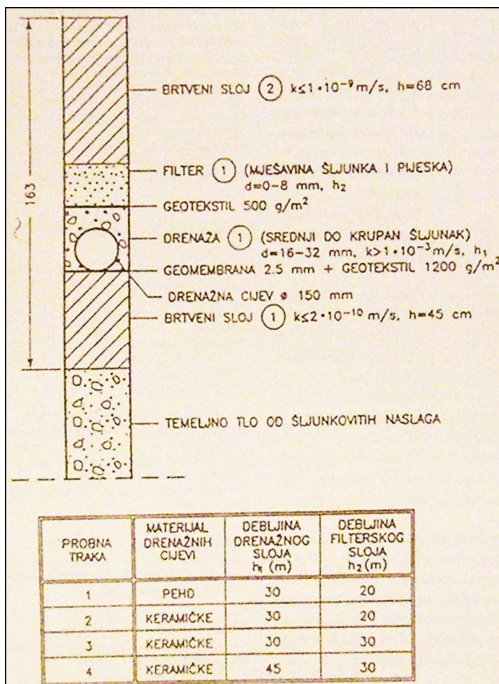
*Slika 3.36: Poprečni presjek pokusnog polja (Drnjević, Horvat, 1995.)*
