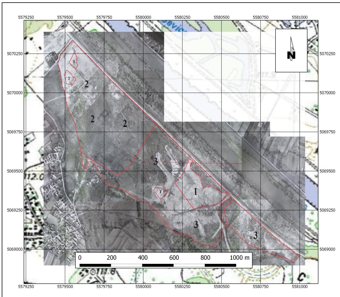
**Slika 3.7:** Prikaz širenja odlagališta otpada Jakuševac od 1965. do 1995. godine, prema (ZGO & GEOSAT, 1996.) na assamblage-u aviosnimaka (GEOSAT, 1995.) 1 otpad odložen u razdoblju od 1968. do 1977., 2 otpad odložen u razdoblju od 1977. do 1981. i 3 otpad odložen u razdoblju od 1981. do 1995. godine.
