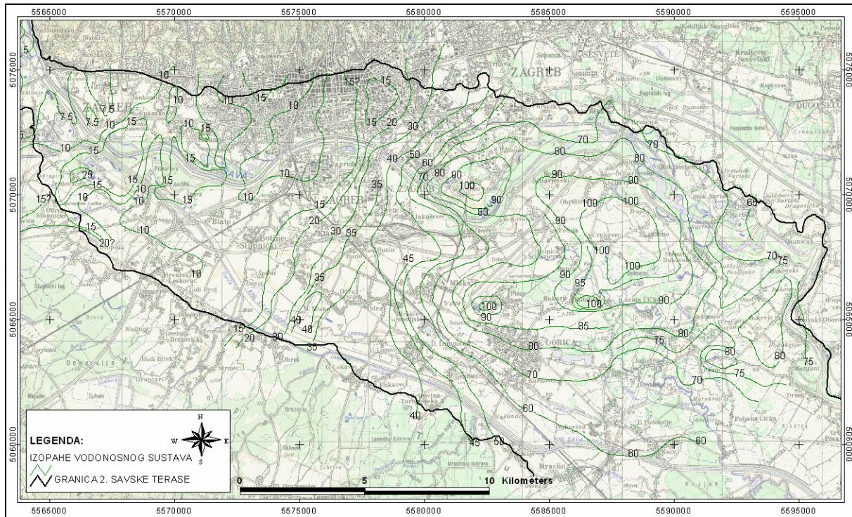
**Slika 2.8:** Izopah vodonosnog sustava (preuzeto iz Bačani, Posavec, 2009.)
