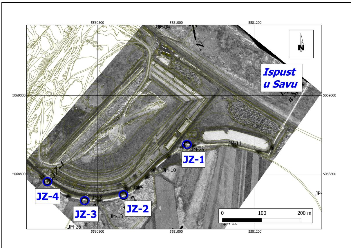
*Slika 3.43: Položaj zdenaca interventnog crpnog sustava (JZ-1, JZ-2, JZ-3 i JZ-4) na jugoistočnom dijelu odlagališta otpada Jakuševec (Modificirano prema Bagarić, 2002.)*
