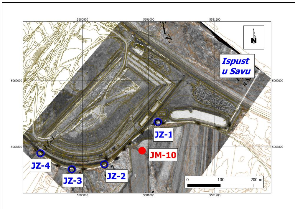
**Slika 4.35:** Situacijska karta zdenaca Interventnog crpnog sustava s najblizim nizvodnim piezometrom JM-10
