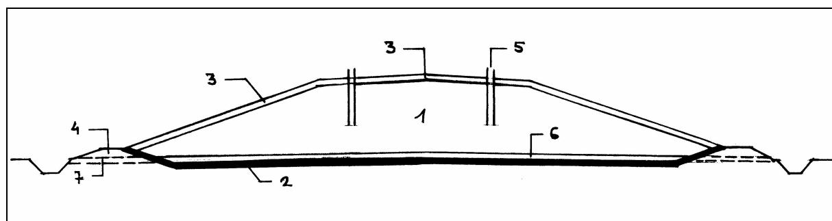
*Slika 3.40: Shematski prikaz profila saniranog odlagališta Jakuševec: 1. Otpad, 2. Donji brtveni sloj, 3. Pokrovni sloj, 4. Obodni nasip, 5. Bušotine za otplinjavanje, 6. Drenažni tepih (plošni dren), 7. Odvod vode iz plošnog drena (Ivšić, 2010.)*
