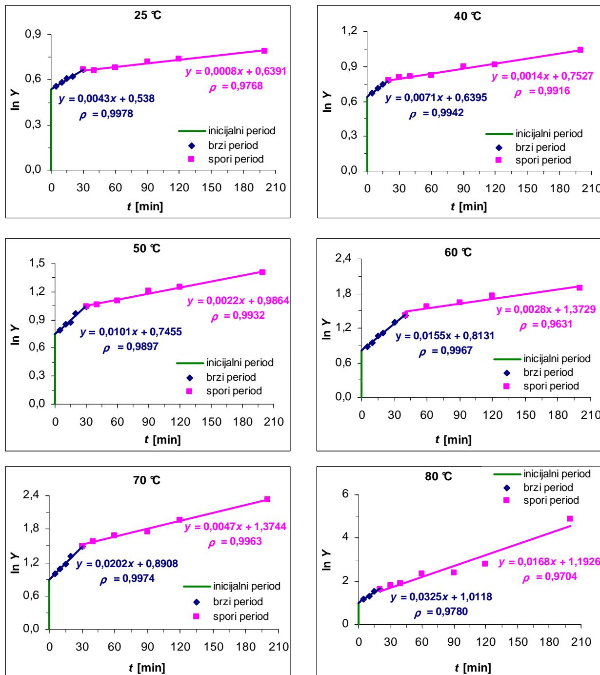
Slika 4.15. Dijagrami ovisnosti  $\ln Y$  (bezdimenzionalna koncentracija fenolnih tvari) o vremenu ( $t$ ) ekstrakcije za različite temperature ekstrakcije: inicijalni, brzi i spori period ekstrakcije ukupnih fenolnih tvari iz sjemenki grožđa FS\_05 sa 50%-tним etanolom u vodenoj kupelji
