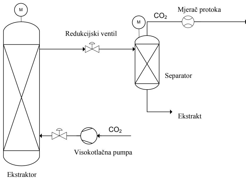
**Slika 3.5.** Shematski prikaz procesa ekstrakcije sa superkritičnim fluidima
