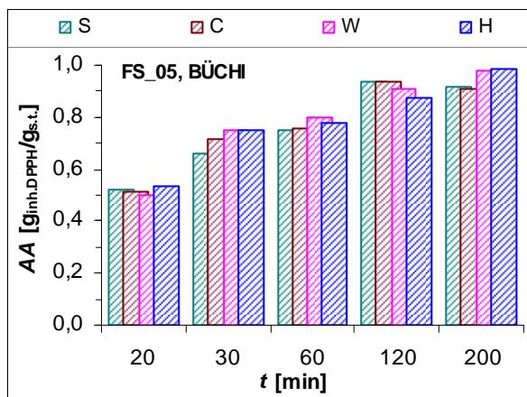
**Slika 4.44.** Antioksidacijska aktivnost (AA) ekstrakata sjemenki grožđa FS\_05 dobivenih tijekom 20-200 minuta ekstrakcije različitim metodama univerzalnog sustava za ekstrakciju: Soxhlet standard (S), kontinuirana ekstrakcija (C), Soxhlet topli (W) i vruća ekstrakcija (H) pomoći 50%-tnog etanola
