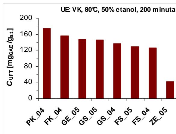
*Slika 5.2.* Maseni udio ukupnih fenolnih tvari ( $C_{UFT}$ ) ekstrakata različitih uzoraka (sorti) sjemenki grožđa dobivenih pomoću 50%-tnog etanola pri temperaturi ekstrakcije 80 °C tijekom 200 minuta
