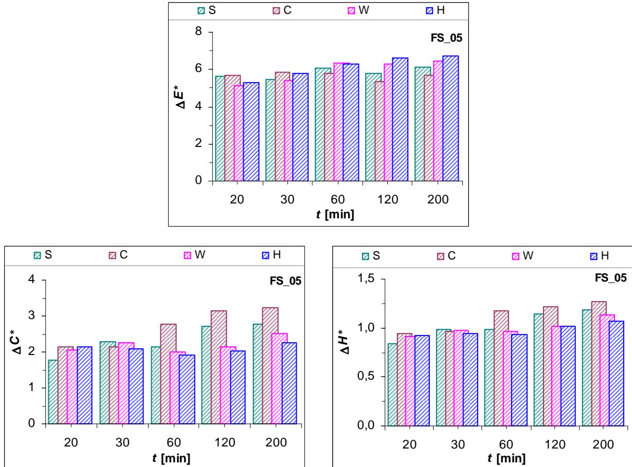
**Slika 4.40.** Ukupna promjena boje ( $\Delta E^*$ ), promjena zasićenja (kromatičnosti) boje ( $\Delta C^*$ ) i promjena tona boje ( $\Delta H^*$ ) ekstrakta sjemenki grožđa FS\_05 dobivenih 50%-nim etanolom u ovisnosti o vremenu ekstrakcije za različite načine ekstrakcije univerzalnog sustava za ekstrakciju Büchi (S - Soxhlet standard, C – kontinuirana ekstrakcija, W – Soxhlet topli, H - vruća ekstrakcija)
