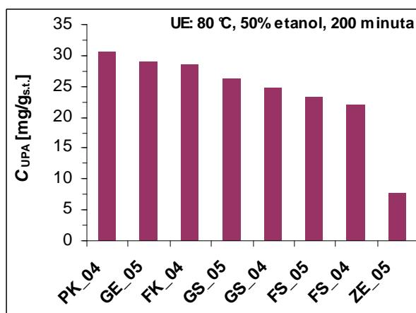
*Slika 4.29.* Maseni udio ukupnih proantocijanidina ( $C_{UPA}$ ) različitih uzoraka (sorti) sjemenki grožđa ekstrahiranih pomoću 50%-tnog etanola pri temperaturi ekstrakcije 80 °C tijekom 200 minuta pomoću vodene kupelji
