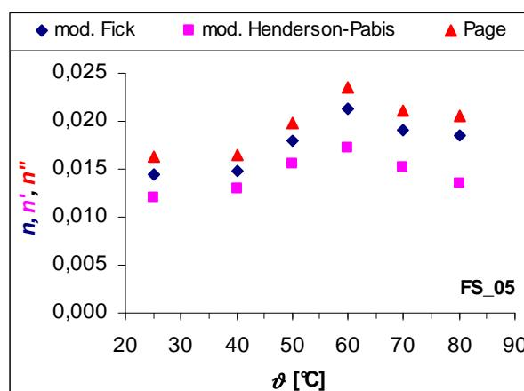
**Slika 4.10.** Utjecaj temperature ( $\vartheta$ ) ekstrakcije na bezdimenzionalne ( $n$ ,  $n'$ ,  $n''$ ) parametre svih primjenjenih eksponencijalnih modela
