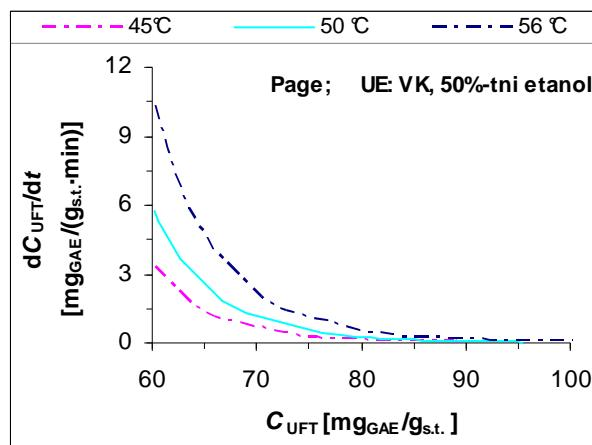
**Slika 4.14.** Ovisnost brzine ekstrakcije ukupnih fenolnih tvari ( $dC_{UFT}/dt$ ) iz sjemenki grožđa FS\_05 o masenom udjelu ukupnih fenolnih tvari ( $C_{UFT}$ ) za različite temperature (simulacijske krivulje prema Pageovu modelu: isprekidane linije - proizvoljno odabrane temperature, puna linija - temperatura na kojoj je provedena ekstrakcija )
