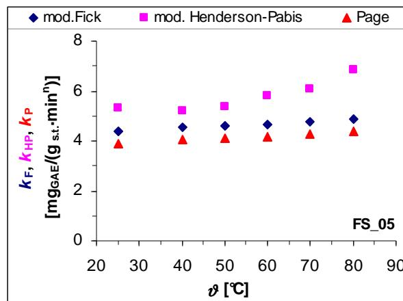
**Slika 4.8.** Utjecaj temperature ( $\vartheta$ ) ekstrakcije na parametre svih primjenjenih eksponencijalnih modela ( $k_F$ ,  $k_{HP}$ ,  $k_P$ ), koji u sebi sadrže dimenziju vremena
