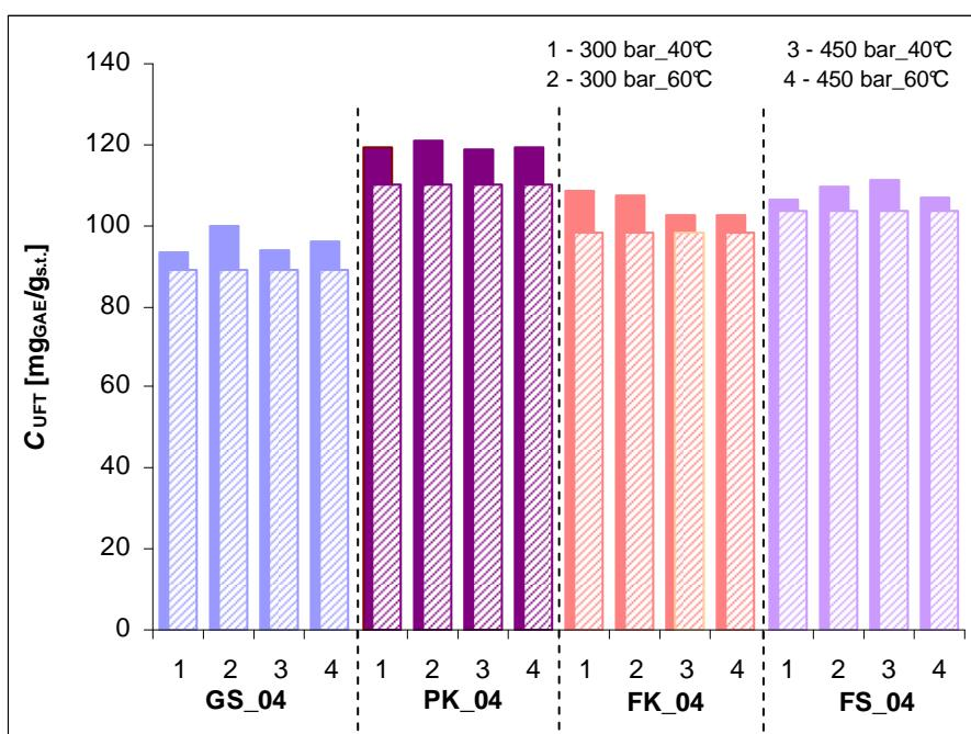
**Slika 4.35.** Maseni udio ukupnih fenolnih tvari ( $C_{UFT}$ ) u ekstraktima (kruto-tekuća ekstrakcija: 50%-tni etanol, 80 °C, 200 minuta) različitih uzoraka sjemenki grožđa prije (stupci s uzorkom) i nakon superkritične ekstrakcije - SCFE (obojeni stupci)
