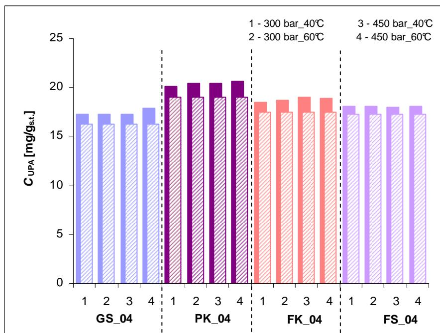
**Slika 4.36.** Maseni udio ukupnih proantocijanidina ( $C_{UPA}$ ) u ekstraktima (kruto-tekuća ekstrakcija: 50% etanol, 80 °C, 200 minuta) različitih uzoraka sjemenki grožđa prije (stupci s uzorkom) i nakon superkritične ekstrakcije - SCFE (obojeni stupci)
