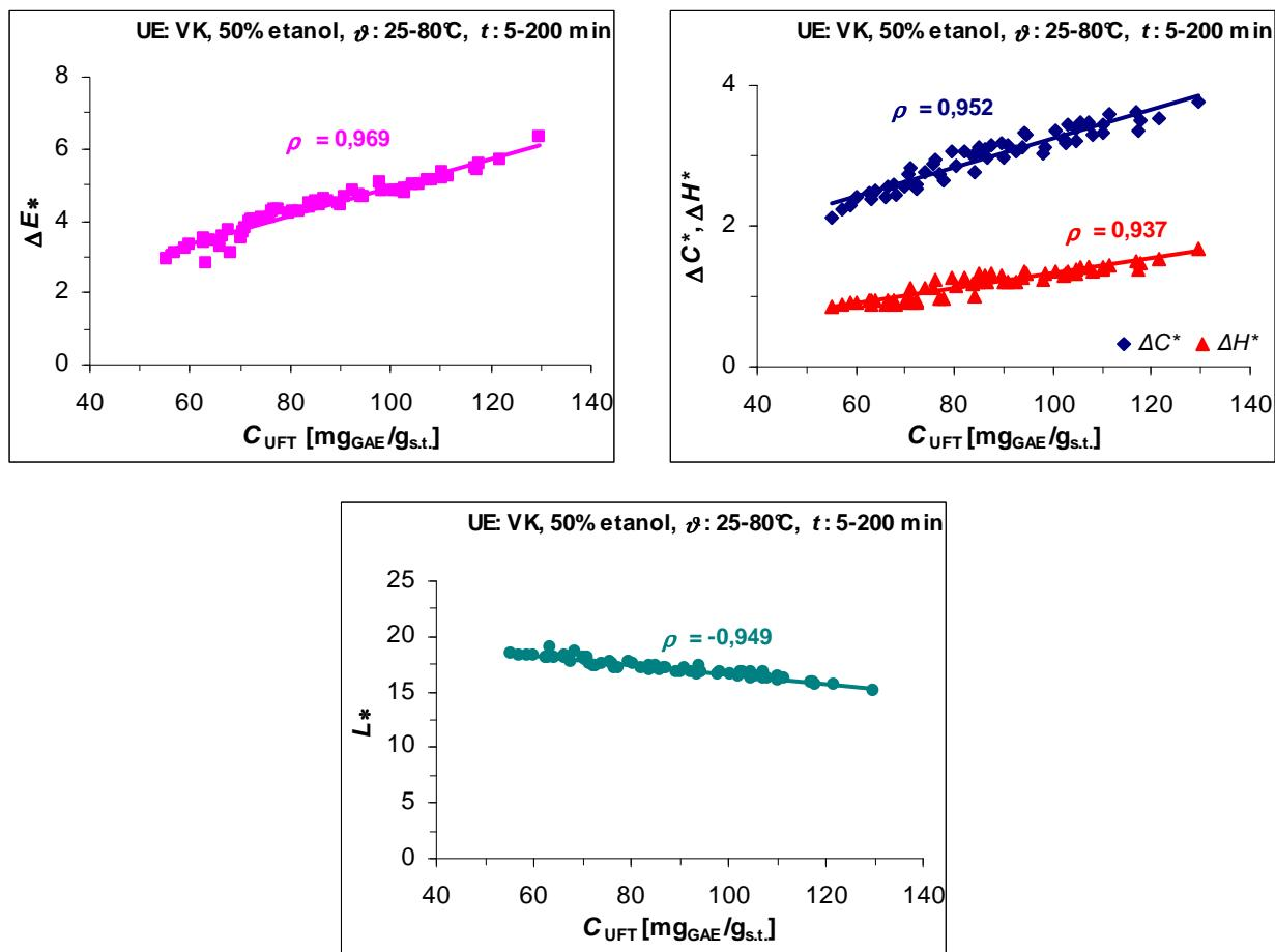
**Slika 4.38.** Ovisnost ukupne promjene boje ( $\Delta E^*$ ), promjene kromatičnosti ( $\Delta C^*$ ) i promjene tona boje ( $\Delta H^*$ ) te svjetline ( $L^*$ ) ekstrakata sjemenki grožđa FS\_05 o masenom udjelu ukupnih fenolnih tvari -  $C_{UFT}$  (podaci za ekstrakte dobivene ekstrakcijom, pomoću 50%-tnog etanola pri različitim temperaturama ( $\vartheta$ ) i vremenu ekstrakcije ( $t$ ), uz korištenje vodene kupelji-VK)
