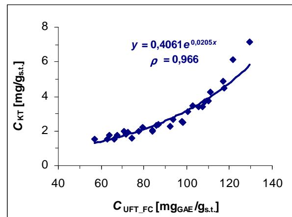
Slika 4.19. Korelacija masenog udjela (+)-catehina ( $C_{KT}$ ) određenog HPLC-om i masenog udjela ukupnih fenolnih tvari određenog spektrofotometrijski ( $C_{UFT\_FC}$ ) u ekstraktima dobivenim pri različitom vremenu (10, 30, 60, 120, 200 minuta) i temperaturi ekstrakcije (25 – 80 °C)
