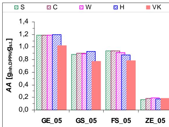
**Slika 4.45.** Antioksidacijska aktivnost (AA) ekstrakata različitih uzoraka (sorti) sjemenki grožđa dobivenih različitim metodama univerzalnog sustava za ekstrakciju: Soxhlet standard (S), kontinuirana ekstrakcija (C), Soxhlet topli (W), vruća ekstrakcija (H) i ekstrakcijom pomoću vodene kupelji (VK) tijekom 120 minuta; ekstrakcija provedena 50%-tним etanolom
