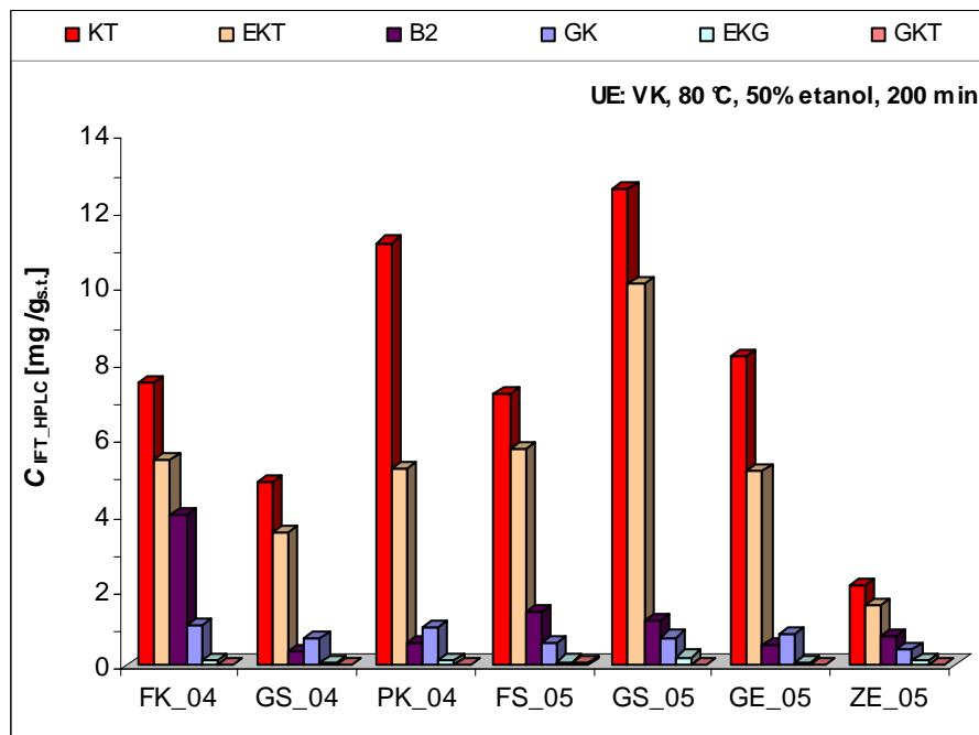
**Slika 5.3.** Maseni udio individualnih fenolnih tvari ( $C_{IFT\_HPLC}$ ) u ekstraktima različitih uzorka sjemenki grožđa dobivenih ekstrakcijom u vodenoj kupelji pomoću 50%-tnog etanola, tijekom 200 minuta pri temperaturi 80 °C
