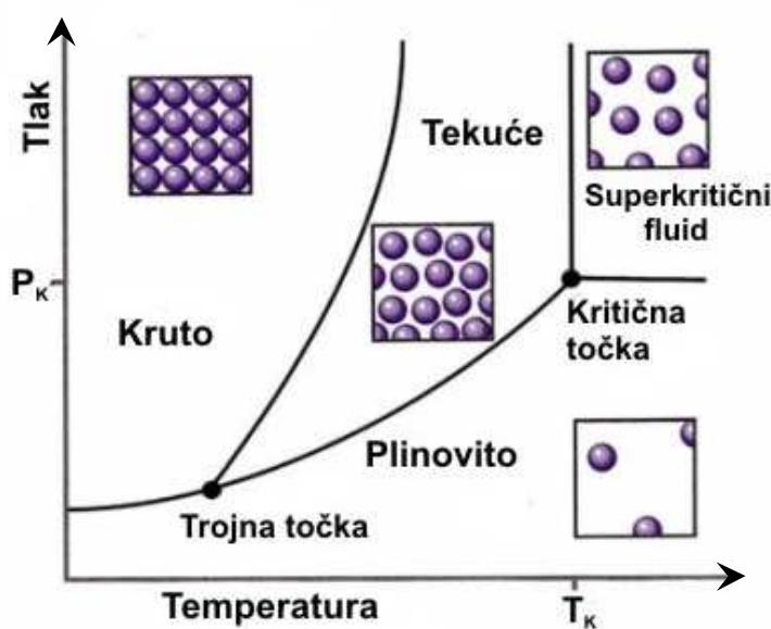
*Slika 2.2.* Fazni dijagram (tlak – temperaturna) za čistu komponentu
