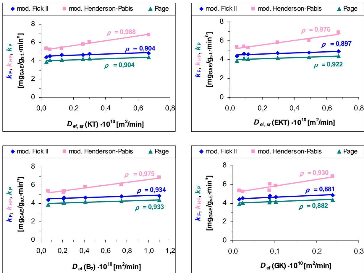
**Slika 4.26.** Slaganje vrijednosti efektivnih koeficijenata difuzije ( $D_{\text{ef}}$ ) (+)-catehina (KT), (-)-epikatehina (EKT), procijanidina B<sub>2</sub> i galne kiseline (GK) iz sjemenki grožđa FS\_05 s procijenjenim konstantama ( $k_F, k_{HP}, k_P$ ) matematičkih modela
