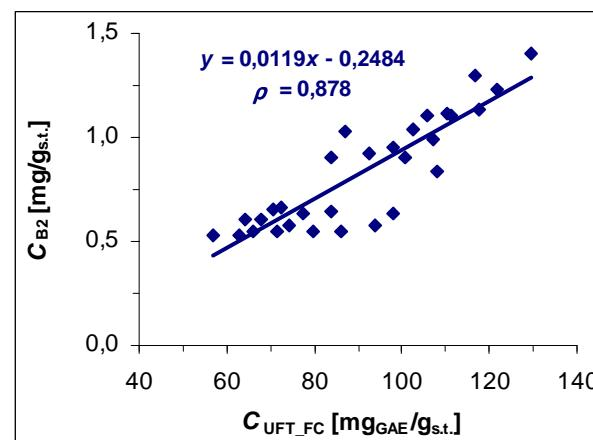
Slika 4.23. Korelacija masenog udjela procijanidina B<sub>2</sub> ( $C_{B2}$ ) određenog HPLC-om i masenog udjela ukupnih fenolnih tvari određenog spektrofotometrijski ( $C_{UFT\_FC}$ ) u ekstraktima dobivenim pri različitom vremenu (10, 30, 60, 120, 200 minuta) i temperaturi ekstrakcije (25 – 80 °C)
