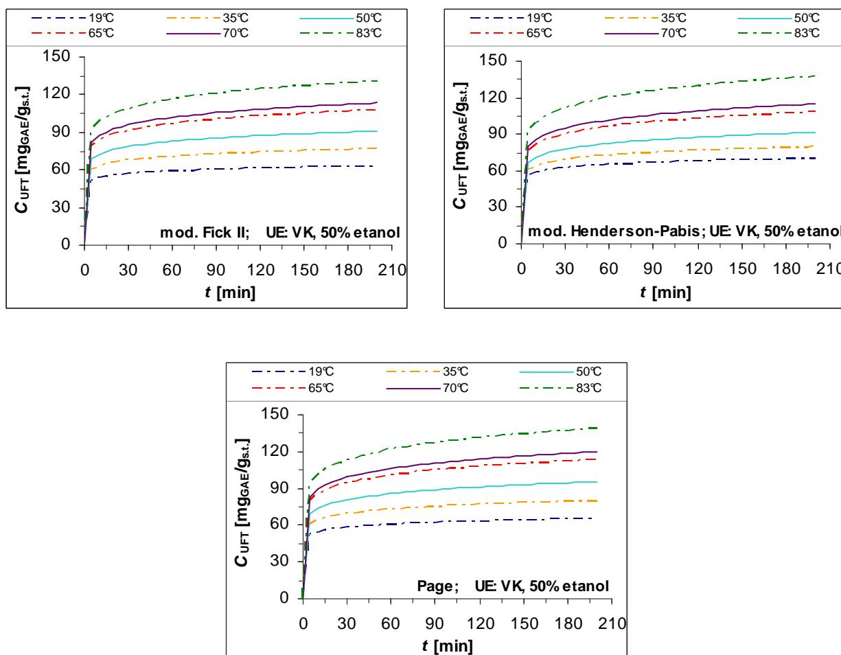
**Slika 4.12.** Ovisnost masenog udjela ukupnih fenolnih tvari ( $C_{UFT}$ ) ekstrahiranih iz sjemenki grožđa FS\_05 o vremenu ( $t$ ) ekstrakcije za različite temperature (simulacijske krivulje prema primjenjenim eksponencijalnim modelima: isprekidane linije - proizvoljno odabrane temperature, pune linije - temperature na kojima je provedena ekstrakcija)
