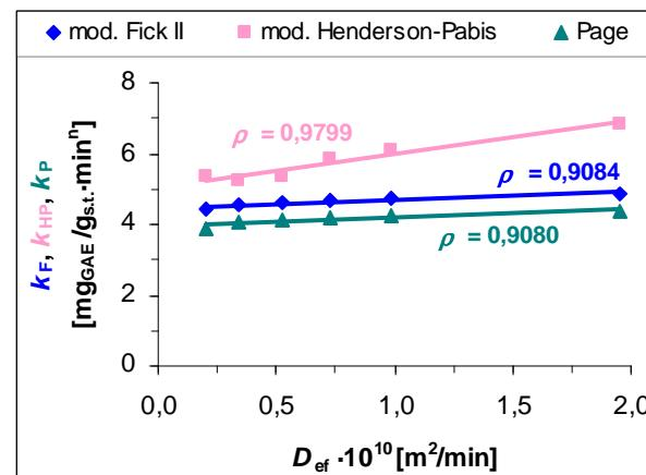
**Slika 4.17.** Slaganje prosječnih vrijednosti  $D_{\text{ef}}$ , za spori i brzi period ekstrakcije fenolnih tvari iz sjemenki grožđa FS\_05, sa procijenjenim konstantama matematičkih modela
