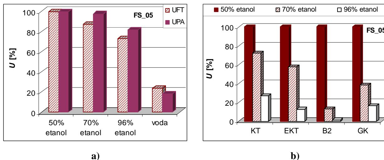
*Slika 5.1.* Učinkovitost ( $U$ , %) različitih otapala u ekstrakciji (a) ukupnih fenolnih tvari (UFT) i ukupnih proantocijanidina (UPA) te (b) individualnih fenolnih tvari iz sjemenki grožđa FS\_05 pri temperaturi  $80^{\circ}\text{C}$  i omjeru kruto tekuće  $40 \text{ mL/g}$  tijekom 200 minuta ekstrakcije
