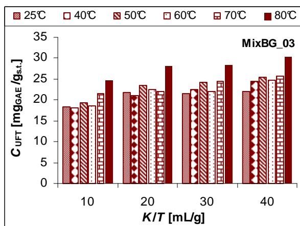
**Slika 4.3.** Ekstraktibilnost ukupnih fenolnih tvari (UFT) iz neklasiranih usitnjenih sjemenki grožđa MixBG\_03 uz korištenje 50%-tnog etanola pri različitim omjerima kruto-tekuće ( $K/T$ ) i različitim temperaturama ekstrakcije tijekom 120 minuta
