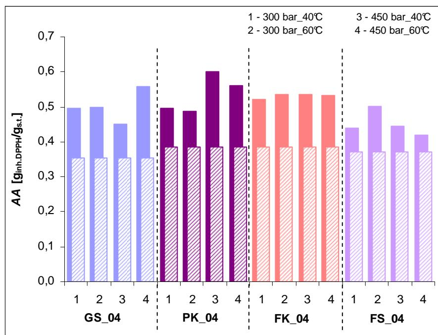
**Slika 4.46.** Antioksidacijska aktivnost (AA) ekstrakata dobivenih kruto-tekućom ekstrakcijom (50%-tni etanol, 80 °C, 200 minuta, vodena kupelj) iz različitih uzoraka sjemenki grožđa prije (stupci s uzorkom) i nakon superkritične ekstrakcije - SCFE (obojani stupci)
