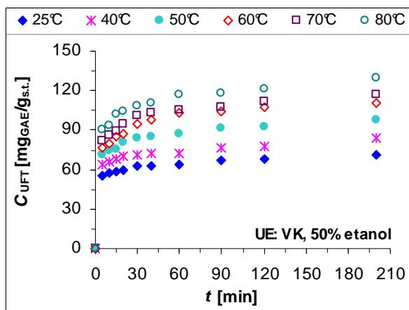
**Slika 4.5.** Ovisnost masenog udjela ukupnih fenolnih tvari ( $C_{UFT}$ ) u ekstraktima sjemenki grožđa FS\_05 o vremenu ( $t$ ) kruto-tekuće ekstrakcije za različite temperature ekstrakcije (eksperimentalni podaci)
