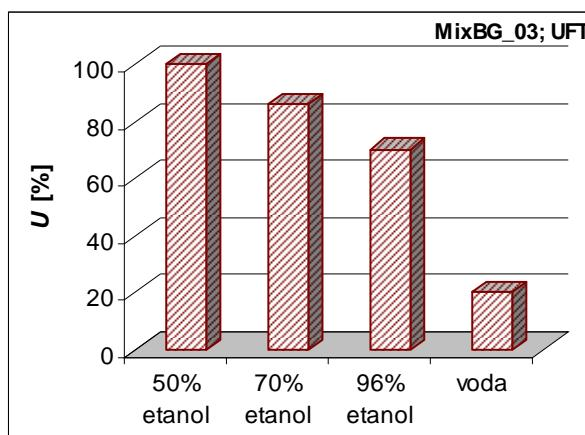
**Slika 4.2.** Učinkovitost ( $U$ , %) različitih otapala u ekstrakciji ukupnih fenolnih tvari (UFT) ekstrahiranih pri temperaturi 80 °C i omjeru kruto-tekuće 40 mL/g iz usitnjenih i neklasiranih sjemenki grožđa MixBG\_03 nakon 120 minuta ekstrakcije
