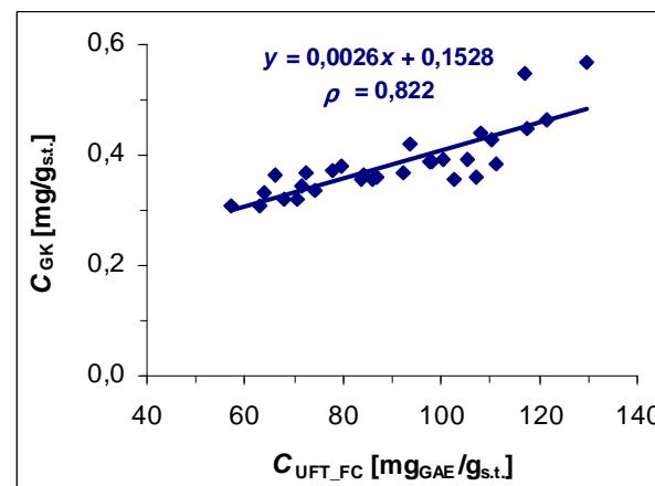
Slika 4.25. Korelacija masenog udjela galne kiseline ( $C_{GK}$ ) određene HPLC-om i masenog udjela ukupnih fenolnih tvari određenog spektrofotometrijski ( $C_{UFT\_FC}$ ) u ekstraktima dobivenim pri različitom vremenu (10, 30, 60, 120, 200 minuta) i temperaturi ekstrakcije (25 – 80 °C)
