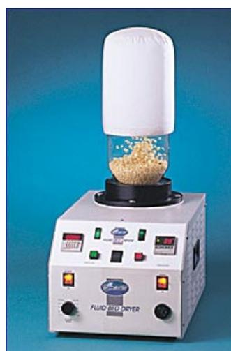
*Slika 3.2* Prikaz konvekcijskog sušionika s fluidizacijom
