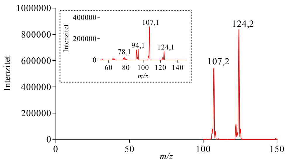
Slika 18. TIC spoja CMP (umetak: produkt ioni nastali cijepanjem signala kod  $m/z$  124 asigniranog kao  $[\text{C}_7\text{H}_{10}\text{NO}]^+$ ); otapalo MeOH sa 0,1 % HCOOH, napon fragmentora 135 V, energija sudara 25 eV;  $c(\text{CMP}) = 100 \mu\text{mol mL}^{-1}$
