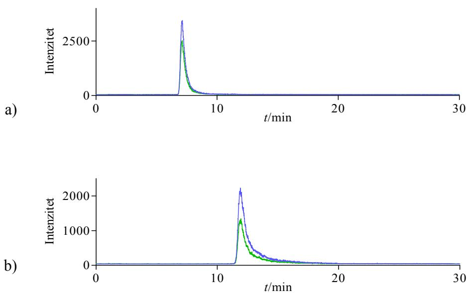
Slika 21. Kromatogrami višestrukih tranzicijskih reakcija  $[M]^+ \rightarrow 124$  (plavo) i  $[M]^+ \rightarrow 107$  (zeleno) NMP derivata masnih kiselina na koloni Hypersil Gold: a)  $c(C19:0) = 4,7 \cdot 10^{-5} \text{ mol L}^{-1}$ , b)  $c(C22:0) = 3,8 \cdot 10^{-5} \text{ mol L}^{-1}$ . NMP derivati masnih kiselina eluirani su upotrebom gradijenta mobilne faze prema Tablici 13.
