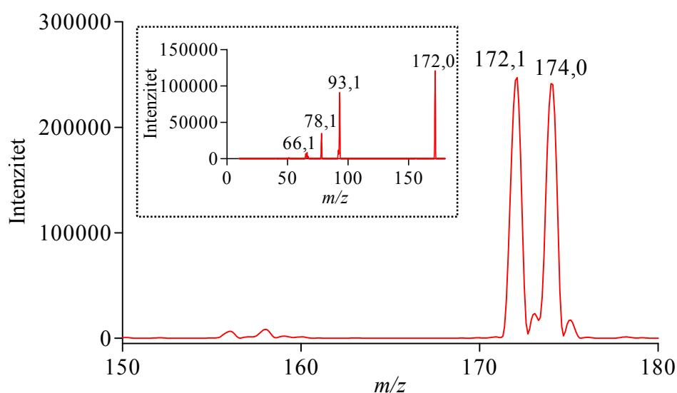
Slika 16. Kromatogram ukupne ionske struje (engl. *total* ion current, TIC) BMP (umetak: produkt ioni nastali cijepanjem  $m/z$  172,1 asigniranog kao  $[\text{C}_6\text{H}_7\text{NBr}]^+$ ); otapalo MeOH s 0,1 % HCOOH, napon fragmentora 135 V, energija sudara 20 eV;  $c(\text{BMP}) = 25 \mu\text{mol mL}^{-1}$
