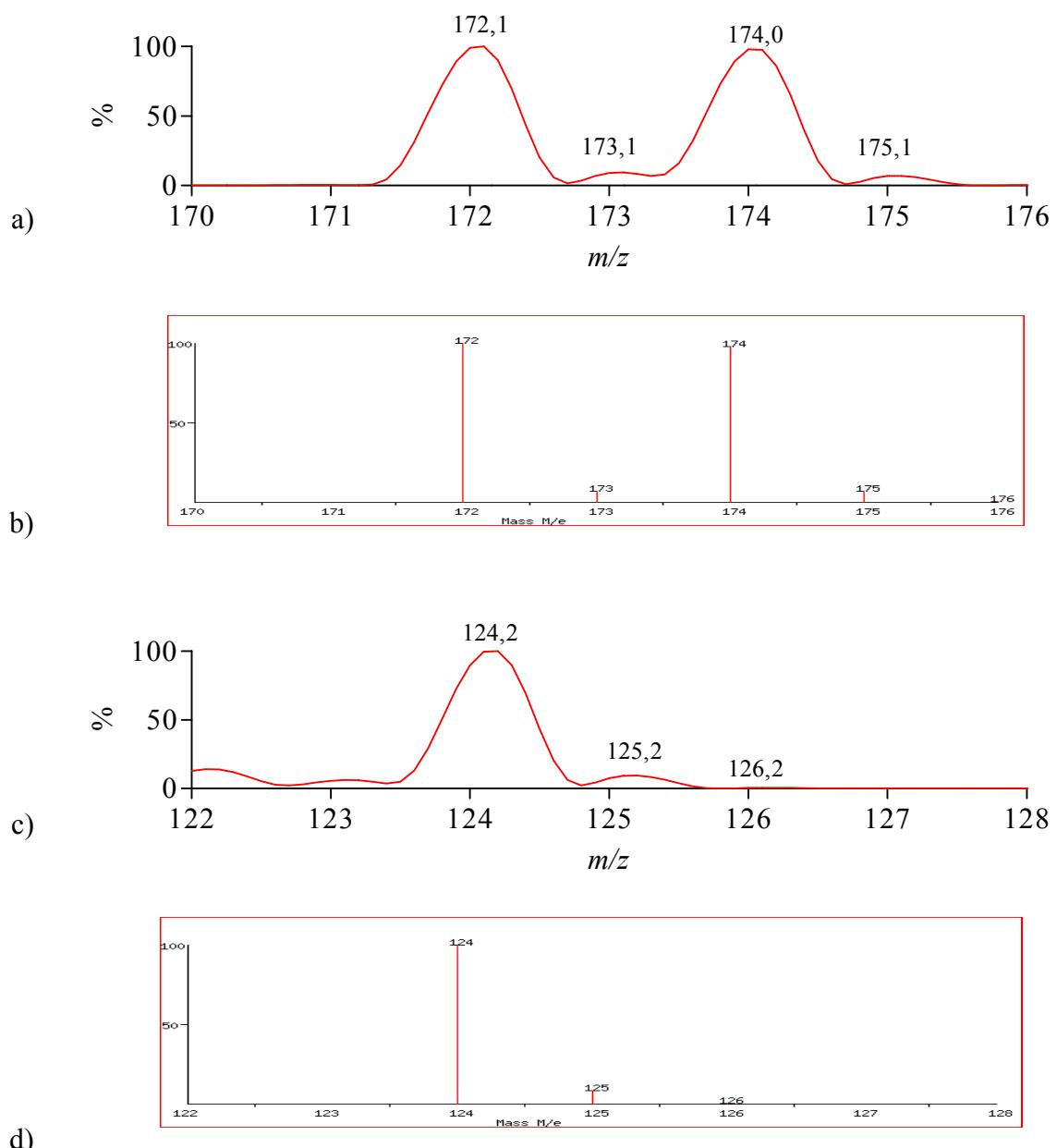
Slika 17. Izotopna distribucija molekulskog iona derivatizacijskog reagensa:  $[C_6H_7NBr]^+$  a) eksperimentalna, b) teoretska<sup>203</sup>;  $[C_7H_{10}NO]^+$  c) eksperimentalna, d) teoretska<sup>203</sup>
