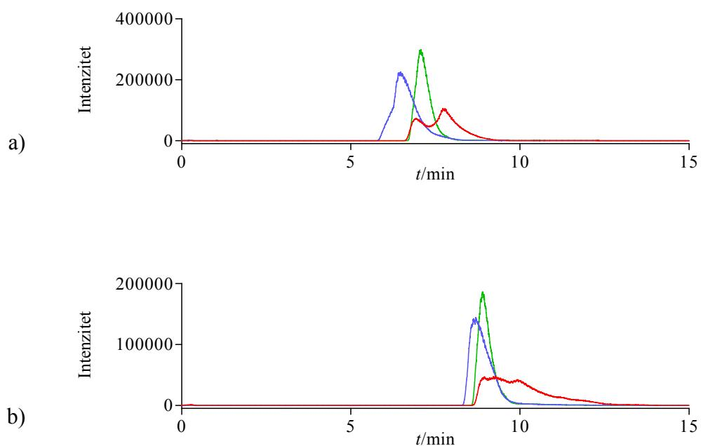
Slika 26. Utjecaj dodatka 1  $\mu\text{L}$  (zeleno), 5  $\mu\text{L}$  (plavo) i 10  $\mu\text{L}$  (crveno) TEA za derivatizaciju masnih kiselina BMP i CMP derivatizacijskim reagensima na Hypersil Gold kromatografskoj koloni: a)  $c(\text{C}16:0) = 9,6 \cdot 10^{-5} \text{ mol L}^{-1}$ , b)  $c(\text{C}18:0) = 9,8 \cdot 10^{-5} \text{ mol L}^{-1}$ . NMP derivati masnih kiselina eluirani su upotrebom gradijenta mobilne faze prema Tablici 16.
