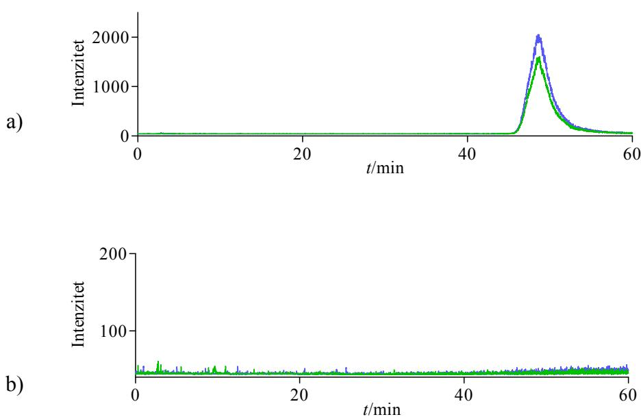
Slika 19. Kromatogrami višestrukih tranzicijskih reakcija  $[M]^+ \rightarrow 124$  (plavo) i  $[M]^+ \rightarrow 107$  (zeleno) na koloni Synergy Hydro-RP za: a)  $c(C19:0) = 2,8 \cdot 10^{-5}$  mol L $^{-1}$ , b)  $c(C22:0) = 2,4 \cdot 10^{-5}$  mol L $^{-1}$ . NMP derivati masnih kiselina eluirani su upotrebom gradijenta mobilne faze prema Tablici 11.
