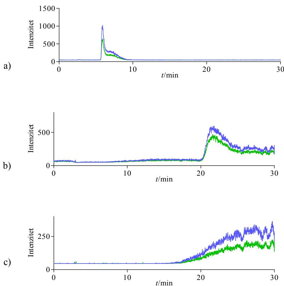
Slika 20. Kromatogrami višestrukih tranzicijskih reakcija  $[M]^+ \rightarrow 124$  (plavo) i  $[M]^+ \rightarrow 107$  (zeleno) NMP derivata masnih kiselina na koloni Zorbax-XDB: a)  $c(C12:0) = 4,1 \cdot 10^{-5}$  mol L<sup>-1</sup>, b)  $c(C19:0) = 2,8 \cdot 10^{-5}$  mol L<sup>-1</sup>, c)  $c(C22:0) = 2,4 \cdot 10^{-5}$  mol L<sup>-1</sup>. NMP derivati masnih kiselina eluirani su upotreboom gradijenta mobilne faze prema Tablici 12.
