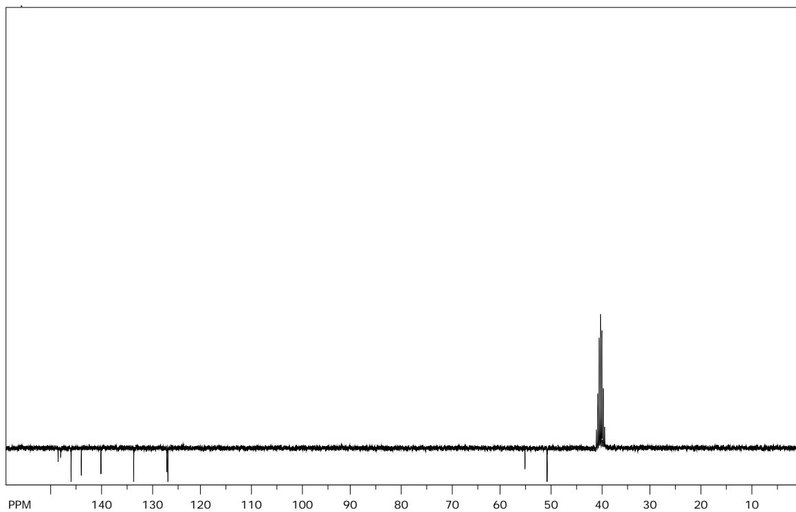
Prilog 4.  $^{13}\text{C}$  NMR spektar derivatizacijskog reagensa BMP-*d*3
