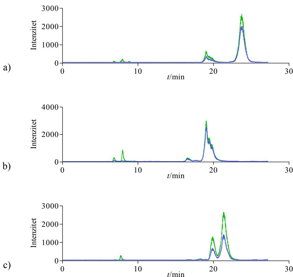
Slika 34. Kromatografski prikaz višestrukih tranzicijskih reakcija  $[M+H]^+ \rightarrow 282$  (zeleno) i  $[M+H]^+ \rightarrow [M+H-H_2O]^+$  (plavo) na kromatografskoj koloni Synergi Hydro-RP: a) ceramid III, b) ceramid IIIB i c) ceramid VI. Gradijentna eluacija mobilne faze prema Tablici 8.,  $c(\text{CER III}) = c(\text{CER IIIB}) \approx 1,7 \cdot 10^{-3} \text{ mol L}^{-1}$ ,  $c(\text{CER VI}) \approx 1,1 \cdot 10^{-3} \text{ mol L}^{-1}$
