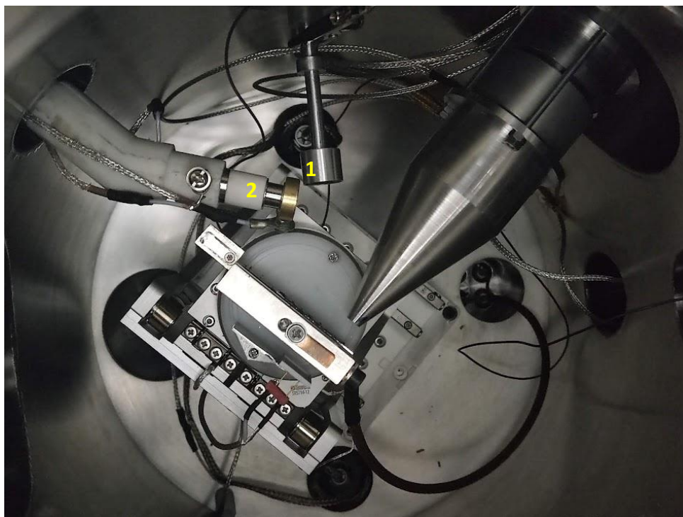
Slika 8.5: Fotografija postava s aperturom na nosaču (oznaka 1 na slici) i novom pozicijom elektronskog detektora (oznaka 2 na slici). Elektronski detektor postavljen je na teflonski nosač.
