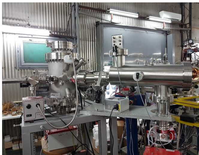
Slika 4.2: Shematski prikaz kapilarne mikroprobe za MeV TOF-SIMS s reflektornim TOF analizatorom (lijevo). Slika komore izvana (desno).
