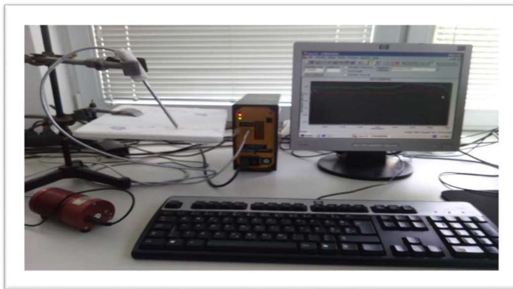
Slika 37. NIR instrument spojen na računalo sa instaliranim programom SPEC-32 (a), izvor zračenja (b) i sonda (c)
