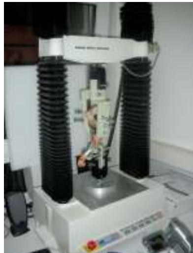
Slika 4.1. Kidalica „Universal Testing Machine“, model "TA.HD plus"
