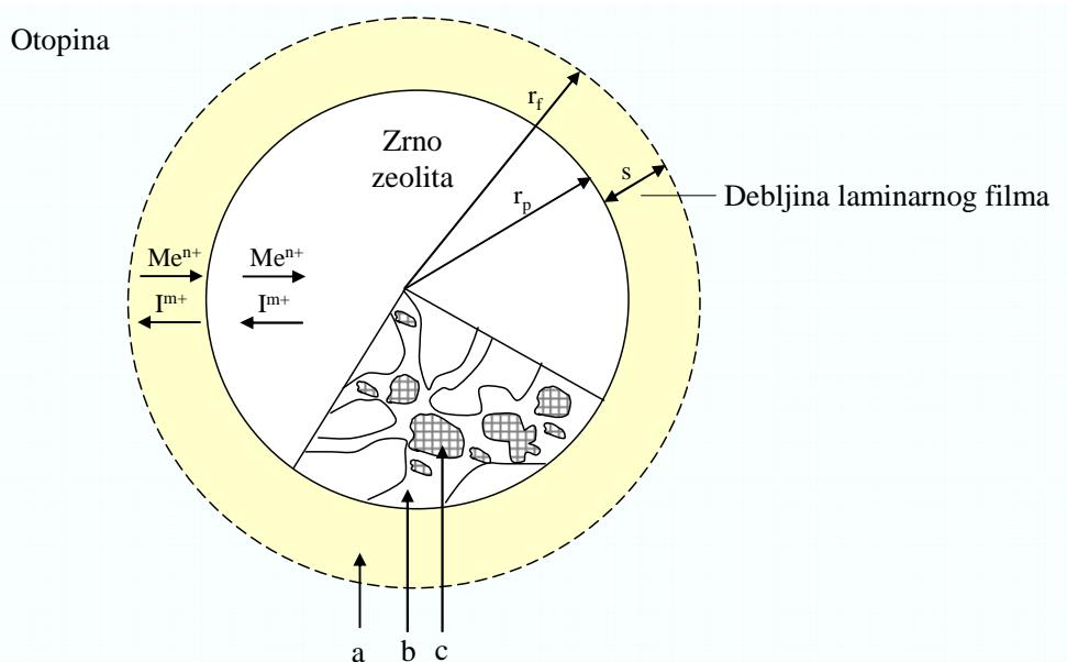
Slika 2.18. Shematski prikaz čestice zeolita s tri osnovna otpora prijenosu tvari: a) difuzija iona kroz laminarni film, b) difuzija iona od površine čestice kroz makro pore, c) difuzija iona od površine čestice kroz mikro pore.
