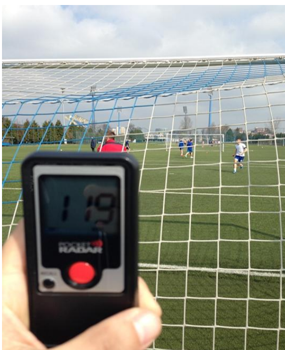
Slika 7. Pocket radar mjeri brzinu udarca u km/h
