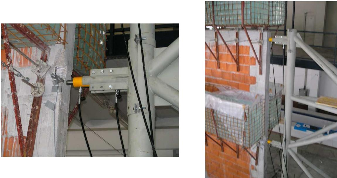
**Slika 3.10.** Prikaz položaja hidrauličkih preša
