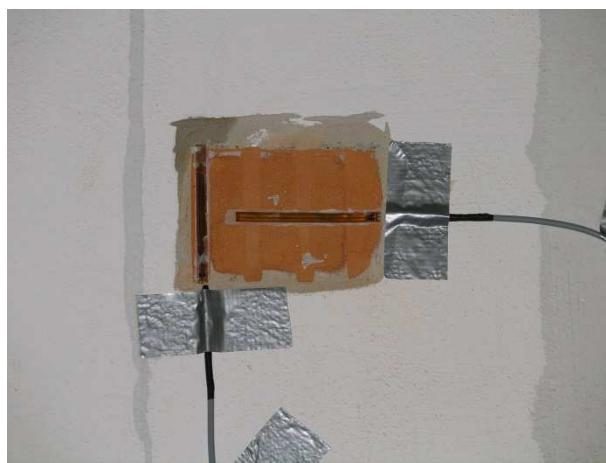
*Slika 3.12.* Prikaz zalijepljene mjerne trake na ziđe
