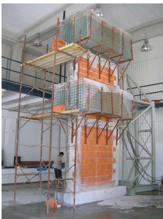
*Slika 3.4. Izgled zida MW1, MW2 prije ispitivanja*
