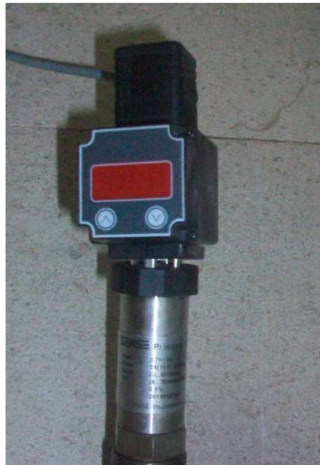
**Slika 3.9.** Senzor tlaka (manometar) za mjerjenje sile
