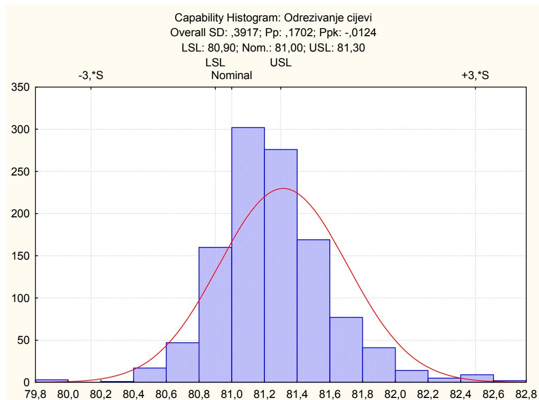
**Slika br. 5.24** - Histogram izmjerениh odreza cijevi
