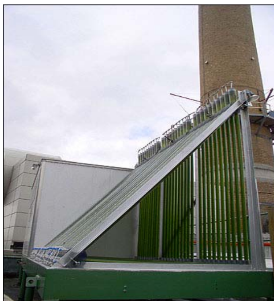
Slika 4.8. Bioreaktor za proizvodnju biodizela od algi
