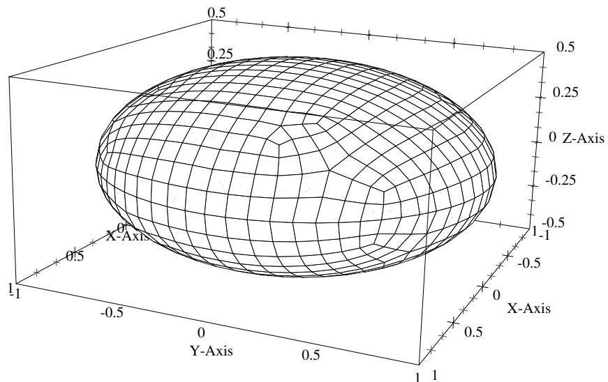
**Slika 6.6:** Površina elipsoida sa rijetkom nestrukturiranom mrežom.
