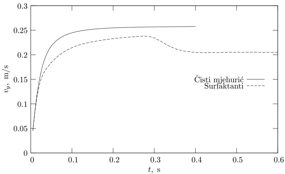
**Slika 7.12:** Brzina podizanja 2-D mjeđurića ekvivalentnog polumjera  $r_b = 0.75$  mm, za čistu slobodnu površinu i uz nazočnost molekula surfaktanta na slobodnoj površini.
