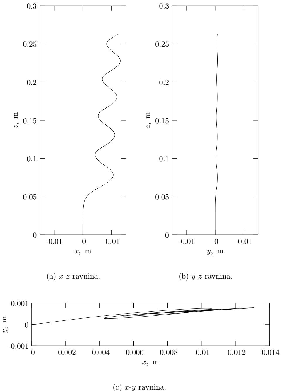
**Slika 7.15:** Putanja 3-D mjehurića polumjera  $r_b = 1 \text{ mm}$  bez prisustva surfaktanta na slobodnoj površini.
