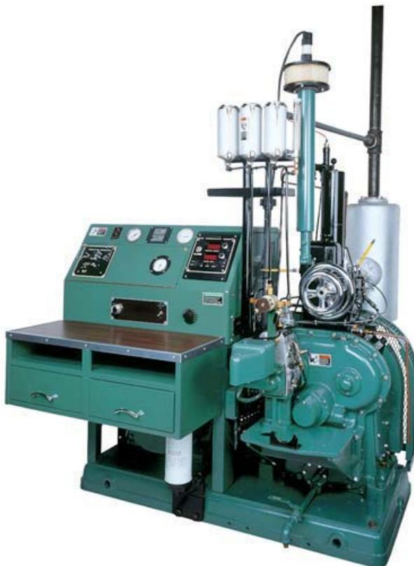
Slika 67. Aparatura za mjerjenje cetanskog broja
