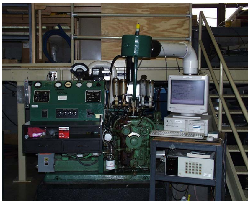
Slika 82. Aparatura za određivanje IOB-a
