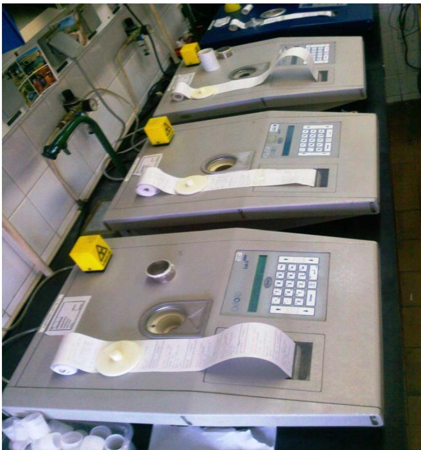
Slika 33. Aparatura za mjerjenje ukupne količine sumpora
