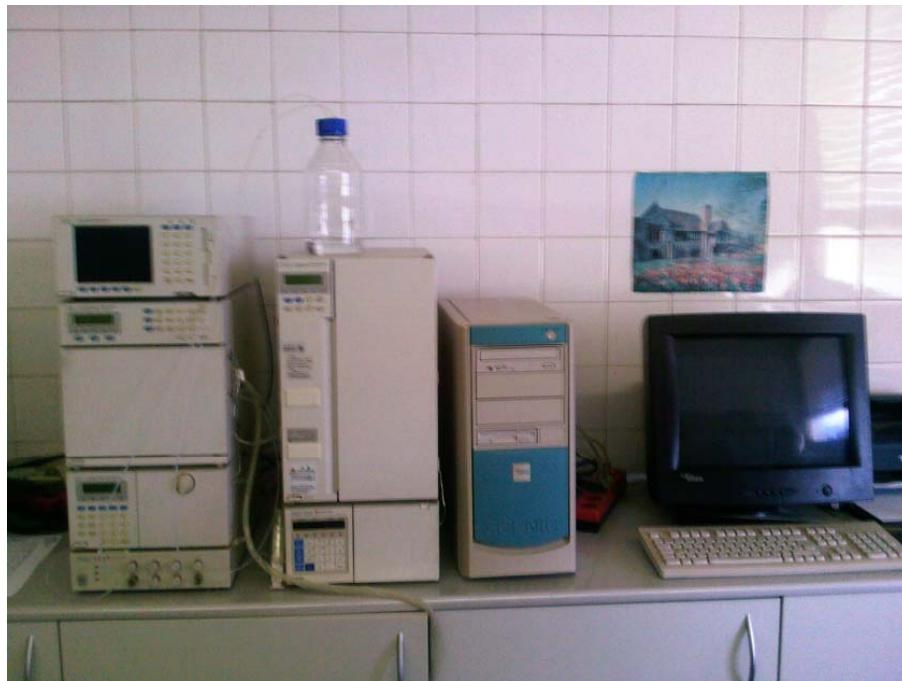
Slika 56. Aparatura za mjerjenje količine policikličkih aromatskih ugljikovodika
