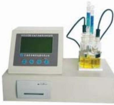
Slika 22. Aparatura za mjerjenje količine vode
