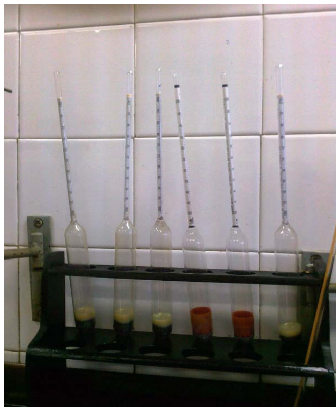
Slika 11. Areometri za mjerenje gustoće
