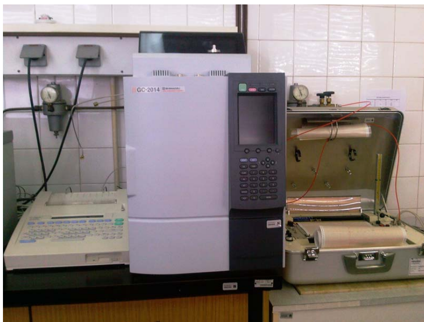
Slika 85. Aparatura za mjerenje količine benzena
