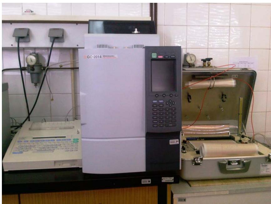
Slika 85. Aparatura za mjerjenje količine benzena
