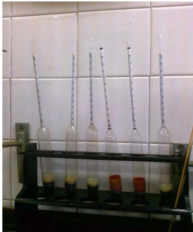
Slika 11. Areometri za mjerjenje gustoće
