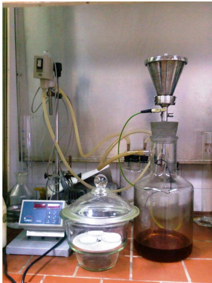
*Slika 44. Aparatura za mjerjenje količine sedimenta*
