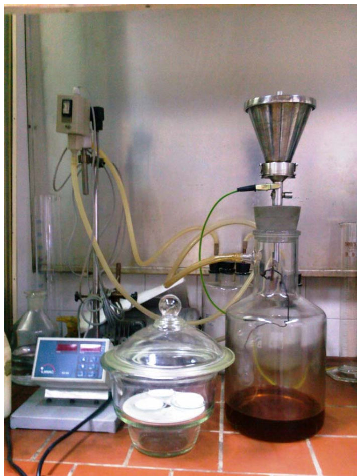
Slika 44. Aparatura za mjerenje količine sedimenta
