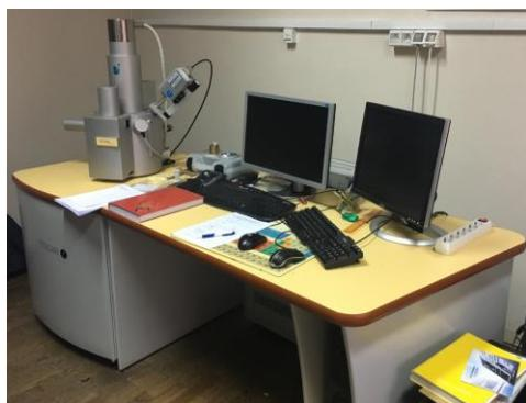
Slika 6-11. Pretražni elektronski mikroskop Tescan VEGA 5136 MM.
