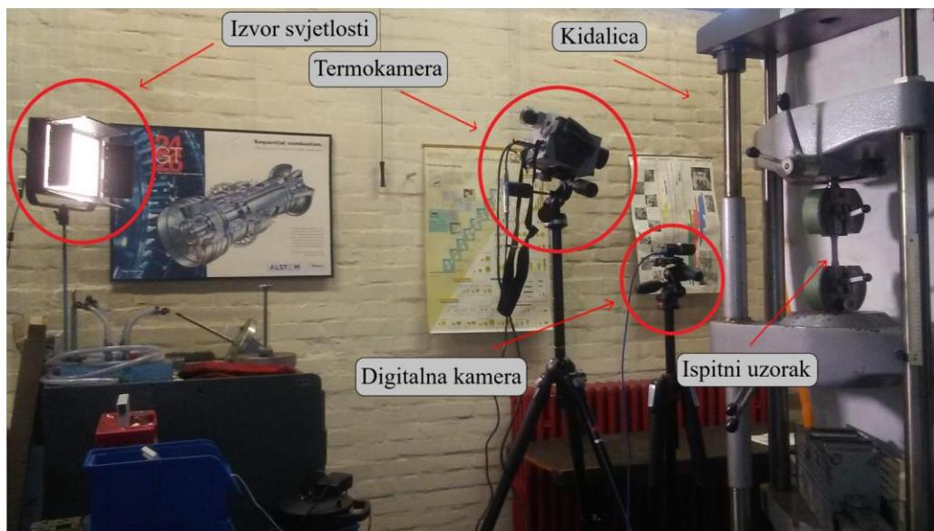
Slika 6-8. Raspored korištene opreme tijekom ispitivanja.
