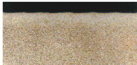
Slika P2.5. Slika mikrostrukture pouglicenog čelika [56]
