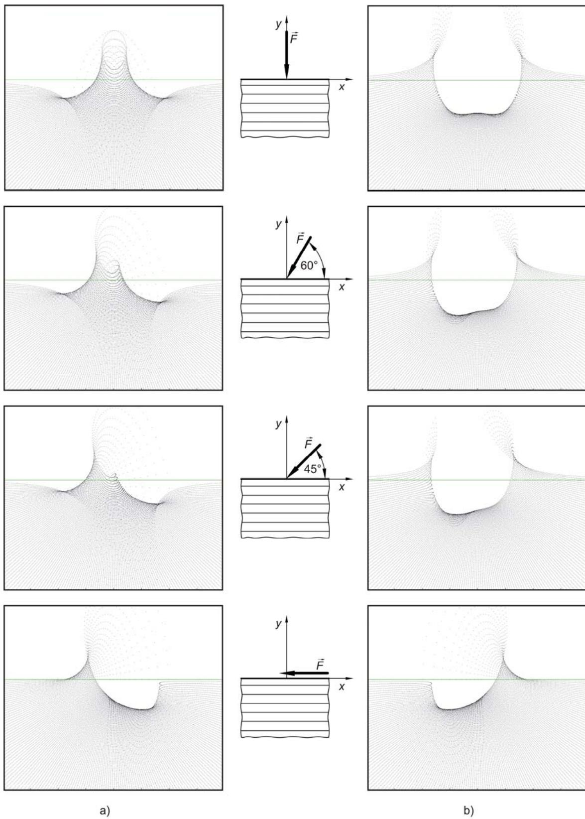
**Slika 4.9** Simulacije optičkog efekta kaustike za različite uvjete opterećenja (CFRP131,  $\theta=0^\circ$ ). a) realne slike i b) virtualne slike
