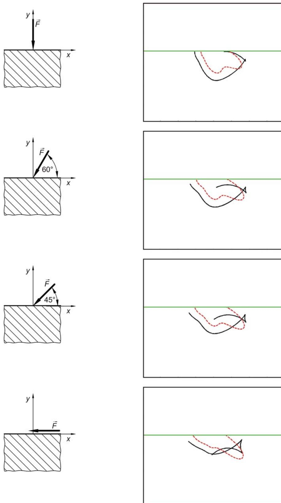
Slika 4.15 Simulacije krivulja kaustike i inicijalnih krivulja za različite uvjete opterećenja (CFRP131,  $\theta=45^\circ$ ).
