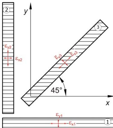
**Slika 2.3** Princip izrezivanja epruveta iz kompozitne ploče
