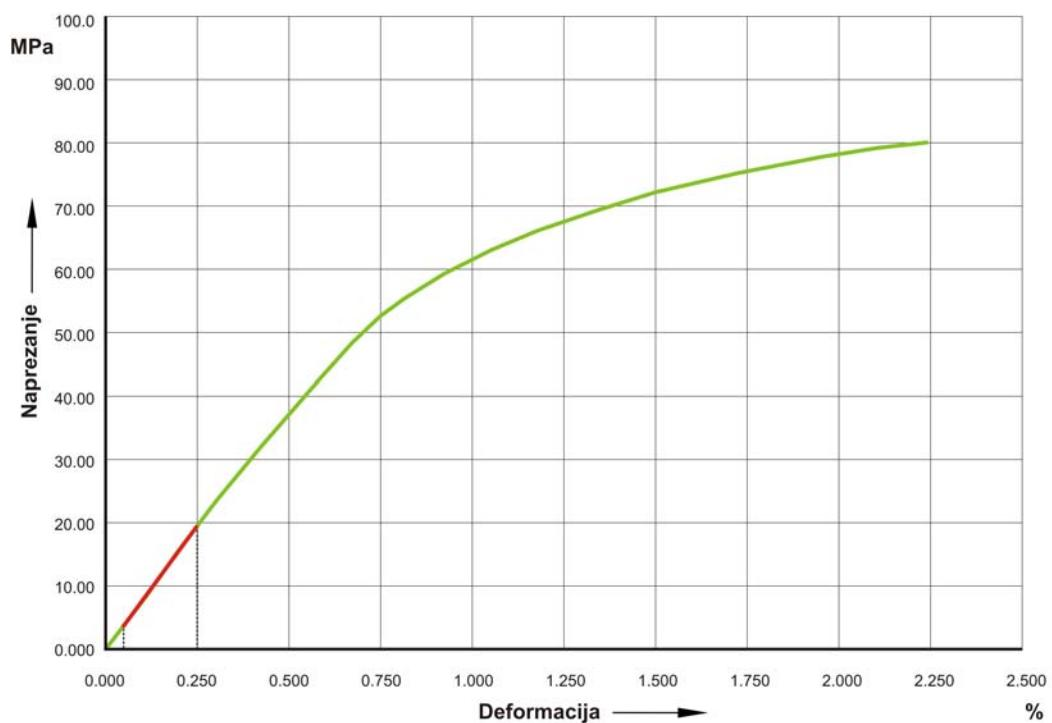
Slika 2.9 Dijagram  $\sigma$ - $\epsilon$  CFRP kompozita opterećenog u smjeru  $45^\circ$  u odnosu na smjer vlakana (epruveta 3)
