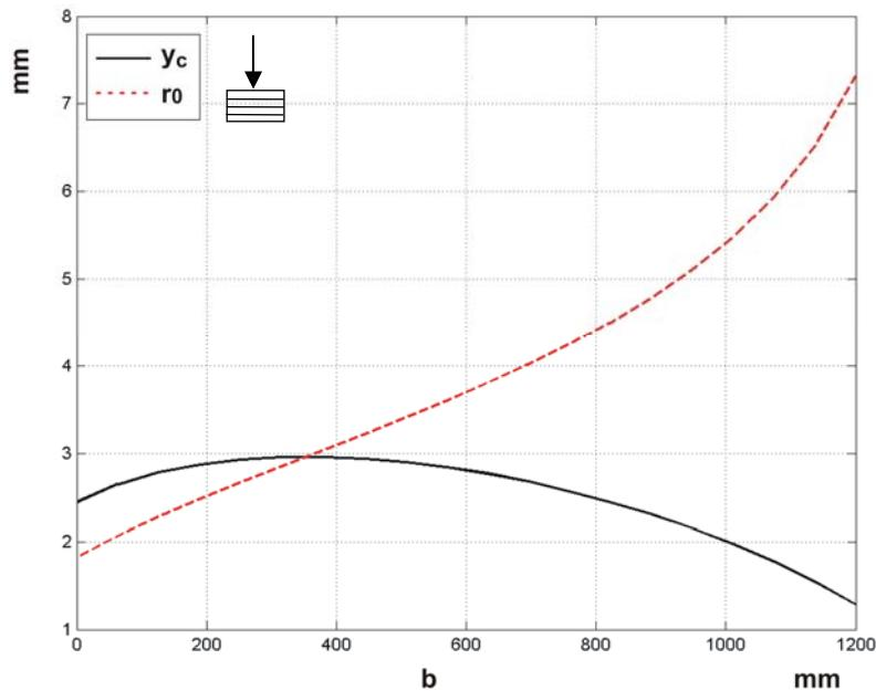
**Slika 5.8** Položaj inicijalne krivulje i veličina kaustike u konvergentnom snopu svjetla, materijal CFRP131,  $\theta=0^\circ$ ,  $F=600$  N
