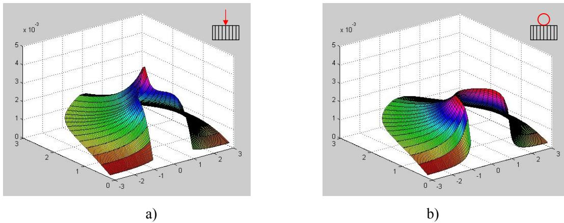
**Slika 3.8** Poprečna deformacija modela ( $\epsilon_z$ ): opterećenje koncentriranom silom (a), opterećenje cilindričnim utiskivačem (b),  $R= 10$  mm,  $F=100$  N.
