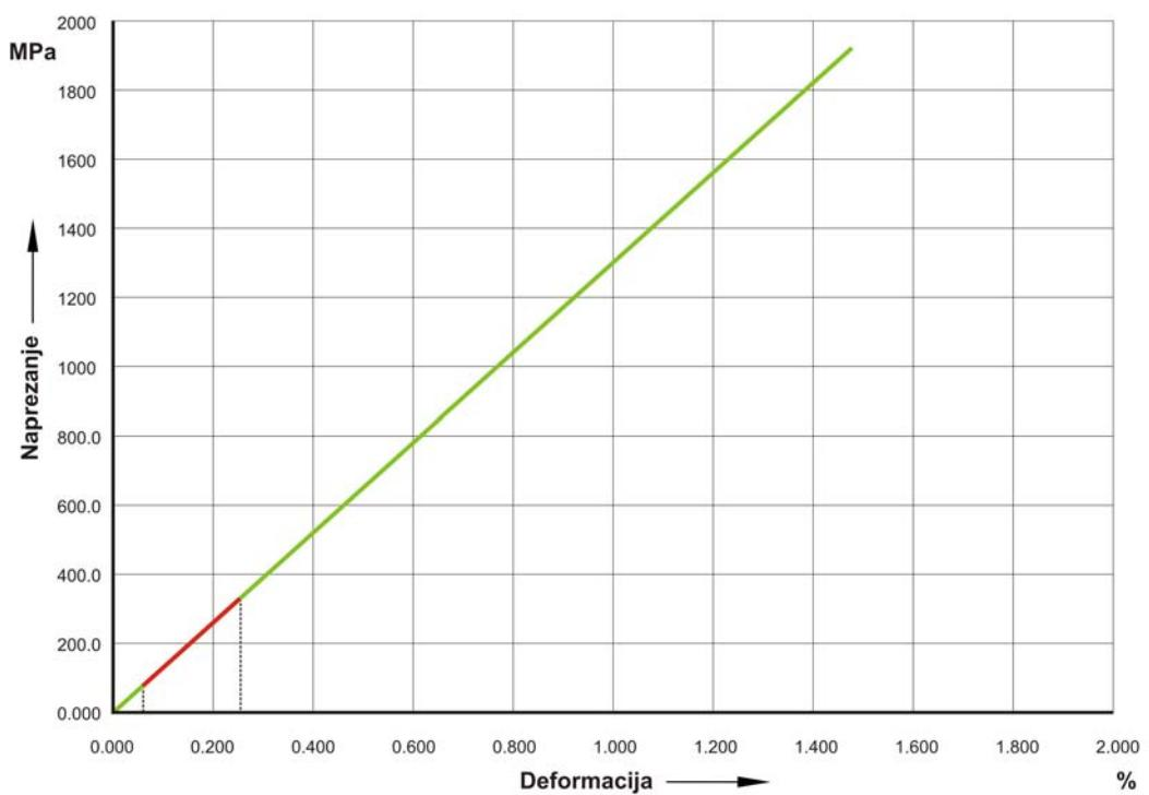
Slika 2.7 Dijagram  $\sigma$ - $\epsilon$  CFRP kompozita opterećenog u smjeru vlakana (epruveta 1)
