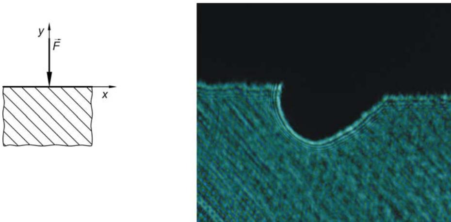
**Slika 5.15** Optički efekt kaustike snimljen na CFRP131 kompozitu za  $\vartheta=45^\circ$
