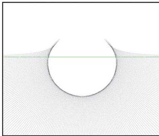
**Slika 4.6** Simulacija optickog efekta kaustike na zaslonu
