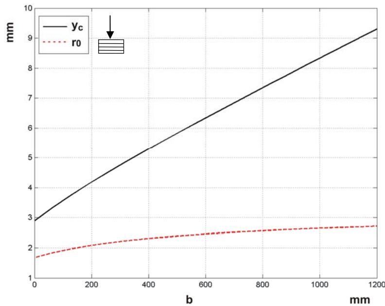
**Slika 5.5** Položaj inicijalne krivulje i veličina kaustike u divergentnom snopu svjetla, materijal CFRP131,  $\theta=0^\circ$ ,  $F=600$  N
