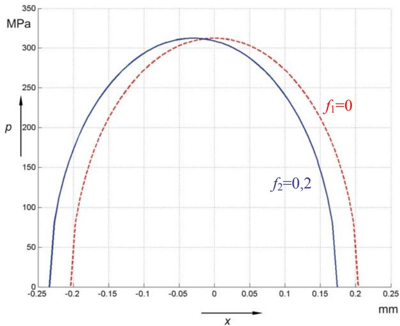
**Slika 3.6** Raspodjela pritiska na kompozitnoj ploči u ovisnosti o nagibu opterećenja ( $f_1=0, f_2=0.2, F=100 \text{ N}, R=10 \text{ mm}$ )
