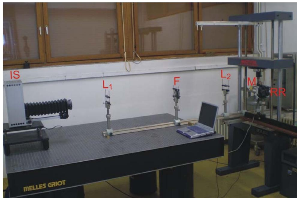
**Slika 5.3** Optički postav za eksperimentalno snimanje kaustike (IS-izvor svjetla, L<sub>1</sub> i L<sub>2</sub>-leće, F – filter, PZ-polupropusno zrcalo, RR-referentna ravnina (zaslon), M-model)
