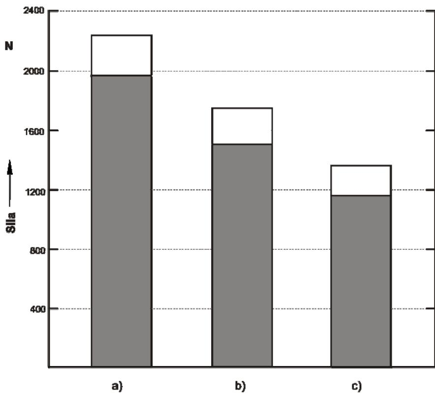
**Slika 6.4** Sile kod kojih dolazi do pojave pukotine u kompozitnom materijalu na mjestu djelovanja kontaktnih sila za a)  $\theta=90^\circ$ , b)  $\theta=0^\circ$  i c)  $\theta=45^\circ$
