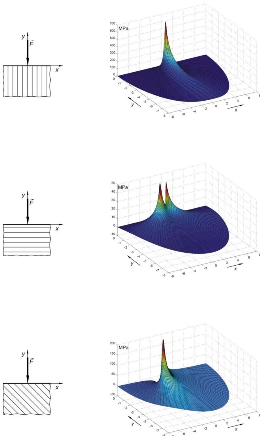
**Slika 3.4** Trodimenzionalni prikaz raspodjele naprezanja u CFRP131 kompozitu,
