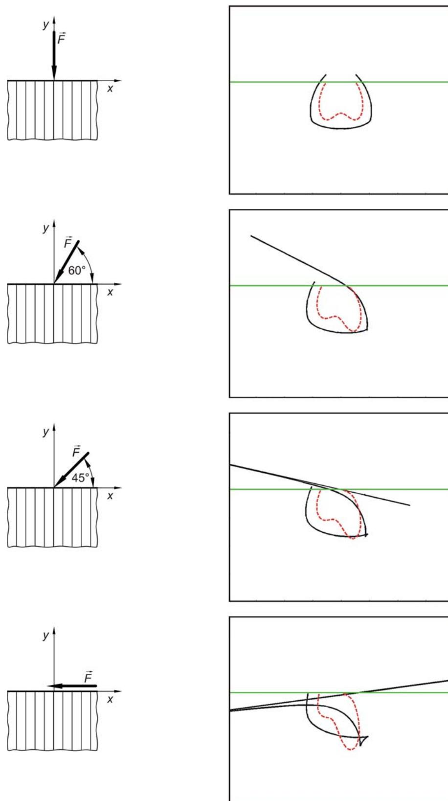
Slika 4.13 Simulacije krivulja kaustike i inicijalnih krivulja za različite uvjete opterećenja (CFRP131,  $\theta=90^\circ$ ).
