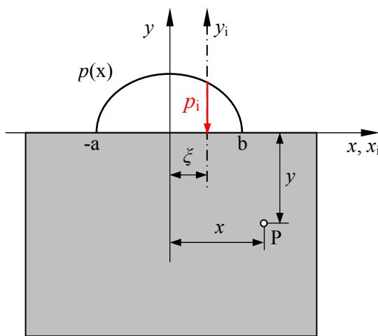
**Slika 3.7** Djelovanje cilindričnog utiskivača na ortotropnu ploču
