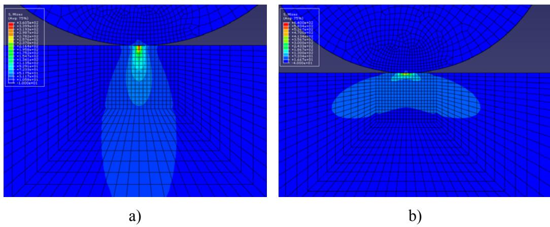
**Slika 3.10** Raspodjela ekvivalentnih naprezanja, CFRP131 kompozit,  $F=100$  N.
