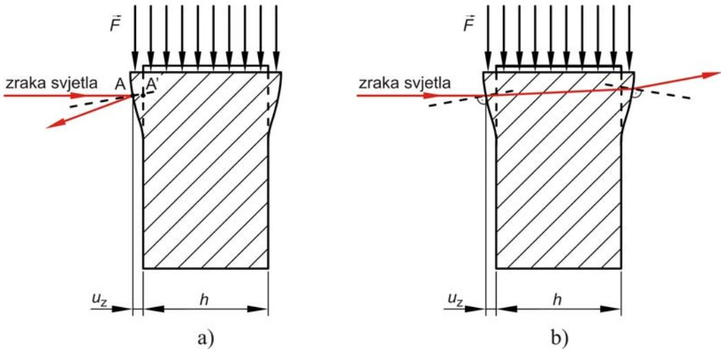
Slika 4.3 a) refleksija zrake svjetla sa prednje površine modela
