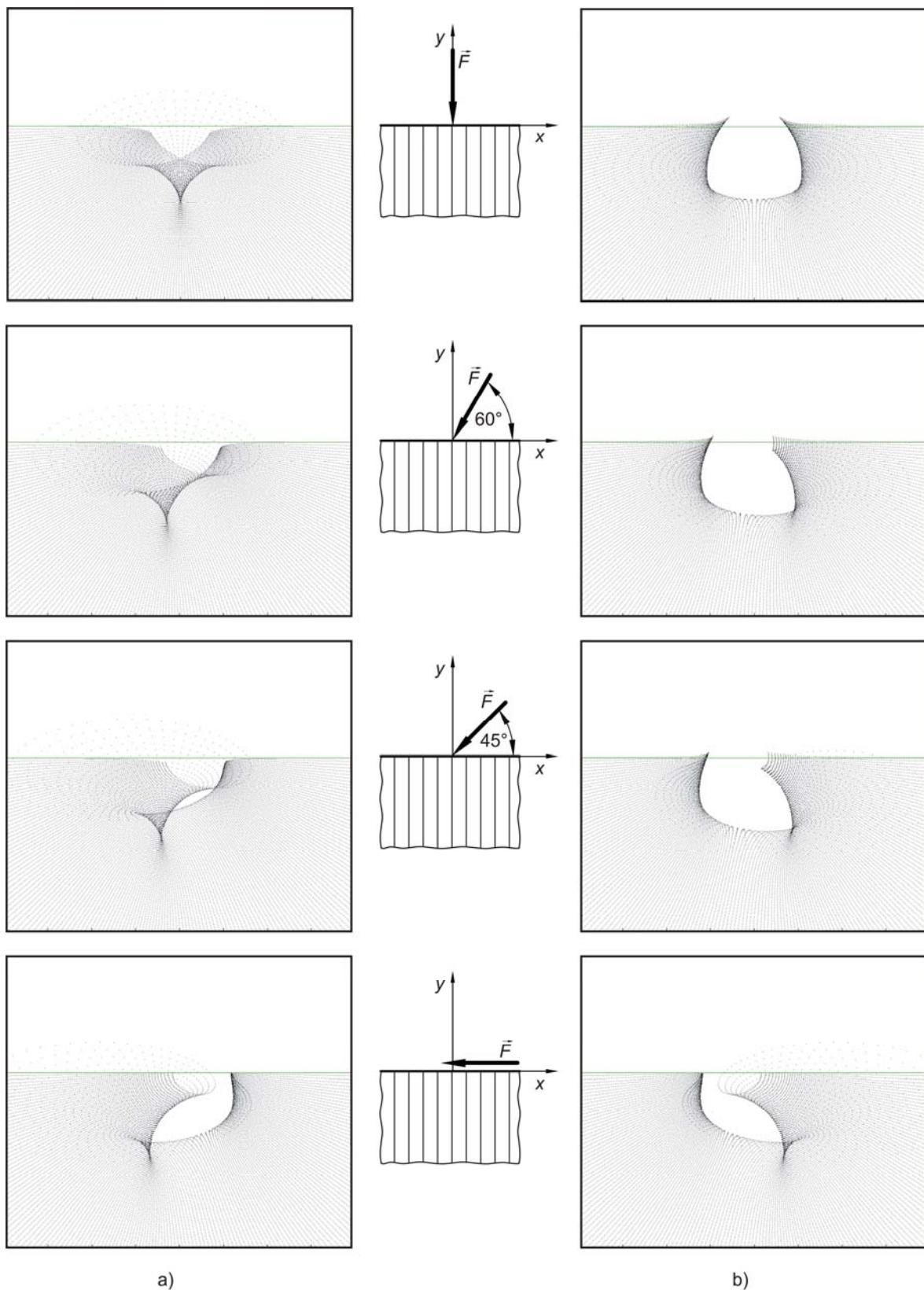
**Slika 4.8** Simulacije optičkog efekta kaustike za različite uvjete opterećenja (CFRP131,  $\theta=90^\circ$ ). a) realne slike i b) virtualne slike
