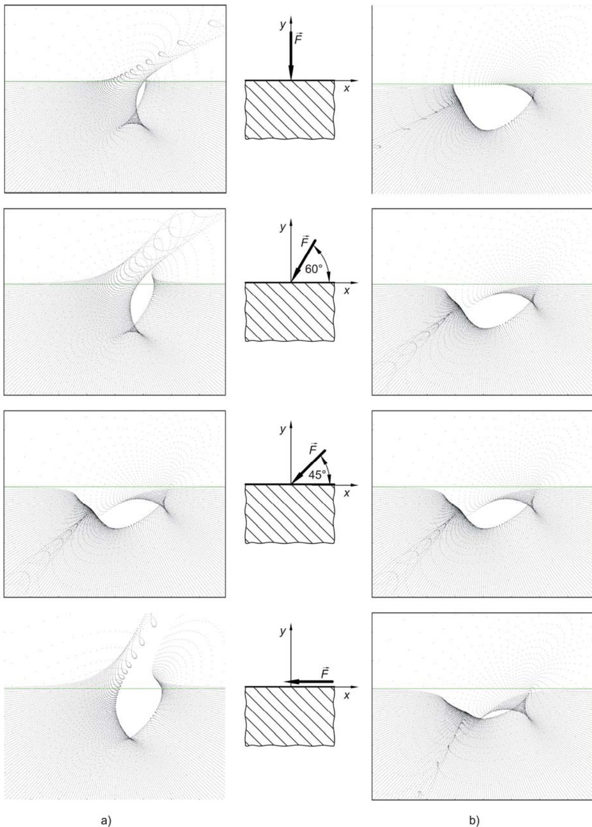
**Slika 4.10** Simulacije optičkog efekta kaustike za različite uvjete opterećenja (CFRP131,  $\theta=45^\circ$ ). a) realne slike i b) virtualne slike
