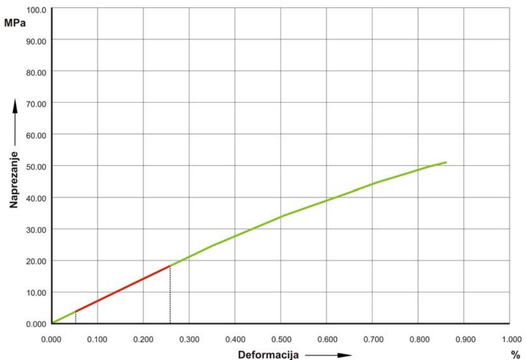
Slika 2.8 Dijagram  $\sigma$ - $\epsilon$  CFRP kompozita opterećenog u smjeru okomitom na smjer vlakana (epruveta 2)
