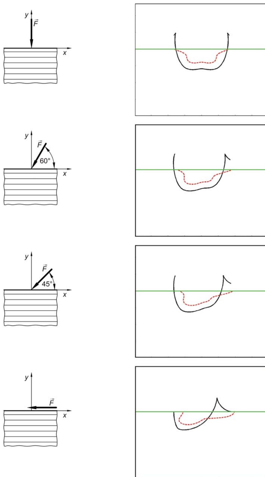
Slika 4.14 Simulacije krivulja kaustike i inicijalnih krivulja za različite uvjete opterećenja (CFRP131,  $\theta=0^\circ$ ).
