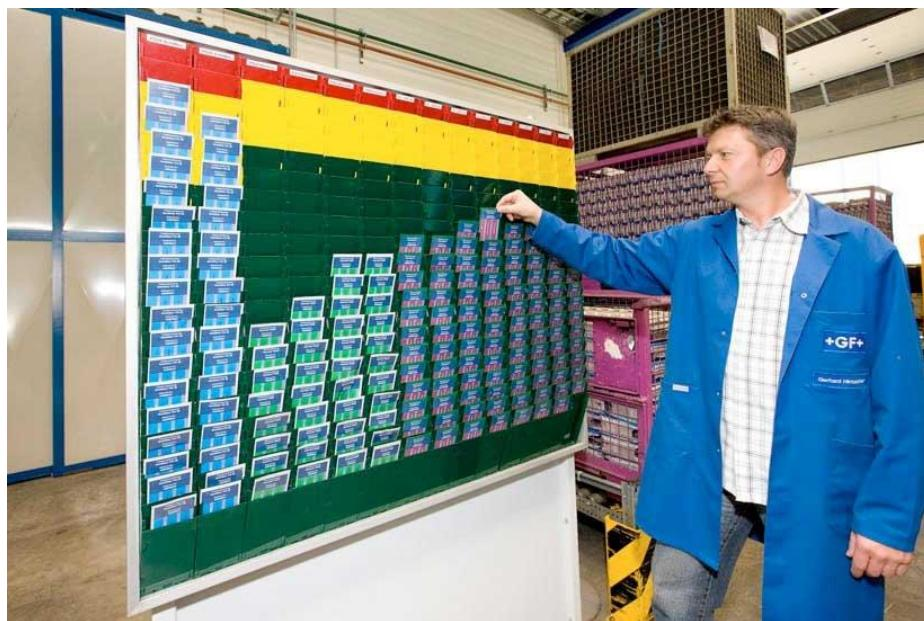
*Slika 25. Kanban ploča za planiranje proizvodnje [112]*
