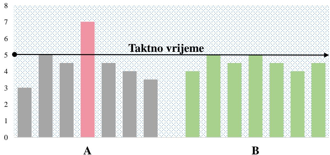
*Slika 40.* Niveliranje proizvodnje prema taktnom vremenu [205]
