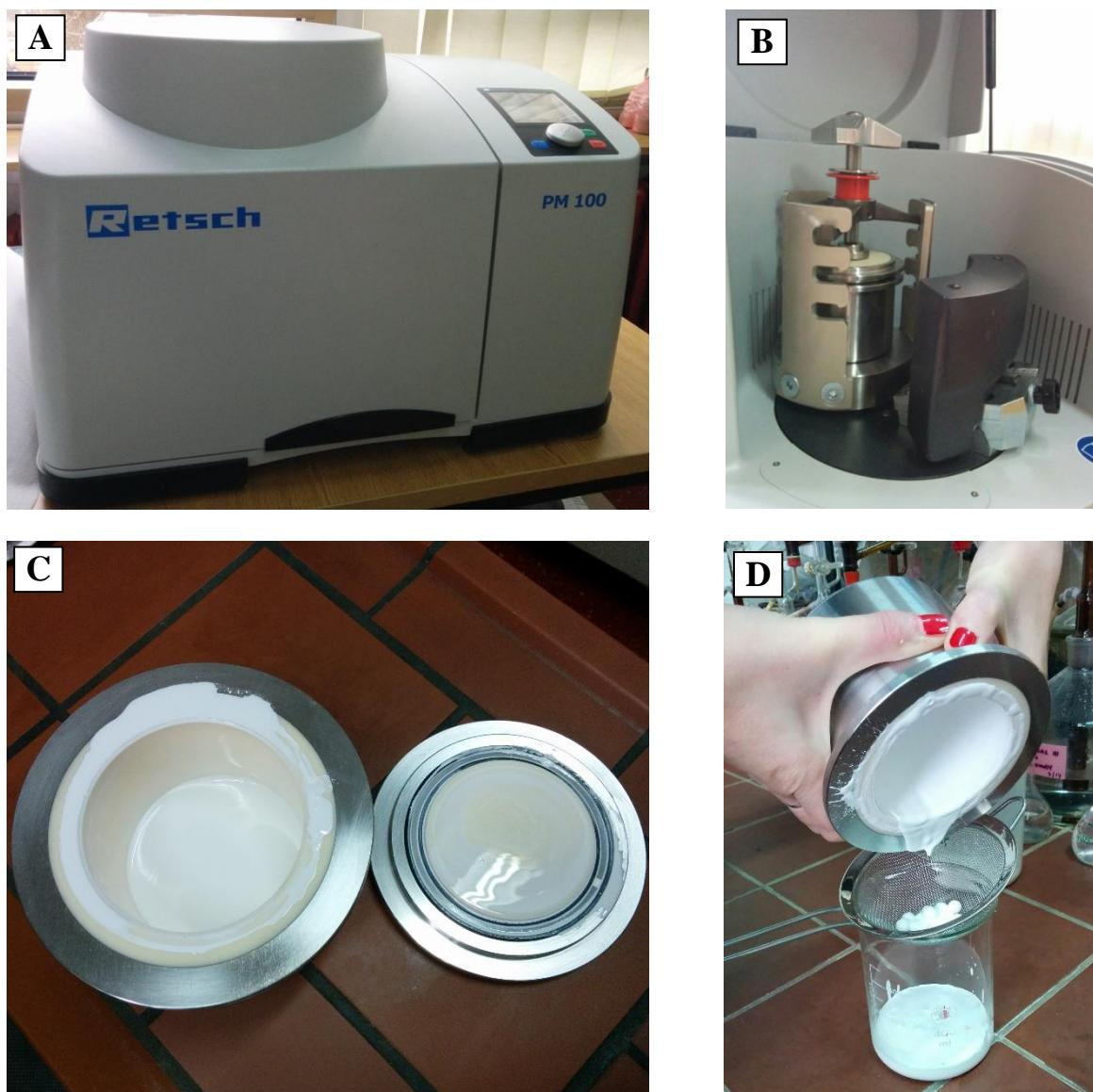
Slika 5.5 Priprava keramičkih suspenzija: (A) planetarni kuglični mlin Retsch PM 100; (B) pozicioniranje posude za miješanje u planetarnom kugličnom mlincu; (C) otvorena posuda mlina nakon provedene homogenizacije; (D) filtracija suspenzije (odvajanje keramičkih kuglica).
