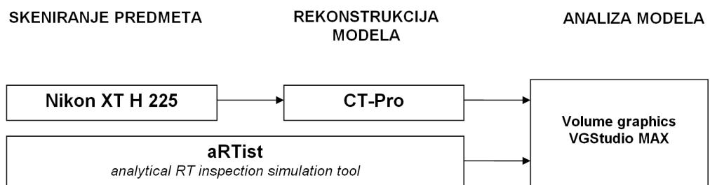
Slika 4-1. Grafički prikaz provedbe procesa dimenzionalnih mjeranja računalnom tomografijom.
