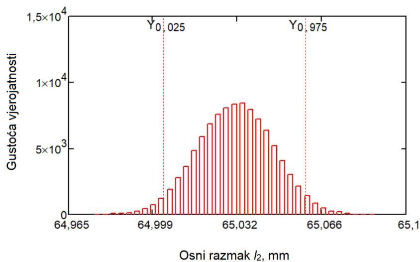
Slika 5-12. Funkcija gustoće vjerojatnosti  $g(l_2)$  osnog razmaka polimernog cilindra složene geometrije.
