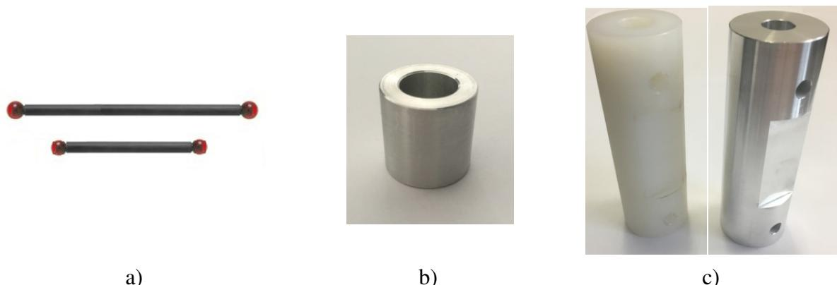
Slika 4-2. Predmeti korišteni u eksperimentalnim istraživanjima: a) umjerni štapići, b) cilindar jednostavne geometrije, c) cilindri složene geometrije.
