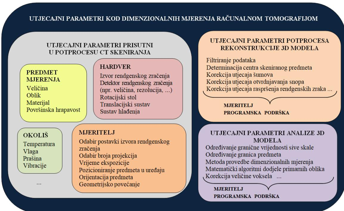
Slika 3-10. Podjela utjecajnih parametara kod dimenzionalnih mjerena računalnom tomografijom [72].
