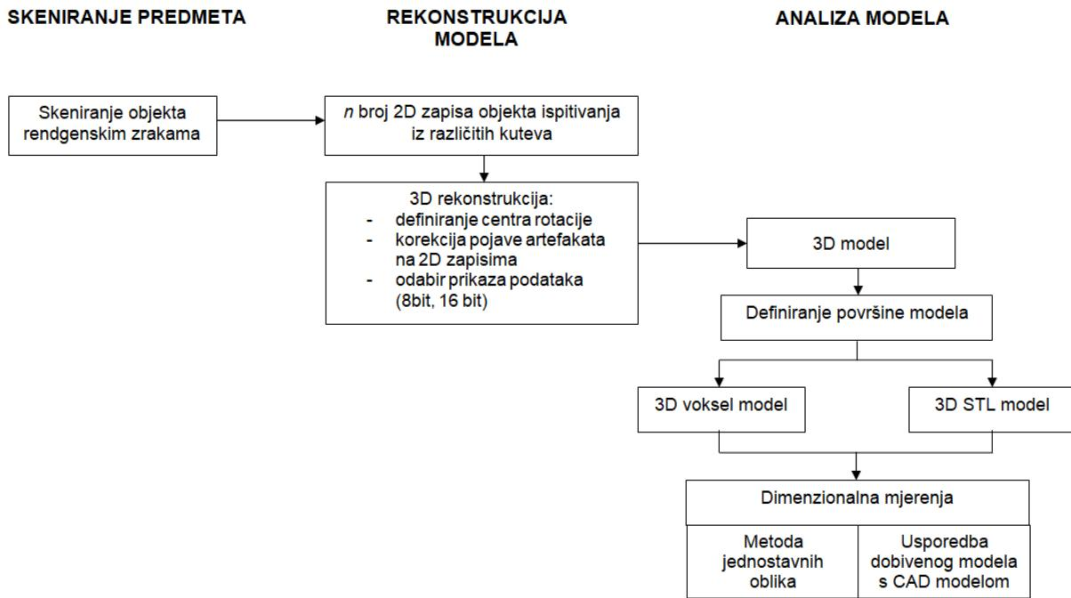
Slika 2-2. Proces provedbe dimenzionalnog mjerjenja računalnom tomografijom.
