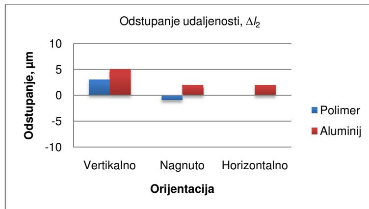
Slika 4-18. Odstupanja rezultata mjerena udaljenosti  $l_2$  kod različitih orijentacija polimernog i aluminijskog cilindra.
