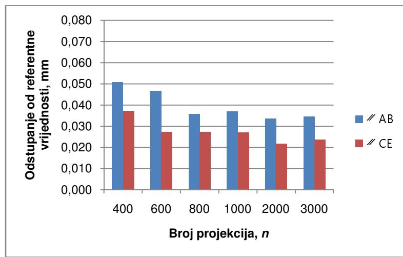
Slika 4-10. Odstupanje rezultata mjerena paralelnosti s povećanjem broja projekcija.
