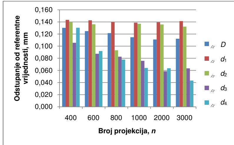
Slika 4-11. Odstupanje rezultata mjerena cilindričnosti s povećanjem broja projekcija.
