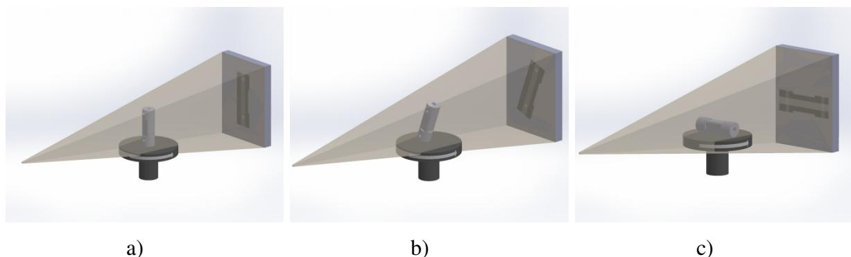
Slika 4-15. Prikaz različitih orientacija predmeta mjerena tijekom procesa skeniranja:
