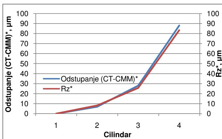
Slika 4-26. Rezultati dimenzionalnih mjerena vanjskog promjera 4 cilindra u odnosu na izmjerenu hrapavost  $R_z$  nakon izvršene korekcije rezultata.
