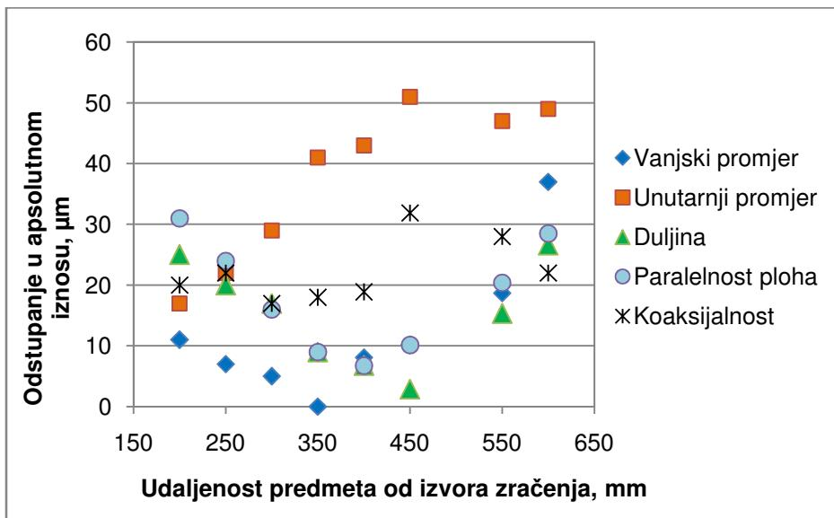
Slika 4-34. Odstupanja rezultata mjerena u ovisnosti o geometrijskom povećanju.
