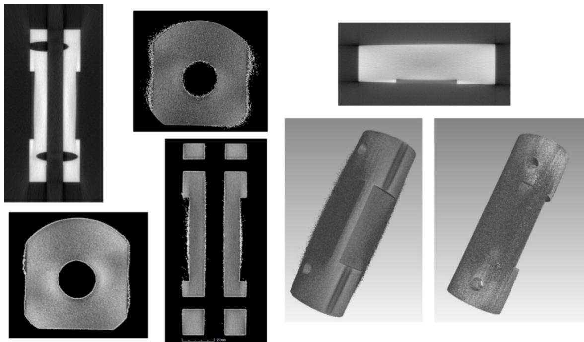
Slika 2-23. Rekonstruirani modeli s vidljivim utjecajem sekundarnog zračenja.
