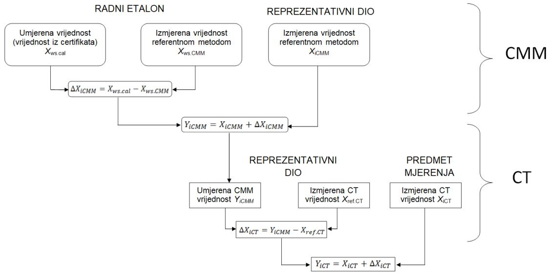
Slika 3-12. Postupak provedbe dimenzionalnih mjerjenja sukladno ISO 15530-3 [77].
