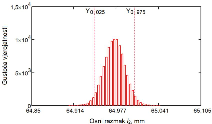
Slika 5-7. Funkcija gustoće vjerojatnosti  $g(l_2)$  osnog razmaka aluminijskog cilindra složene geometrije.
