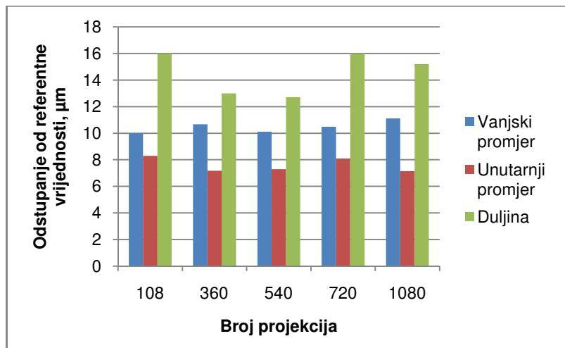
Slika 4-6. Odstupanje rezultata mjerena dimenzionalnih značajki cilindra jednostavne geometrije s povećanjem broja projekcija.
