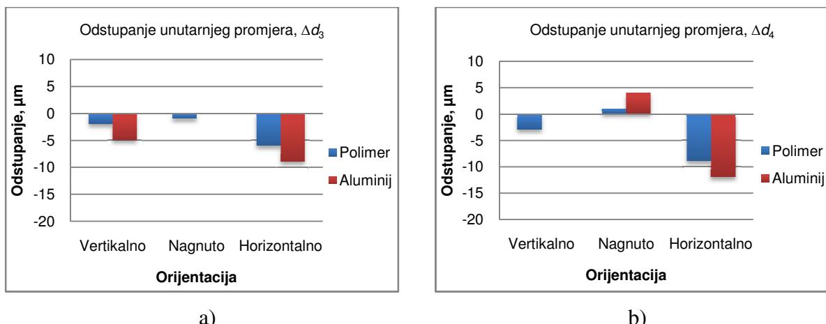
Slika 4-22. Odstupanja rezultata mjerena unutarnjih promjera kod različitih orijentacija polimernog i aluminijskog cilindra: a)  $d_3$ , b)  $d_4$ .
