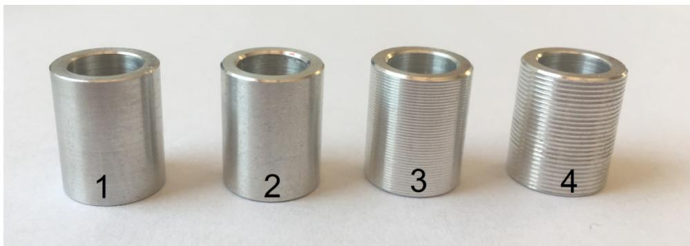
Slika 4-24. Prikaz četiri aluminijska cilindara različite površinske hrapavosti.
