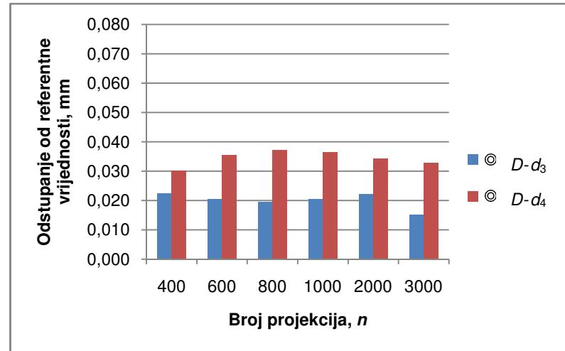
Slika 4-12. Odstupanje rezultata mjerena koaksijalnosti s povećanjem broja projekcija.
