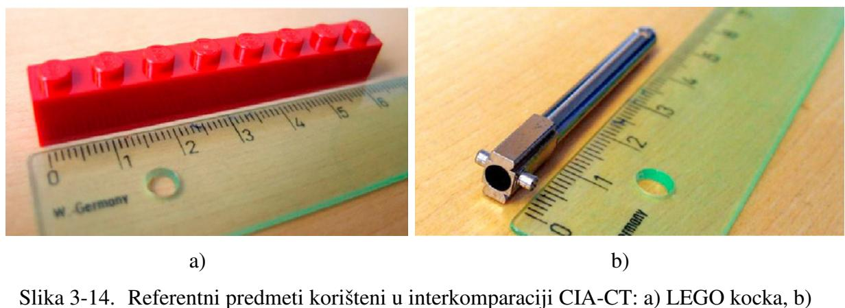
Slika 3-14. Referentni predmeti korišteni u interkomparaciji CIA-CT: a) LEGO kocka, b) komponenta inzulinske olovke [82].
