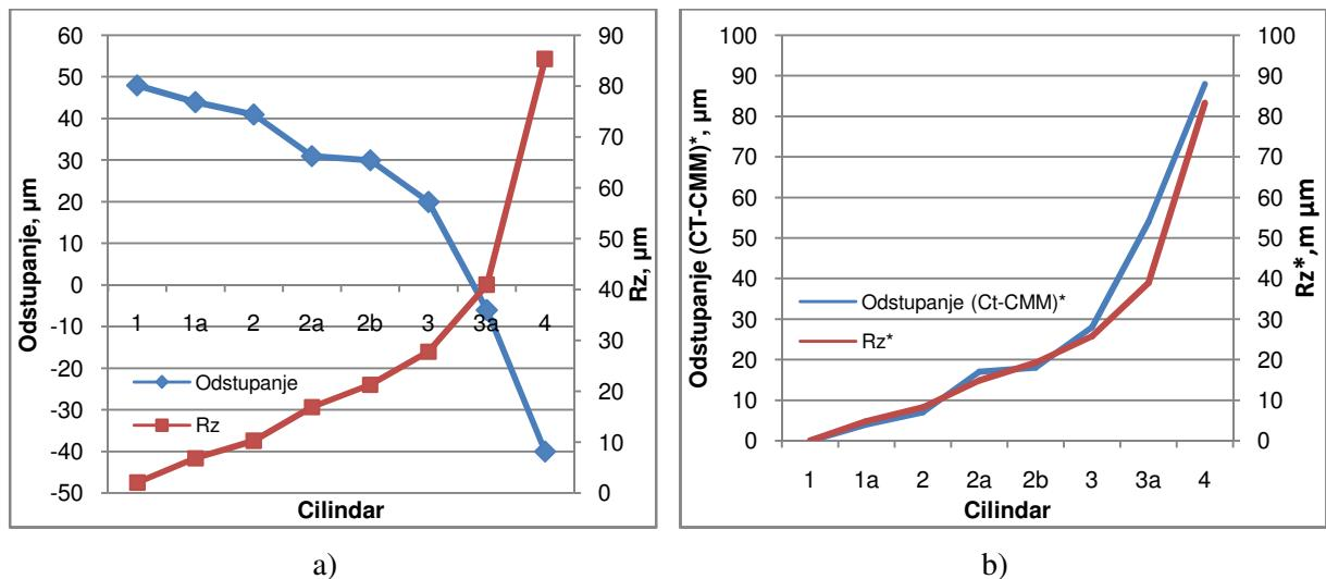
Slika 4-28. Rezultati dimenzionalnih mjerena promjera vanjskog cilindra 8 cilindara u odnosu na izmjerenu hrapavost  $Rz$ : a) prije korekcije rezultata, b) nakon korekcije rezultata.
