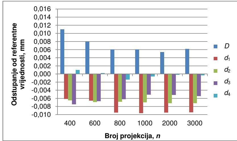
Slika 4-13. Odstupanje rezultata mjerena vanjskog i unutarnjih promjera s povećanjem broja projekcija.
