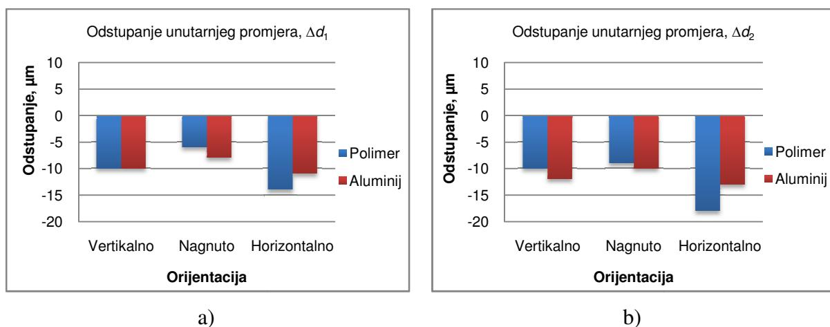
Slika 4-21. Odstupanja rezultata mjerena unutarnjih promjera kod različitih orijentacija polimernog i aluminijskog cilindra: a)  $d_1$ , b)  $d_2$ .
