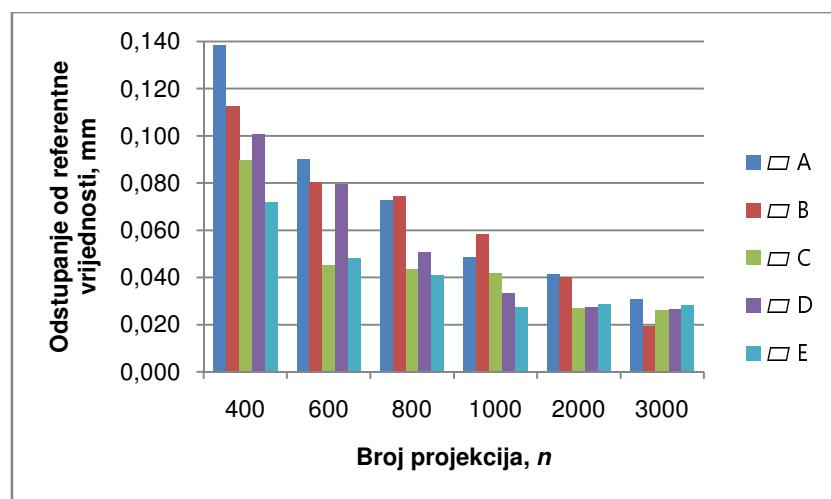
Slika 4-8. Odstupanje rezultata mjerena ravnosti s povećanjem broja projekcija.
