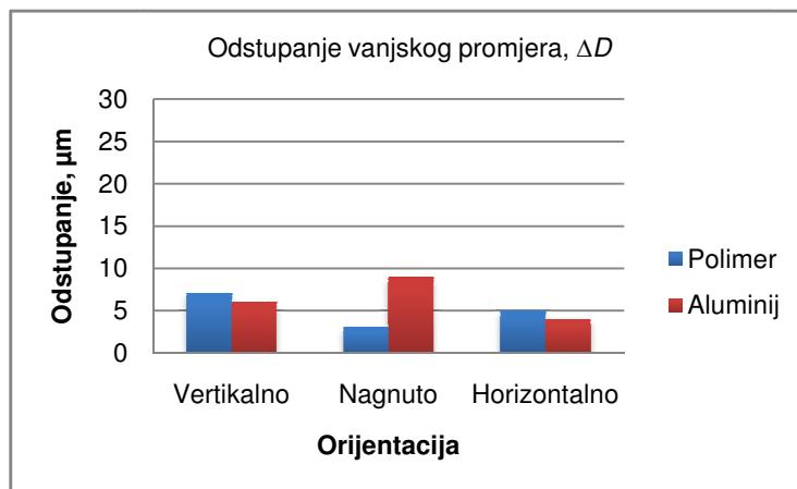
Slika 4-20. Odstupanja rezultata mjerena vanjskog promjera  $D$  kod različitih orijentacija polimernog i aluminijskog cilindra.
