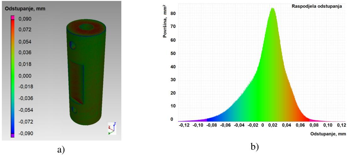
Slika 2-30. Usaporeba CT modela s CAD modelom: a) preklopljeni modeli, b) graf raspodjele odstupanja.
