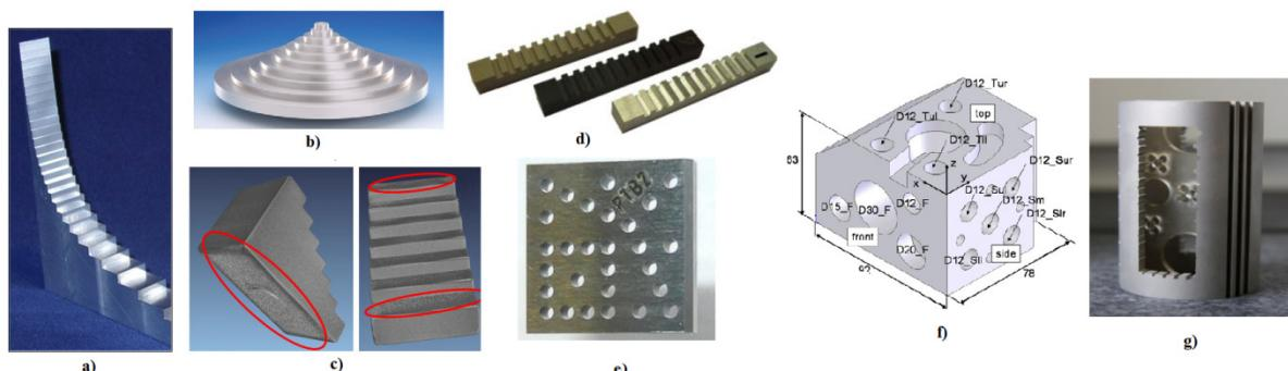
Slika 3-6. Ostali referentni predmeti: a) stepenasti luk [65], b) stepenasti stožac [58], c) stepenasti blok [62], d) zupčasti predmeti [53], e) ploča s provrtima [66], f) aluminijski blok složene geometrije [63], g) QFM cilindar [59].
