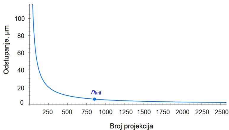
Slika 4-5. Odstupanje rezultata mjerena u ovisnosti o broju projekcija prema teorijski pretpostavljenoj funkciji.
