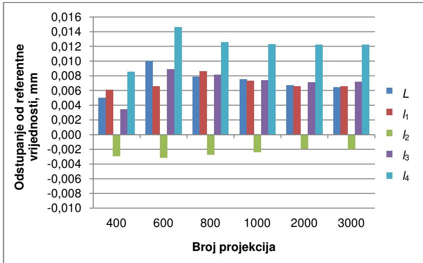
Slika 4-14. Odstupanje rezultata mjerena udaljenosti  $L$ ,  $l_1$ ,  $l_2$ ,  $l_3$  i  $l_4$  s povećanjem broja projekcija.
