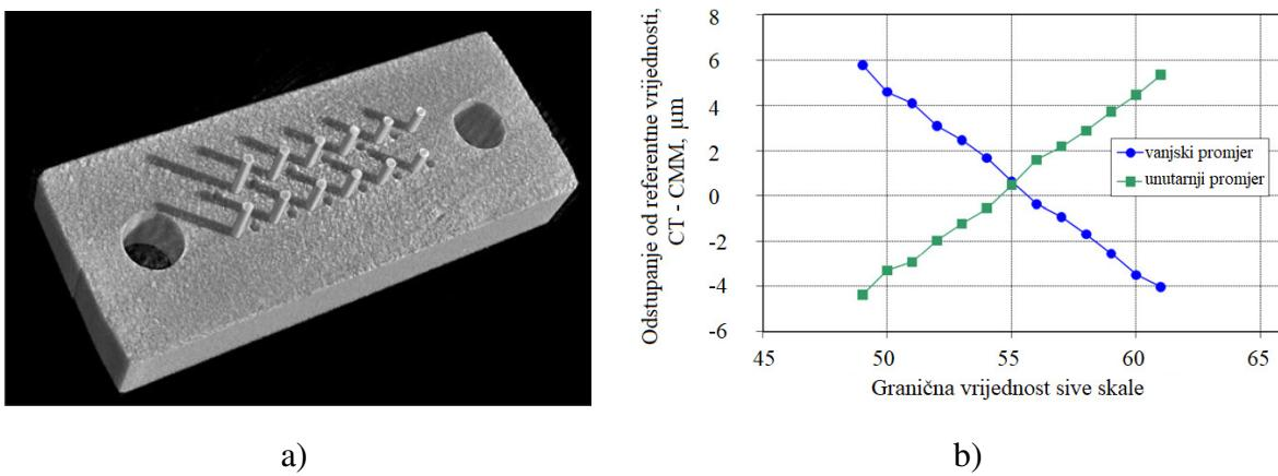
Slika 3-3. Korekcija granične vrijednosti sive skale: a) *fibre gauge*, b) utjecaj granične vrijednosti sive skale na rezultate mjerena [60].
