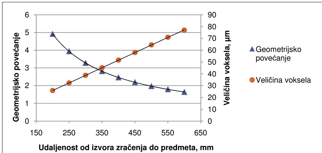
Slika 4-33. Ovisnost veličine voksla i geometrijskog povećanja o udaljenosti predmeta od izvora zračenja.
