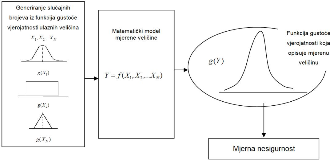
Slika 3-11. Simulacija mjernog sustava metodom Monte Carlo [73].
