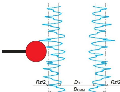
Slika 4-29. Utjecaj parametra hrapavosti  $Rz$  na rezultate mjerena vanjskog promjera cilindra.
