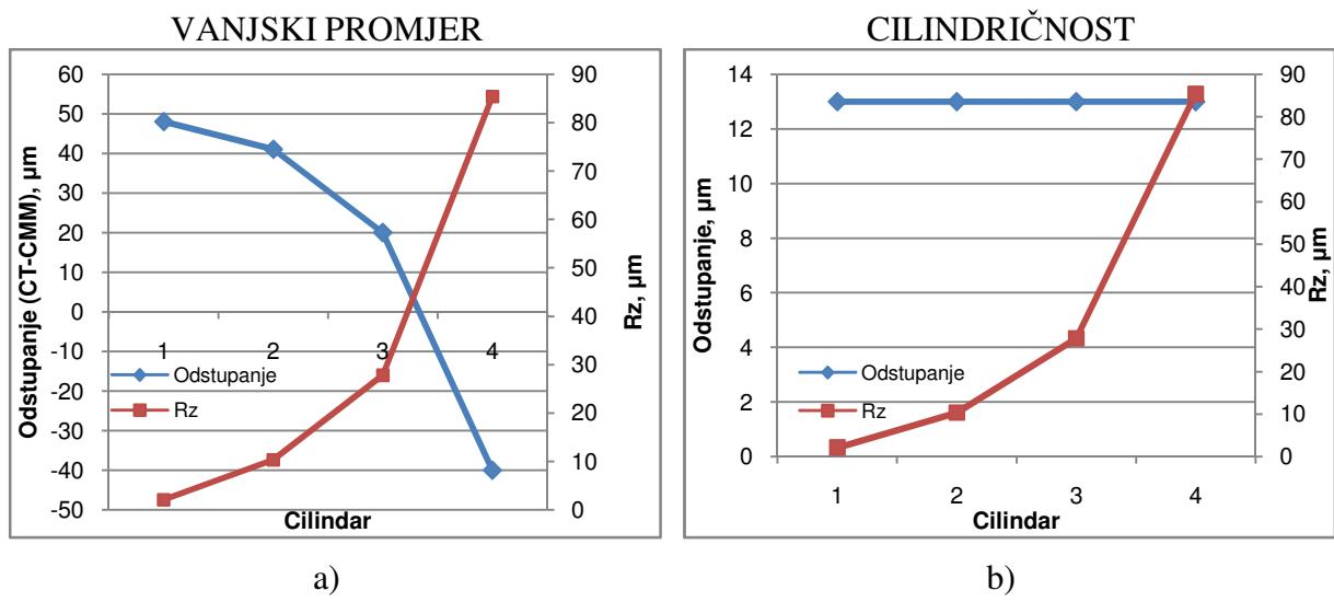
Slika 4-25. Rezultati dimenzionalnih mjerena 4 cilindra u odnosu na izmjerenu hrapavost  $R_z$ : a) vanjski promjer, b) cilindričnost.
