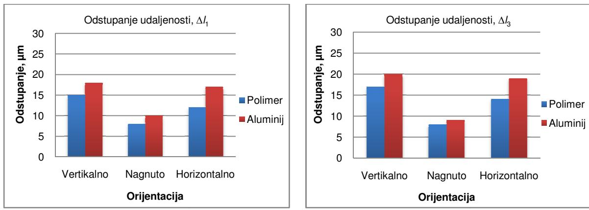
Slika 4-17. Odstupanja rezultata mjerena udaljenosti kod različitih orijentacija polimernog i aluminijskog cilindra: a)  $l_1$ , b)  $l_3$ .
