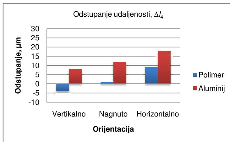
Slika 4-19. Odstupanja rezultata mjerena udaljenosti  $l_4$  kod različitih orijentacija polimernog i aluminijskog cilindra.
