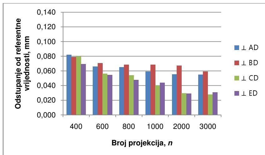
Slika 4-9. Odstupanje rezultata mjerena okomitosti s povećanjem broja projekcija.
