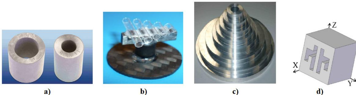
Slika 3-5. Referentni predmeti za određivanje granične vrijednosti sive skale: a) šuplj cilindar [58], b) *pan flute gauge* [59], c) stepenasti cilindar [58], d) *cactus gauge* [61].
