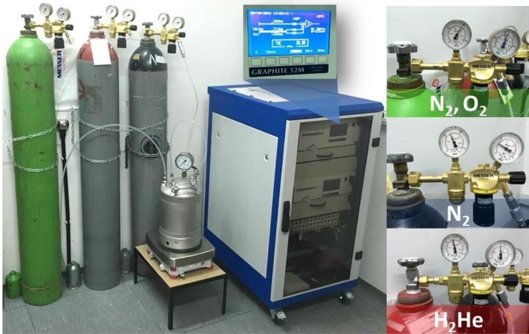
*Slika 2.43. Sustav analizatora za mjerjenje emisija štetnih plinova s radnim i kalibracijskim plinovima*
