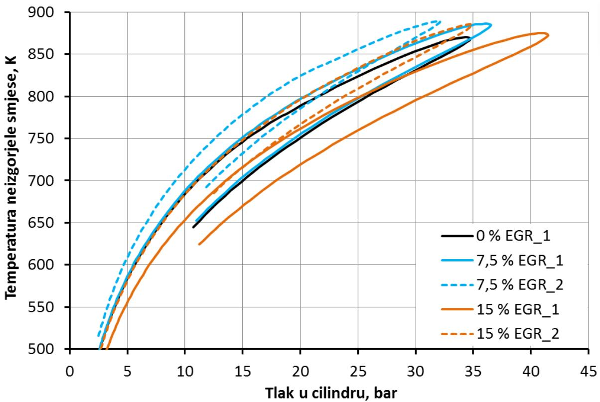
Slika 5.28. Profili  $p$ - $T_{\text{end-gas}}$  za radne točke skupine A
