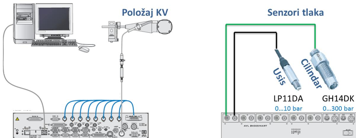
Slika 2.39. Sustav za indiciranje motora s unutarnjim izgaranjem
