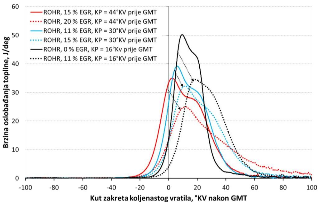
Slika 5.10. Profili brzine oslobođanja topline u cilindru za odabrane radne točke pri jednakom kutu pretpaljenja
