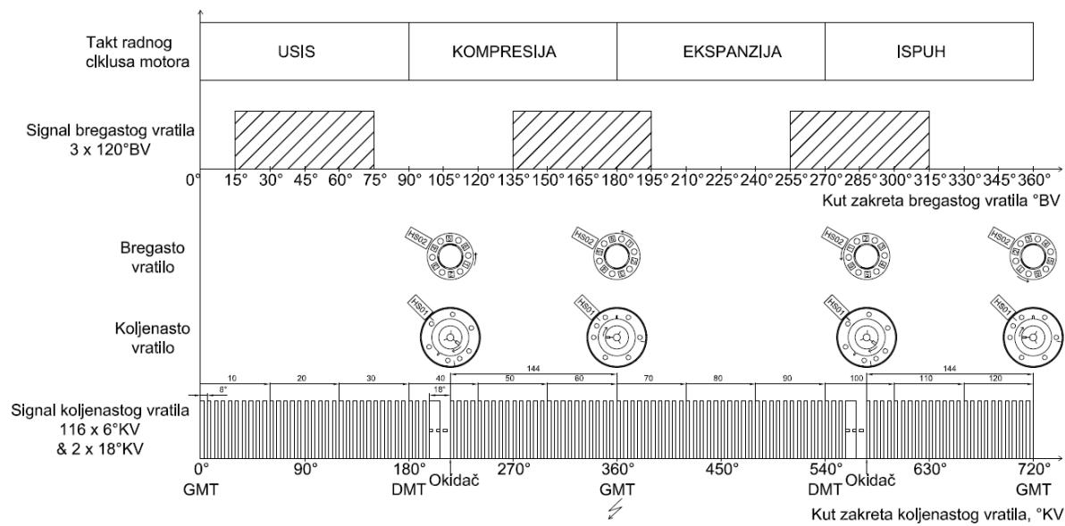
Slika 2.12. Shema digitalnih signala za očitanje pozicije klipnog mehanizma
