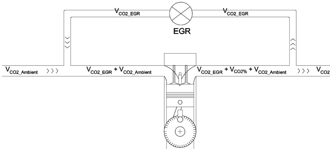
Slika 2.32. Shematski prikaz recirkulacije ispušnih plinova na MSUI
