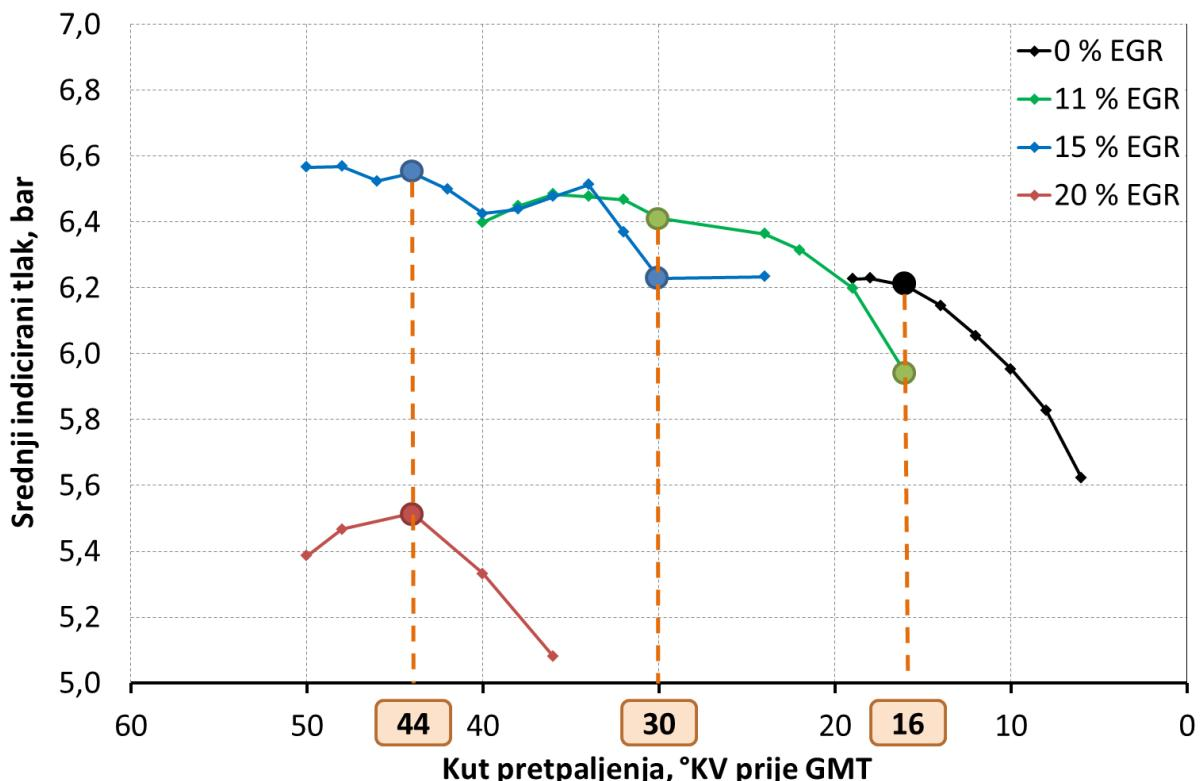
Slika 5.1. Srednji indicirani tlak promatranih radnih točaka s naznačenim odabranim radnim točkama za jednak kut pretpaljenja
