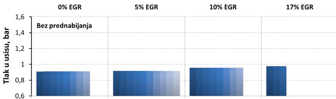
Slika 4.8. Tlak u cilindru motora bez prednabijanja
