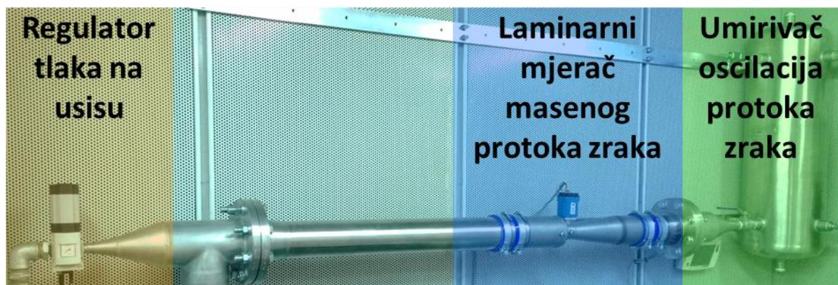
*Slika 2.25. Sustav mjerena protoka zraka na usisu motora, njegovi značajni elementi*
