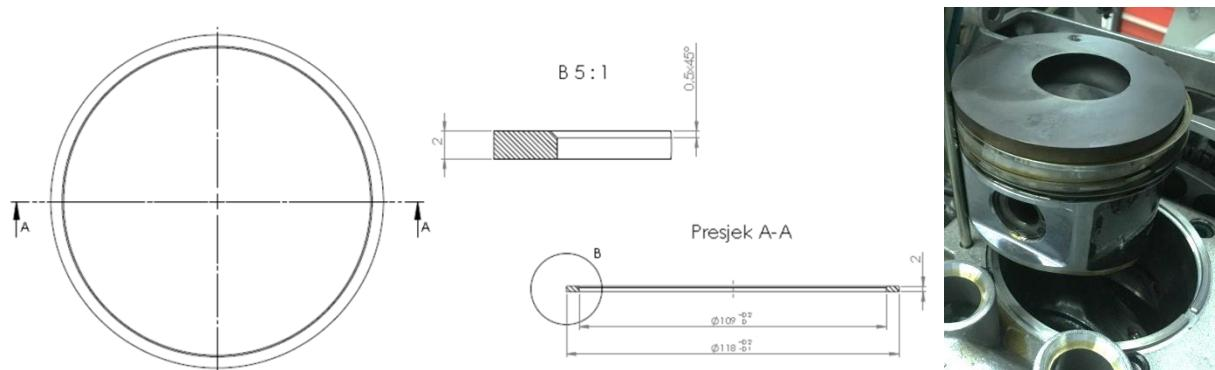
Slika 2.16. Distantni prsten za pomak cilindra i klip nakon brušenja čela klipa
