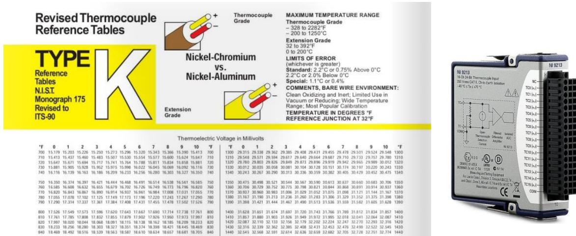
Slika 2.36. Dio tabličnog prikaza vrijednosti termopara tipa K
