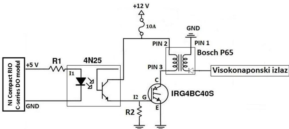
*Slika 2.22. Električna shema električnog sklopa za paljenje smjese [60]*
