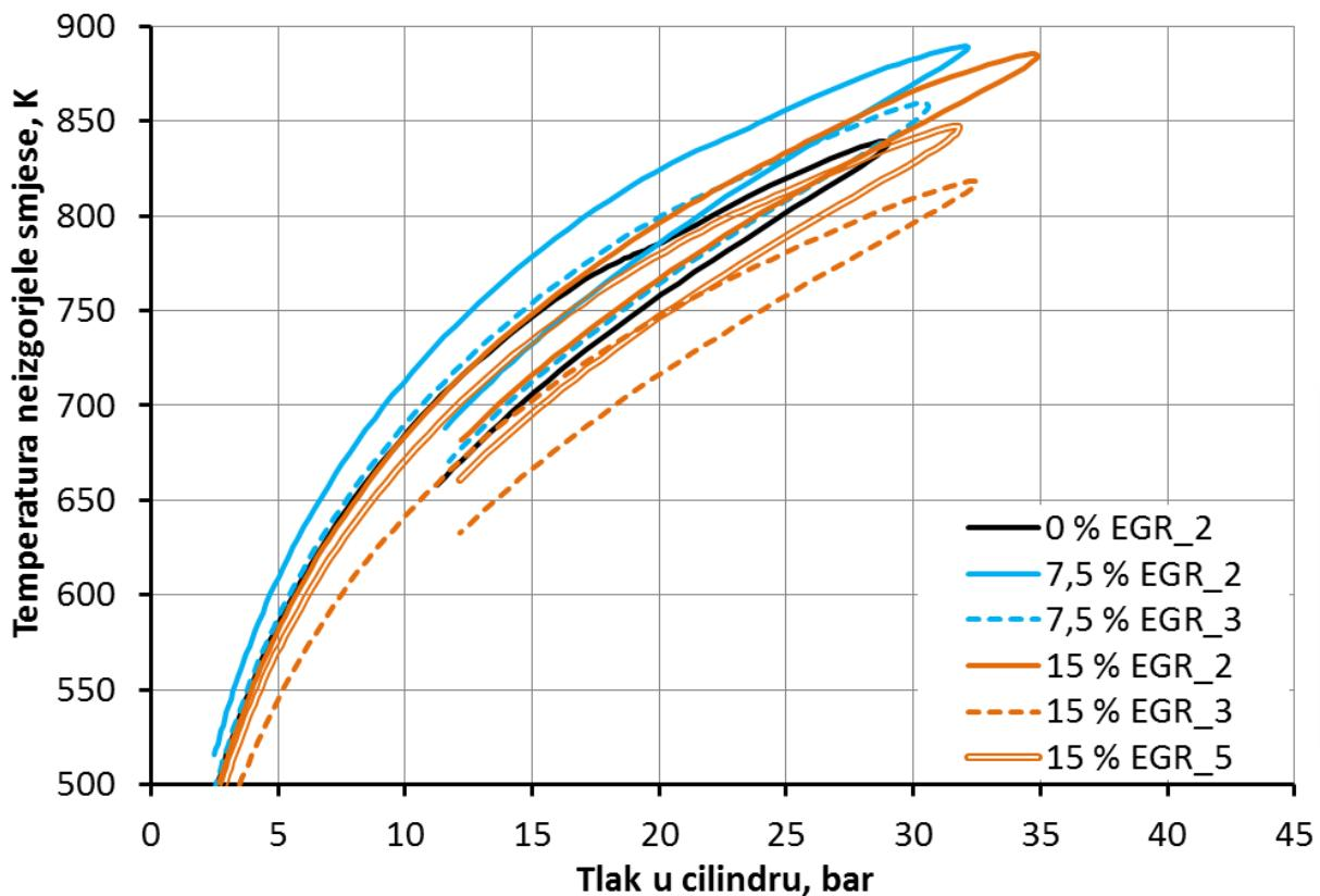
Slika 5.30. Profili  $p$ - $T_{end\text{-}gas}$  za radne točke skupine B
