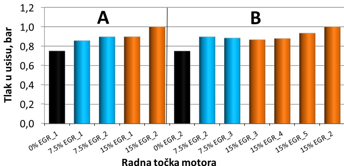
Slika 4.6. Apsolutni tlak u usisu za odabrane radne točke
