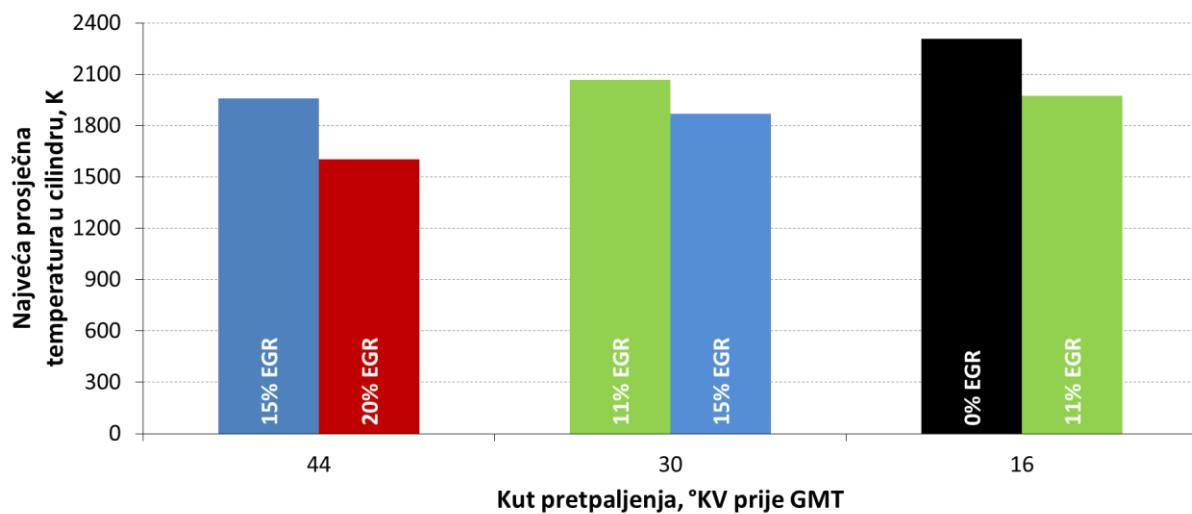
*Slika 5.5. Najveća prosječna temperatura u cilindru za odabране radne točke pri jednakom kutu pretpaljenja*
