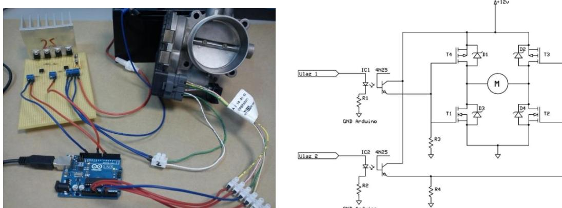
Slika 2.27. Električni sklop zaklopke snage Ottovog motora (lijevo), shema električnog sklopa (desno)
