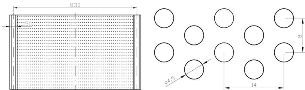
Slika 2.2. Dimenzijska skica jednog segmenta zvučno izolacijskog panela [50]
