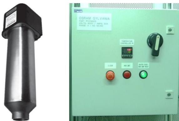
*Slika 2.28. Grijac usisnog zraka SUREHEAT MAX Air Heater (lijevo), upravljački ormara (desno)*
