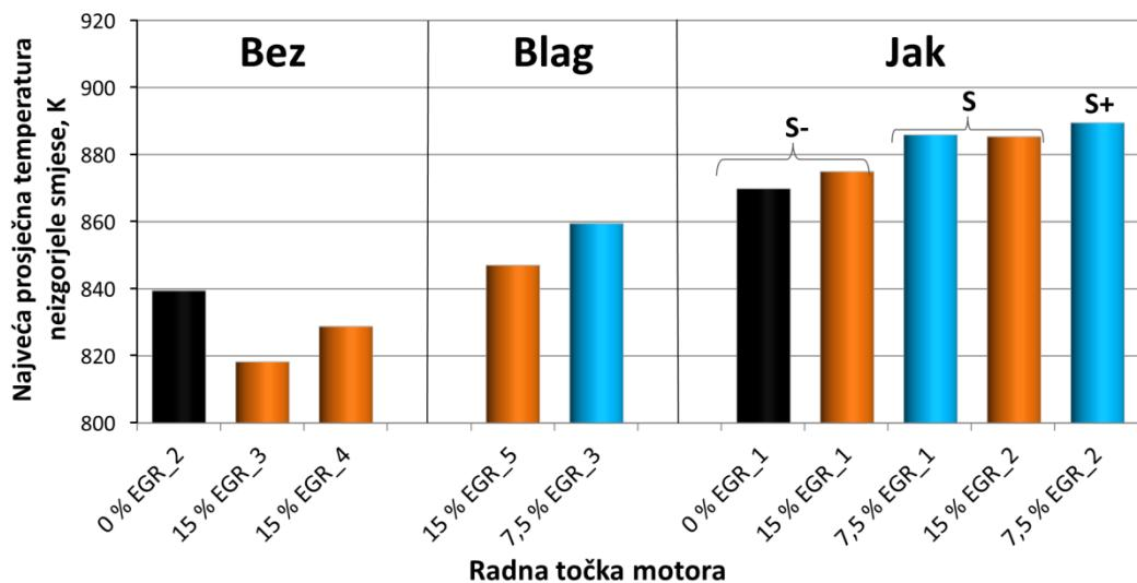
Slika 5.26. Odabране radne točke grupirane prema intenzitetu detonacije u skupine bez, s blagim ili s jakim intenzitetom detonantnoga izgaranja
