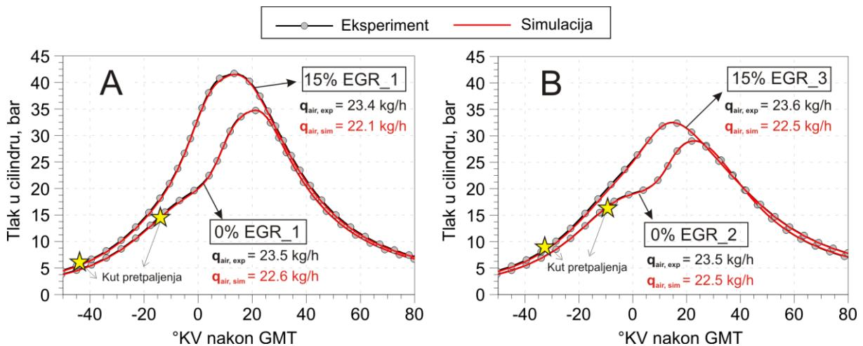
Slika 3.5. Usporedba izmjerenih (osrednjih za 300 radnih ciklusa) i simuliranih (srednjih pojedinačnih) profila tlaka u cilindru
