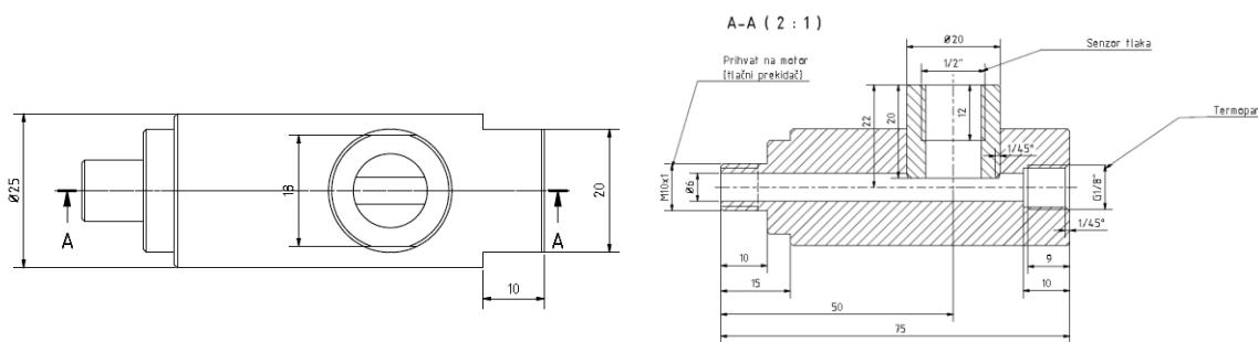
Slika 2.14. Prihvat senzora tlaka i temperature ulja
