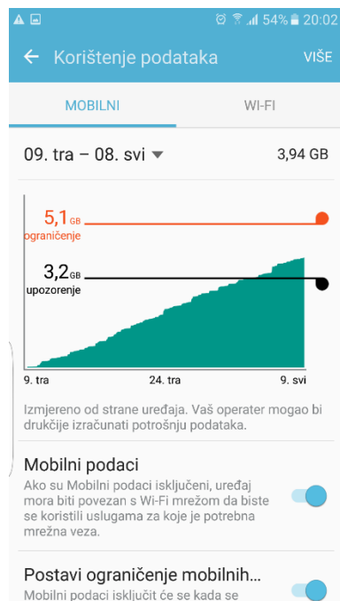
Slika 15: Grafičko sučelje integrirane aplikacije za mjerenje ostvarenoga podatkovnog prometa pametnog telefona OS-a Android, inačica 6.0.1., upotrebom pokretnih (slika 15-a) i Wi-Fi (slika 15-b) mreža
