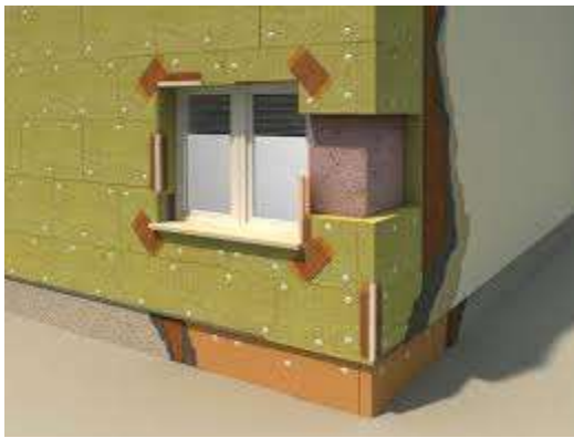
Slika 6-6. Ispravno postavljena izolacija oko vanjske stolarije ( www.knaufinsulation.hr )
